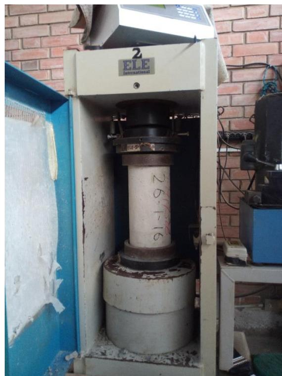
**Figura A.14** Ensayo de resistencia a compresión en una probeta de concreto.
