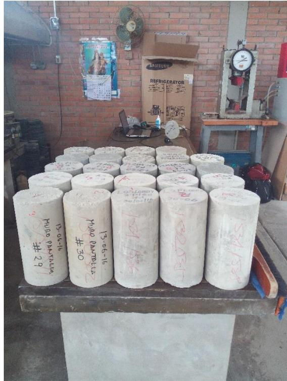
**Figura A.11** Probetas de concreto listas para someter a compresión
