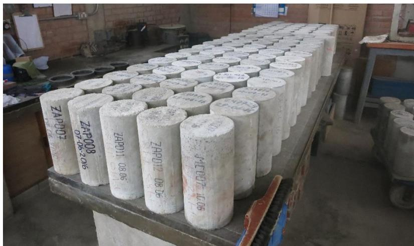
**Figura 3.2** Especímenes de concreto provenientes de diferentes obras de la ciudad de Lima
