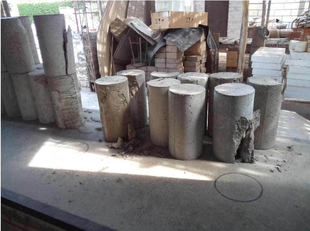
**Figura A.15** Probetas de concreto después de llevado a cabo los ensayos.
