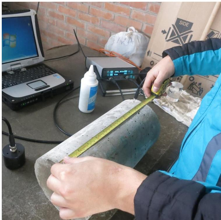
**Figura A.8** Medición de longitud de las probetas.
