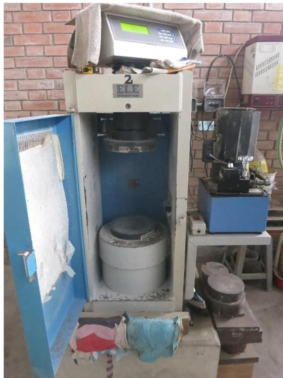
**Figura A.12** Máquina para realizar la prueba de resistencia a compresión.
