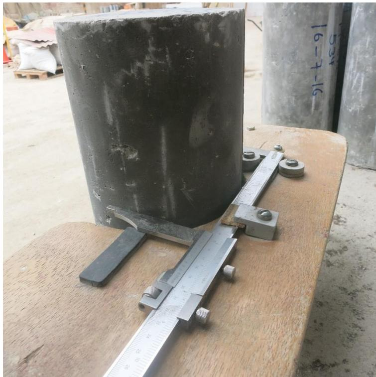
**Figura A.2** Medición del diámetro de las probetas de concreto.
