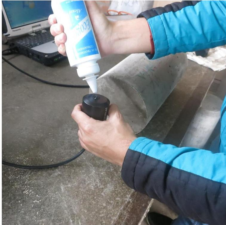
**Figura A.9** Aplicación de material acoplante a los transductores de ultrasonido.
