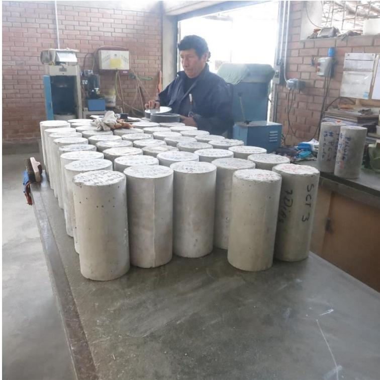
**Figura A.5** Acopio de probetas de concreto para realizar los ensayos de ultrasonido
