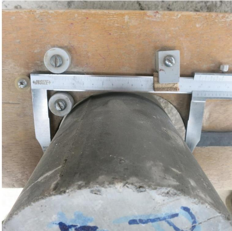
**Figura A.3** Vista en planta de la medición del diámetro de una muestra.
