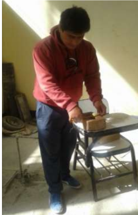
Foto. 3 Medición del largo, ancho y alto de las unidades de albañilería
