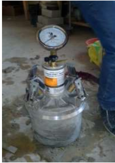
Foto. 17 Comprobación del contenido de aire en la mezcla en la olla de Washington
