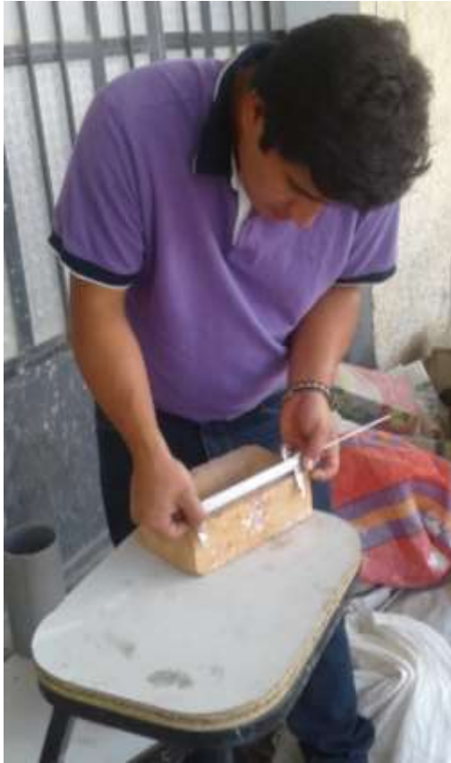
Foto. 4 Medición del alabeo
