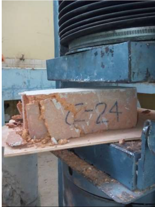
Foto. 5 Ensayo a compresión de unidades de albañilería.
