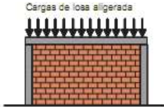
Fig. 1 Muro portante de albañilería
