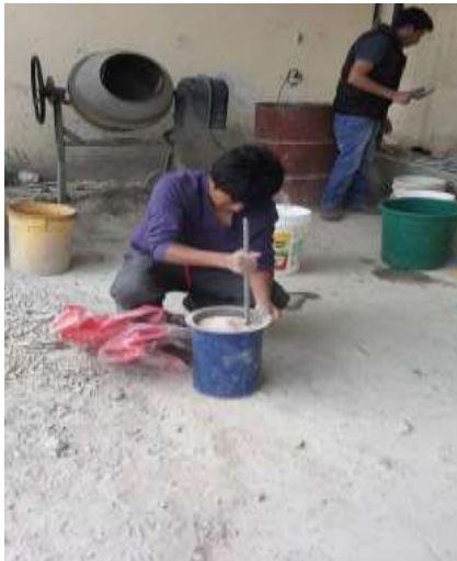
Foto. 15 Ensayo de peso unitario compactado seco del agregado fino
