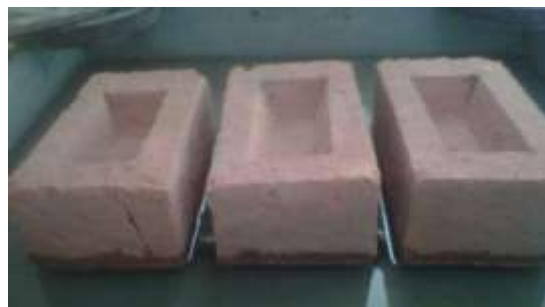
Fig. 14 Succión del ladrillo.
