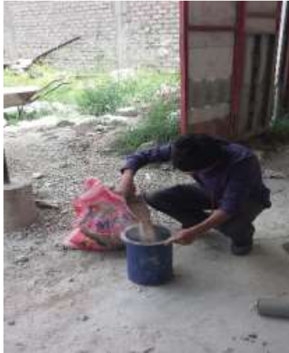
Foto. 14 Ensayo de peso unitario suelto seco del agregado fino
