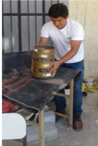
Foto. 13 Ensayo de granulometría
