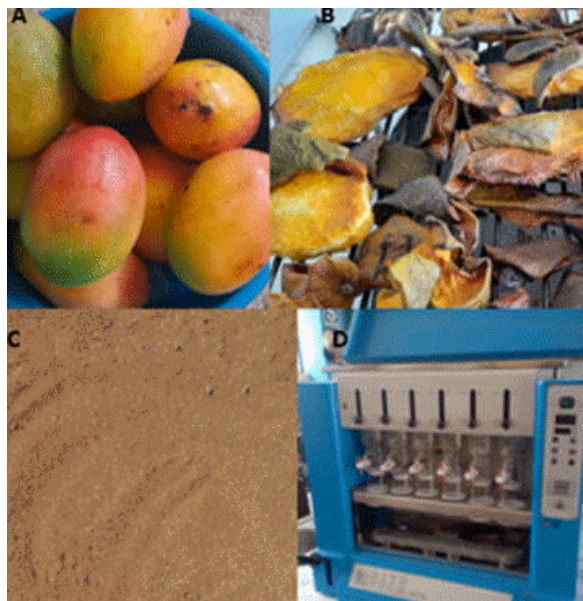
Foto 1. Proceso de obtención del extracto etanólico de cáscaras y semillas de mango: (A) Fruta fresca de mango antes del despulpado. (B) Cáscaras y semillas de mango desecadas a 40°C x 3 días. (C) Cáscaras y semillas de mango molidas y homogenizadas. (D) Equipo Soxhlet, donde el etanol arrastra el extracto de los residuos molidos de mango
