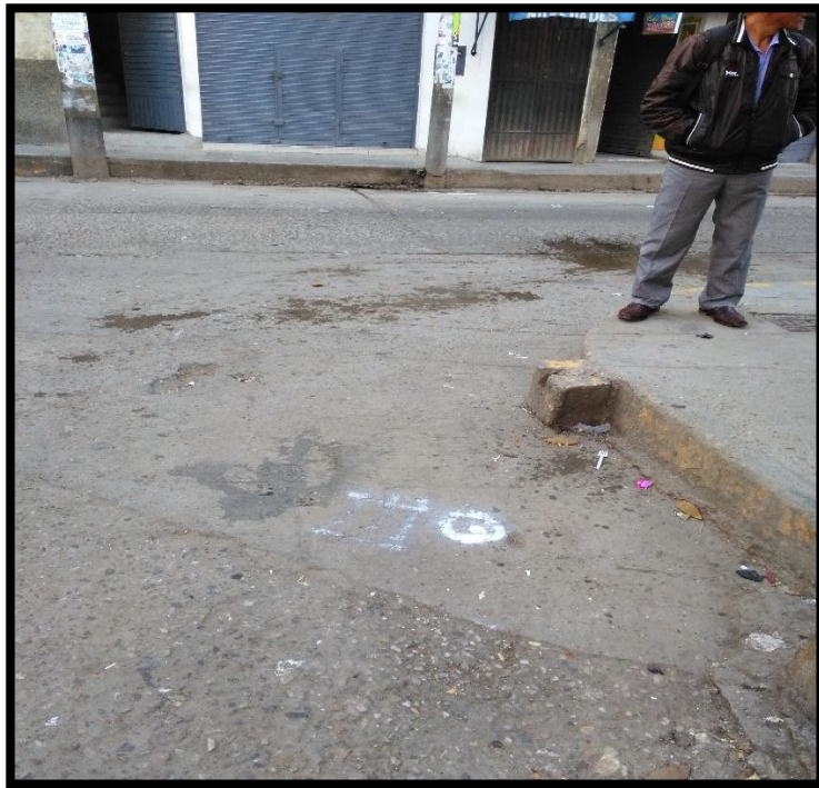
Fotografía N° 2: Se observa la marca con pintura donde se ubicó la estación donde se tomaron las coordenadas y se tomaron los Bms ubicado en el del Jirón Chanchamayo C-4- Km 0 +000
