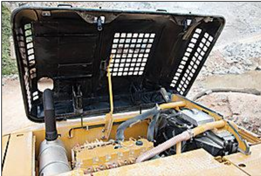
Fotografía N°02: Sistema motriz de una excavadora Caterpillar 336D L.
