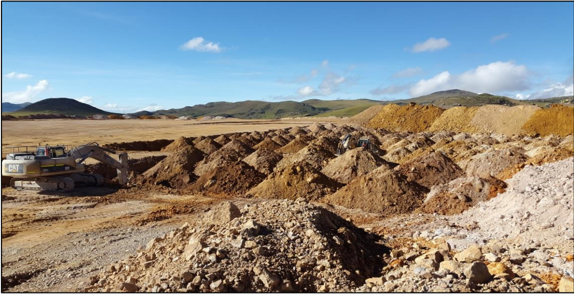
Fotografía N°01: Excavadoras hidráulicas en batido de mineral.
