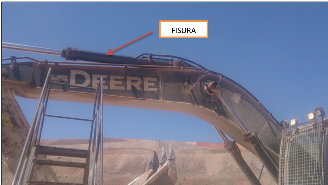
Fotografía N°10: Fisura de botella hidráulica que acciona el cucharón.
