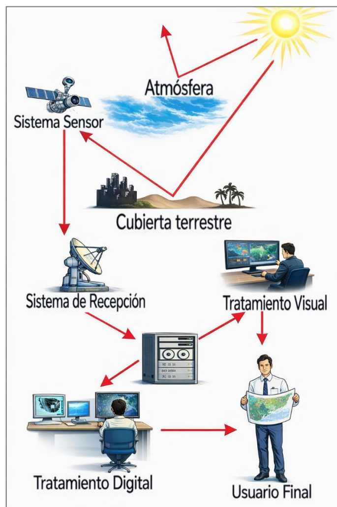
Figura 1. Los componentes del sistema de Teledetección. Fuente: Chuvieco, (1996).
