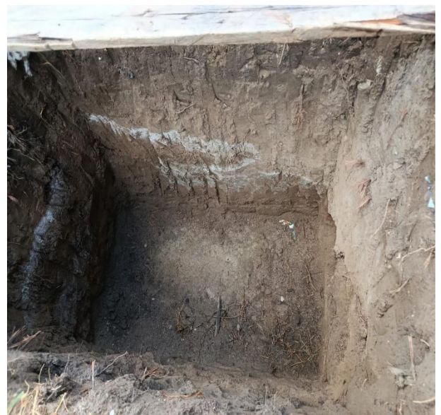
Calicata típica utilizada
