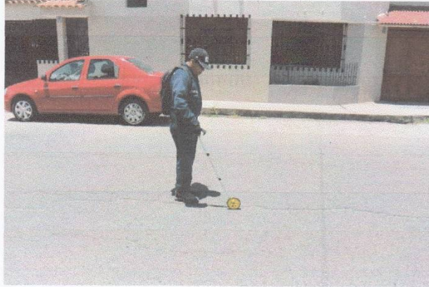
Imagen 5.6 Medición de longitud de fisura longitudinal con odómetro
