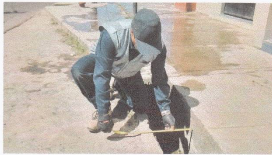
Imagen 5.7. Medición de ancho de cuneta con wincha metálica
