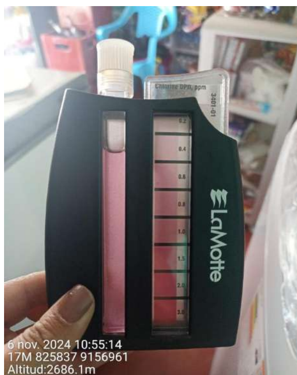
Figura N°40: Punto número 11- muestreo de cloro residual libre (0.58 mg/l)
