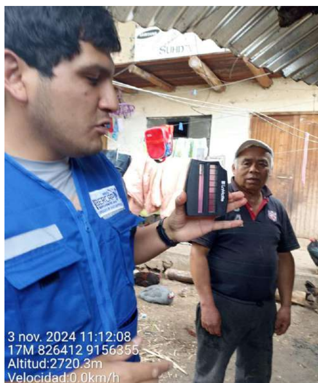
Figura N°34: Punto número 5- muestreo de cloro residual libre (0.61 mg/l)
