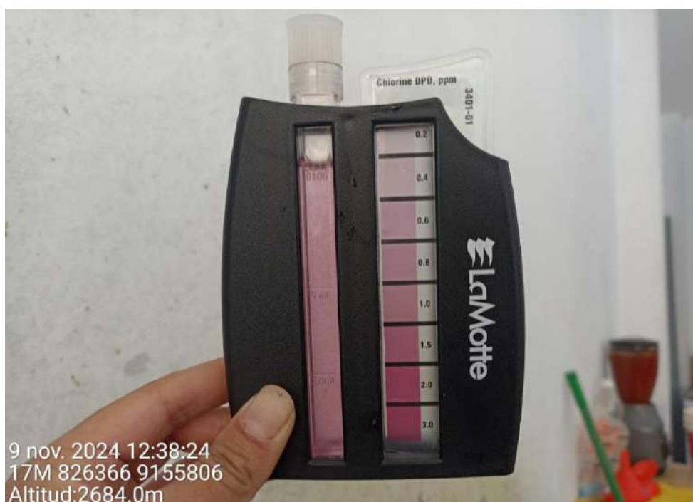
Figura N°58: Punto número 29- muestreo de cloro residual libre (0.56 mg/l)
