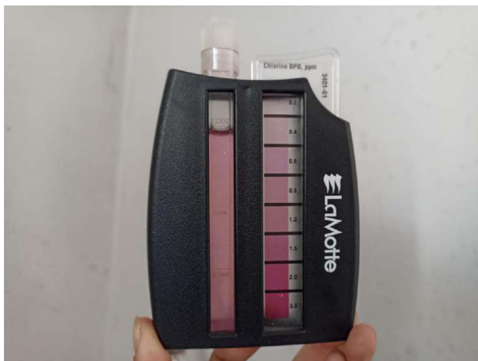
Figura N°61: Punto número 32- muestreo de cloro residual libre (0.56 mg/l)
