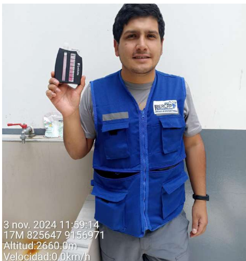
Figura N°42: Punto número 13- muestreo de cloro residual libre (0.55 mg/l)
