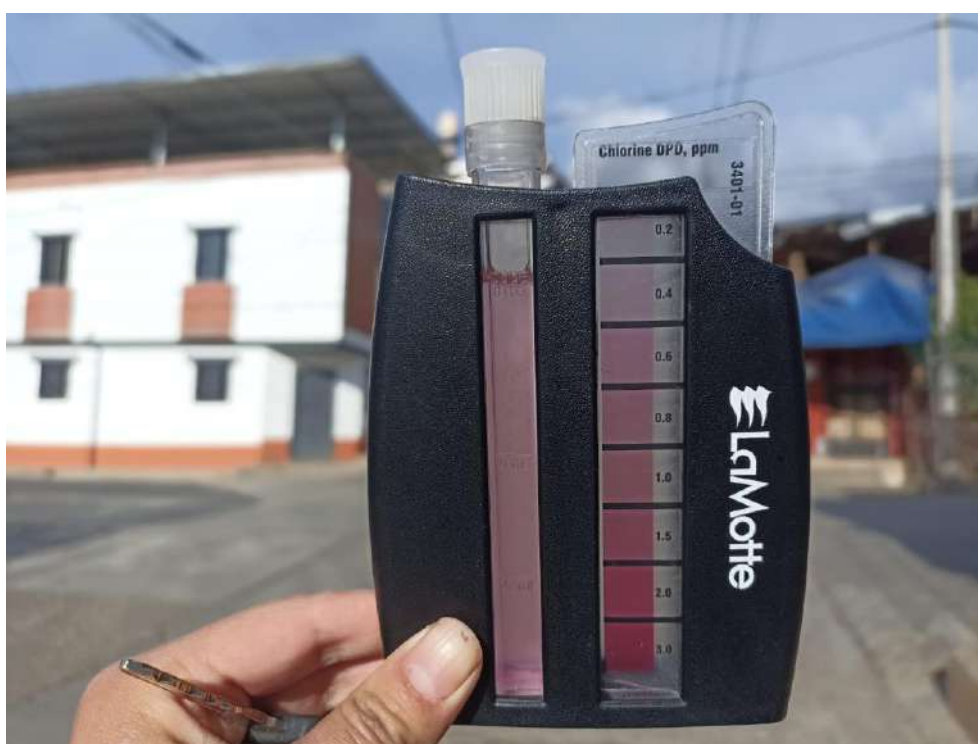
Figura N°53: Punto número 24- muestreo de cloro residual libre (0.54 mg/l)
