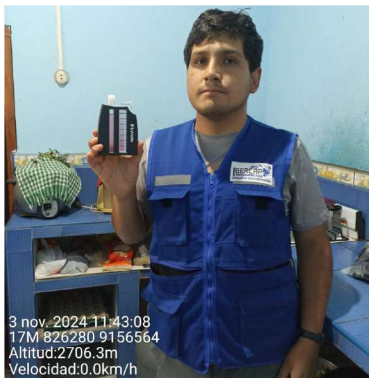
Figura N°37: Punto número 8- muestreo de cloro residual libre (0.56 mg/l)
