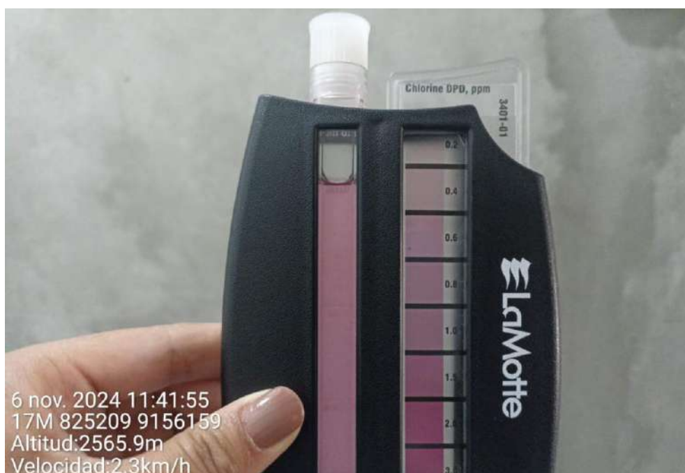
Figura N°49: Punto número 20- muestreo de cloro residual libre (0.59 mg/l)
