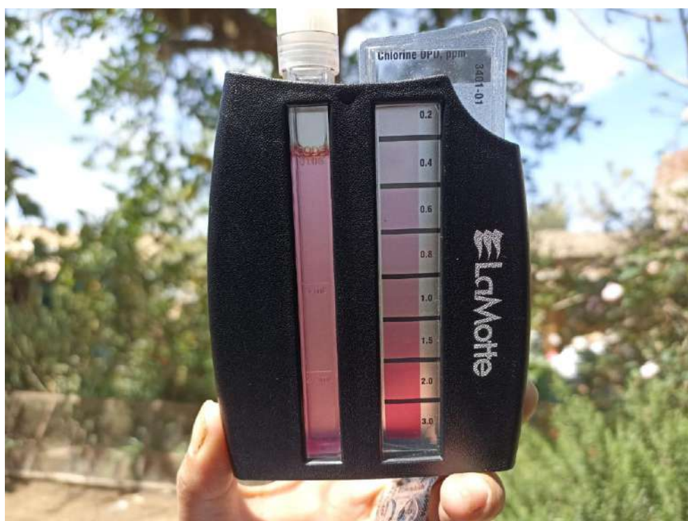
Figura N°60: Punto número 31- muestreo de cloro residual libre (0.56 mg/l)
