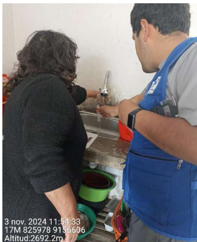
Figura N°41: Punto número 12- muestreo de cloro residual libre (0.58 mg/l)
