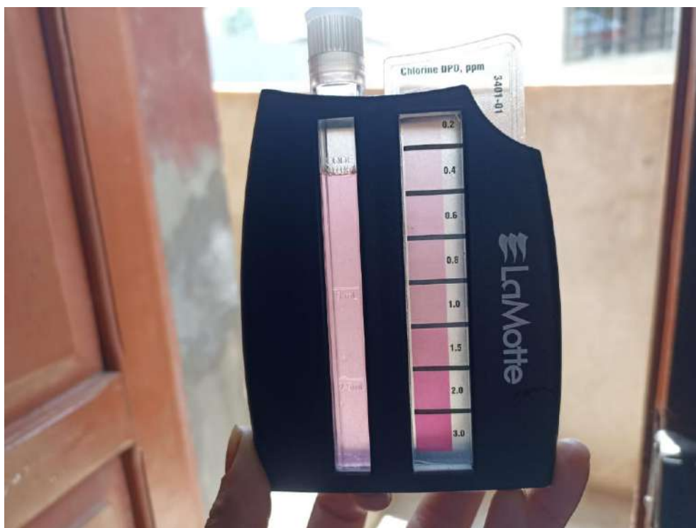
Figura N°57: Punto número 28- muestreo de cloro residual libre (0.56 mg/l)
