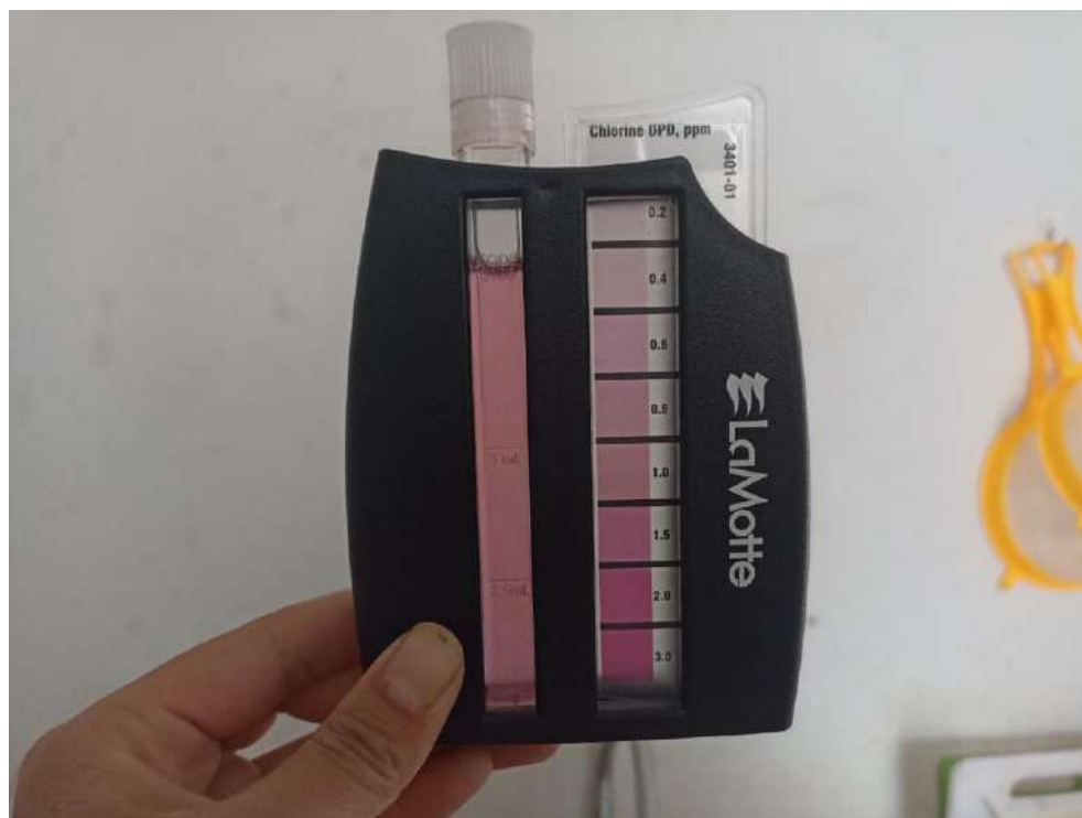
Figura N°55: Punto número 26- muestreo de cloro residual libre (0.64 mg/l)
