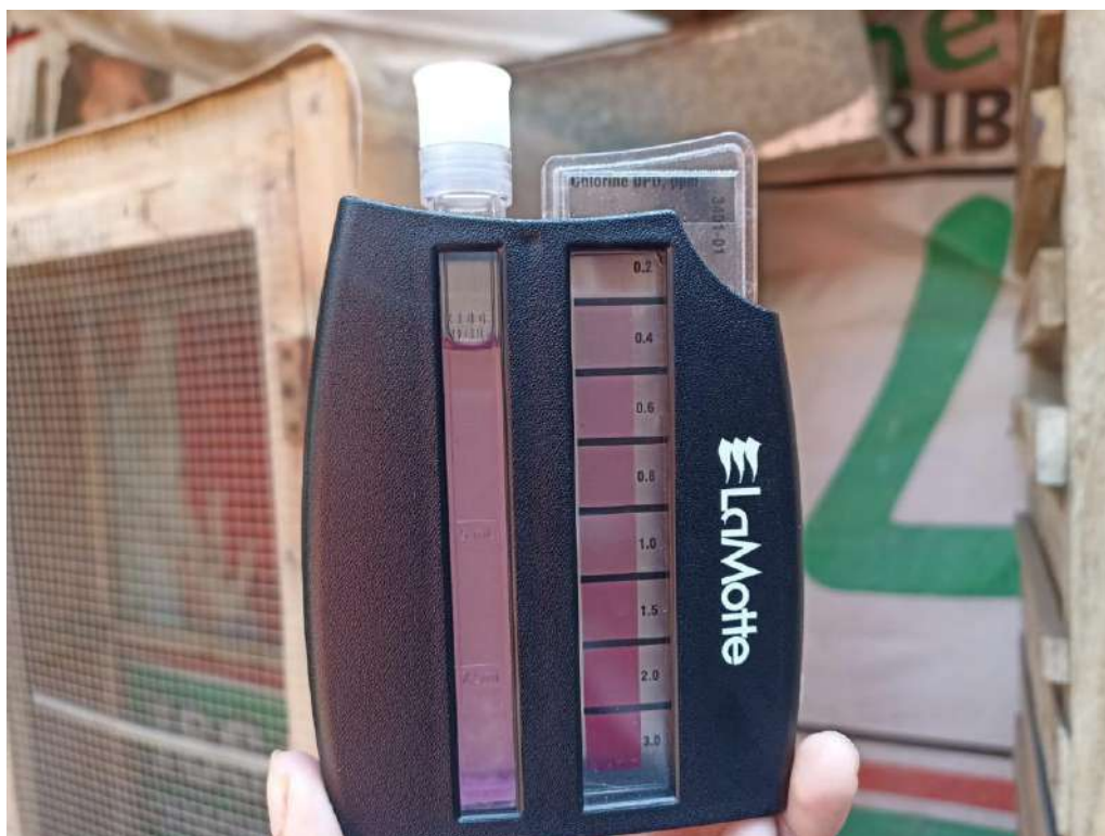
Figura N°44: Punto número 15- muestreo de cloro residual libre (0.55 mg/l)
