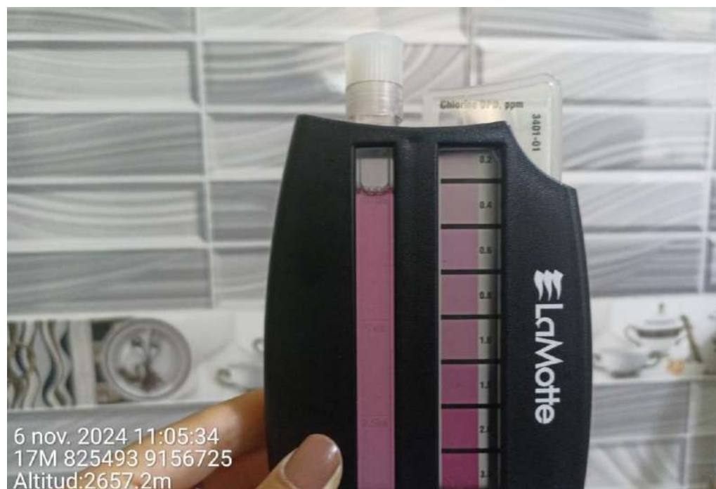
Figura N°45: Punto número 16- muestreo de cloro residual libre (0.57 mg/l)
