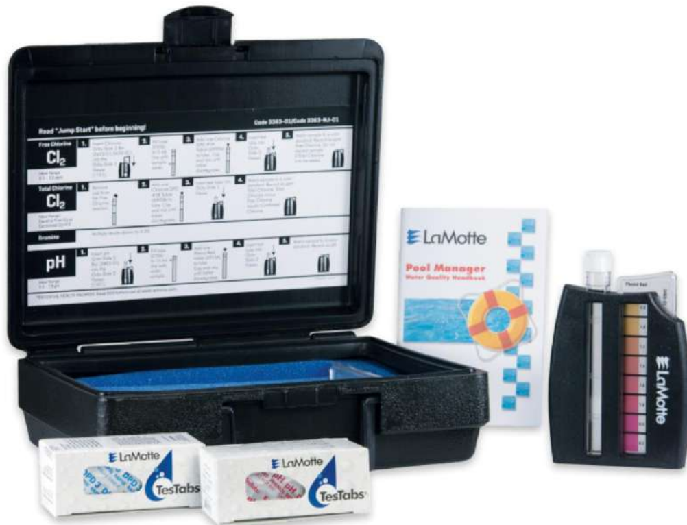
Figura N°16: Equipo de muestreo del cloro residual libre
