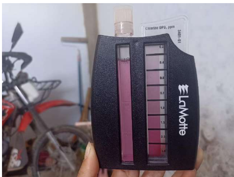
Figura N°43: Punto número 14- muestreo de cloro residual libre (0.51 mg/l)
