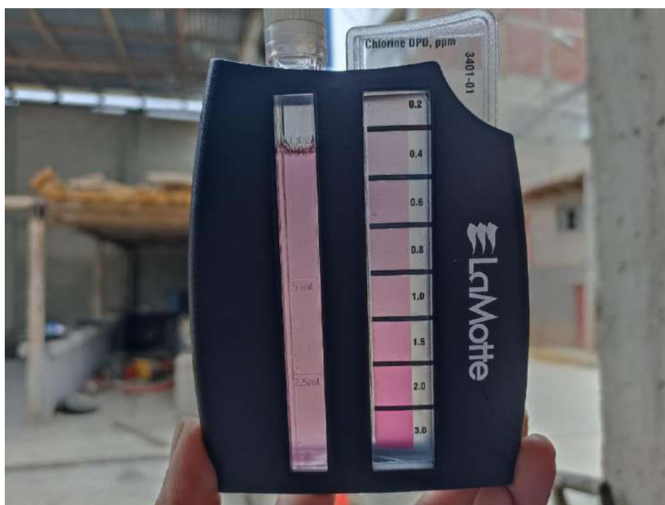
Figura N°48: Punto número 19- muestreo de cloro residual libre (0.56 mg/l)
