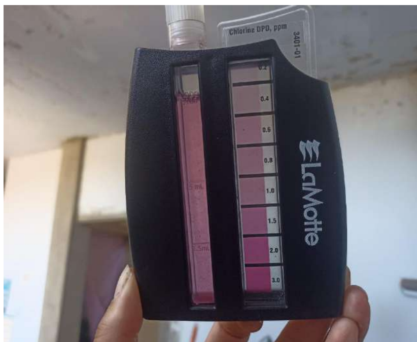
Figura N°31: Punto número 2- muestreo de cloro residual libre (0.65 mg/l)
