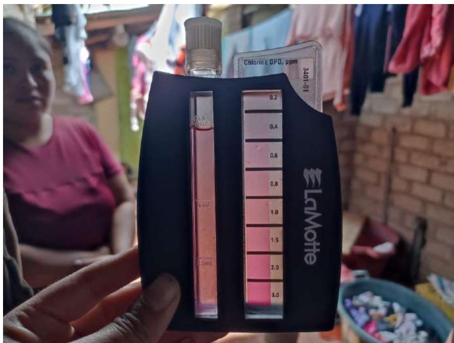
Figura N°39: Punto número 10- muestreo de cloro residual libre (0.61 mg/l)
