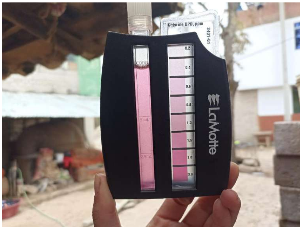
Figura N°56: Punto número 27- muestreo de cloro residual libre (0.58 mg/l)
