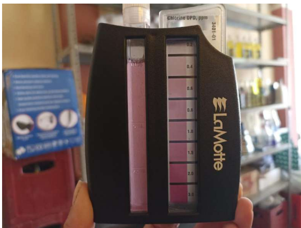
Figura N°54: Punto número 25- muestreo de cloro residual libre (0.55 mg/l)
