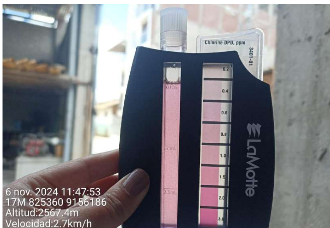
Figura N°50: Punto número 21- muestreo de cloro residual libre (0.58 mg/l)
