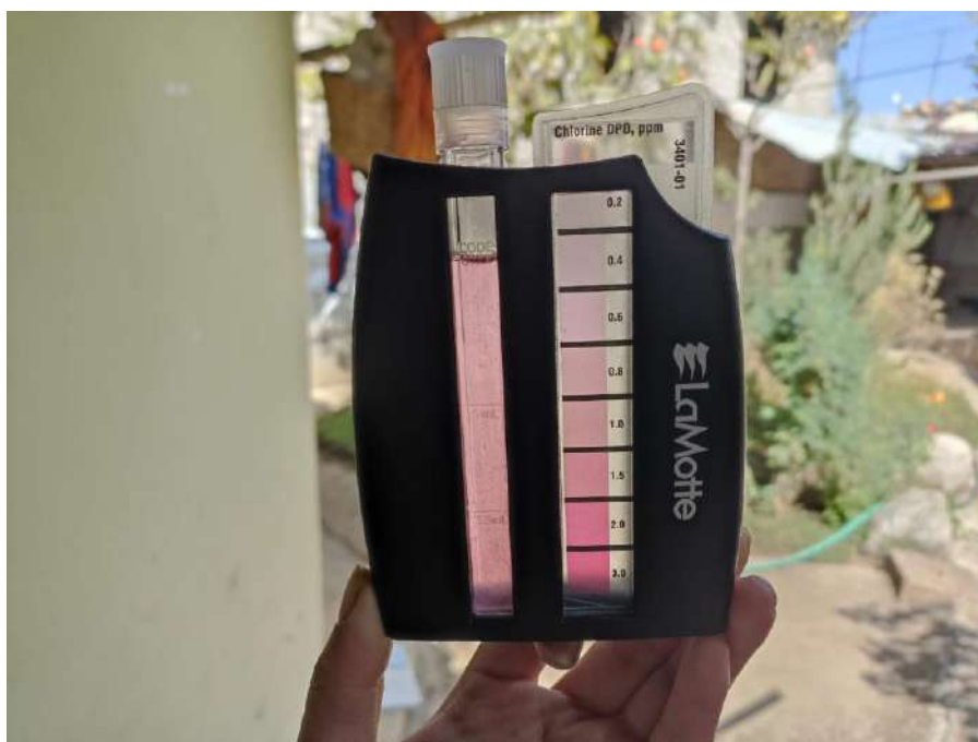
Figura N°38: Punto número 9- muestreo de cloro residual libre (0.56 mg/l)
