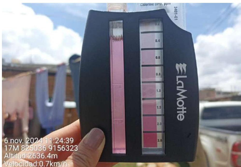
Figura N°47: Punto número 18- muestreo de cloro residual libre (0.58 mg/l)
