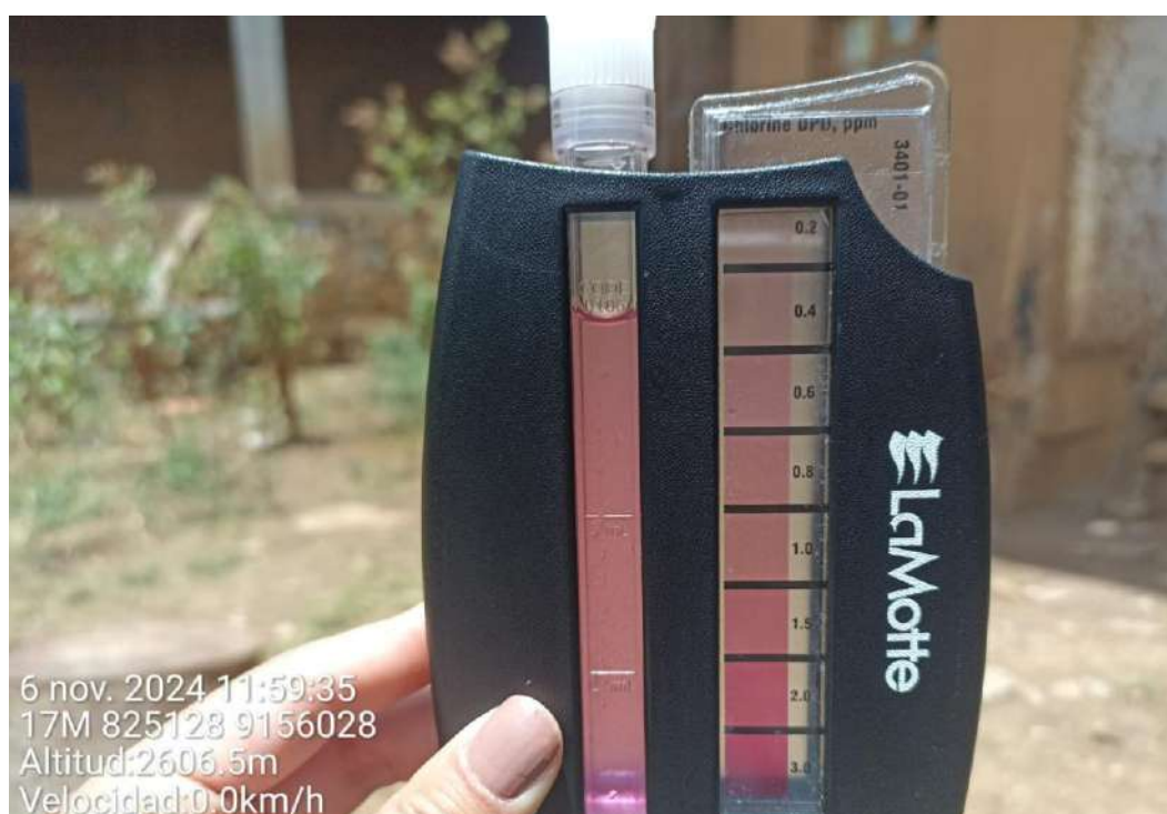
Figura N°51: Punto número 22- muestreo de cloro residual libre (0.54 mg/l)
