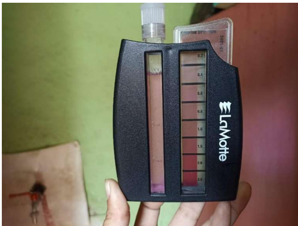
Figura N°46: Punto número 17- muestreo de cloro residual libre (0.59 mg/l)
