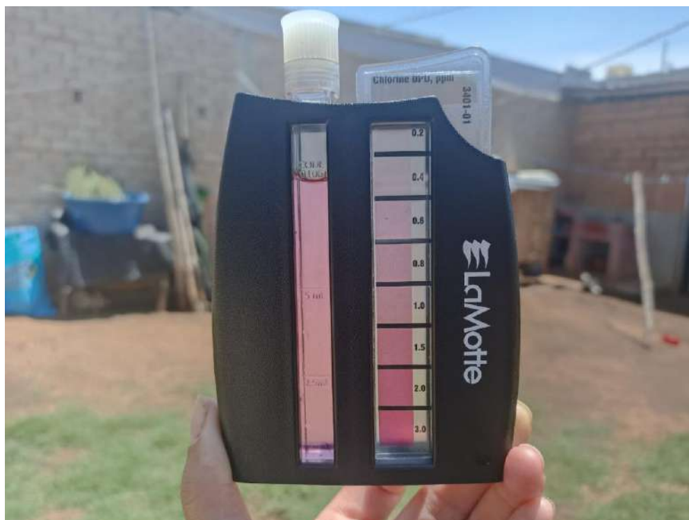
Figura N°62: Punto número 33- muestreo de cloro residual libre (0.55 mg/l)
