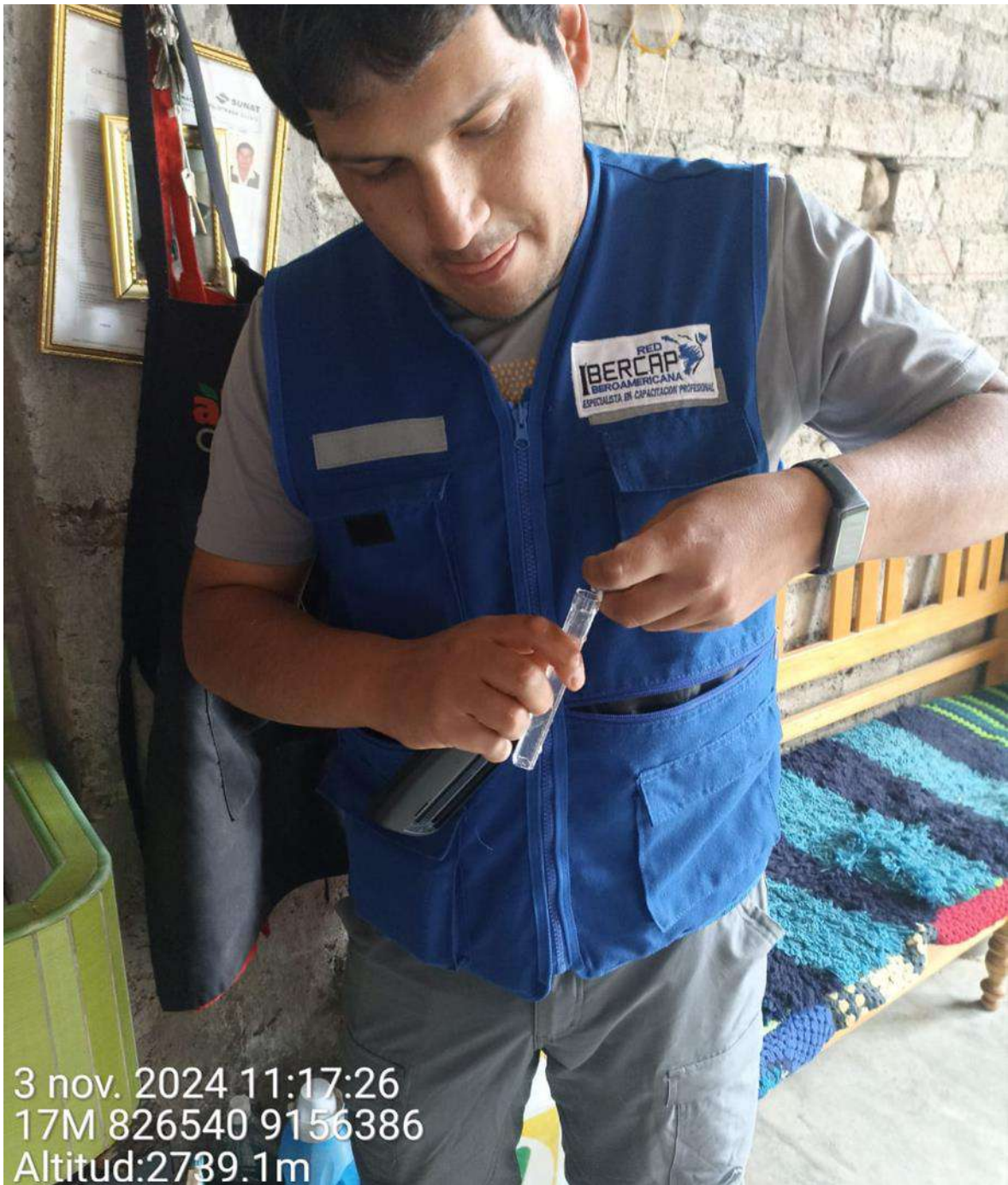
Figura N°20: Agregar el reactivo DPD 1R en la muestra
