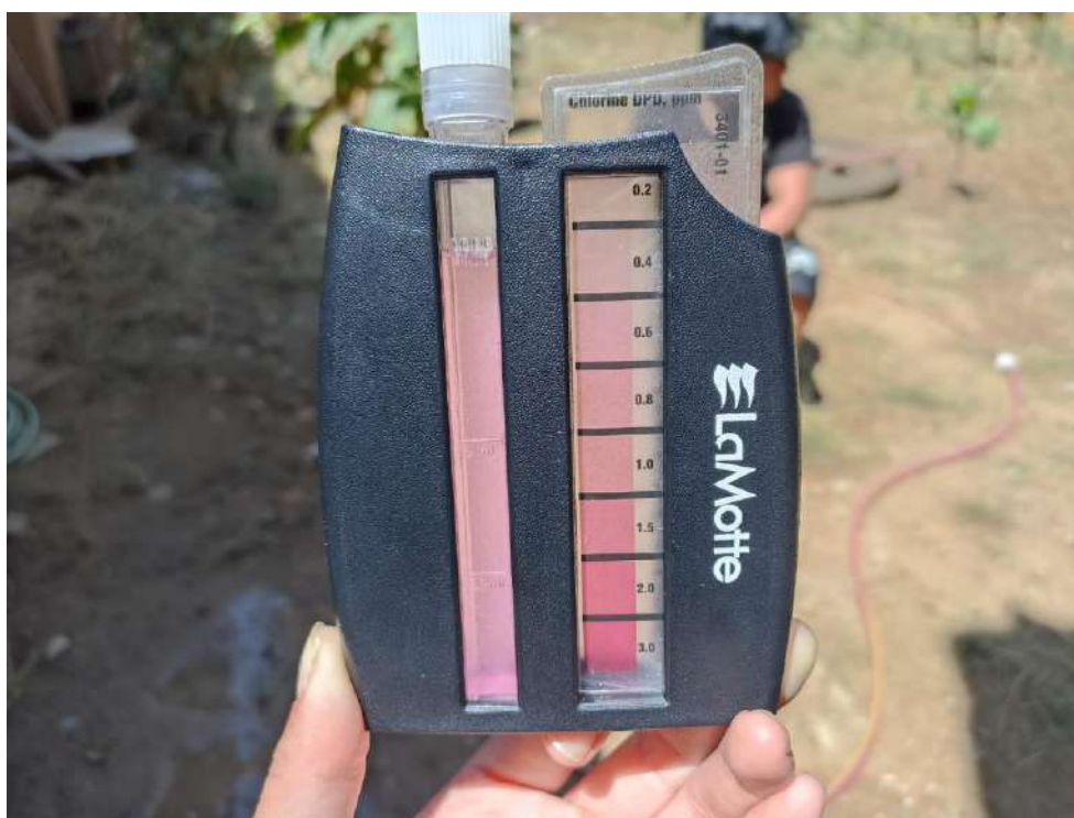
Figura N°59: Punto número 30- muestreo de cloro residual libre (0.57 mg/l)
