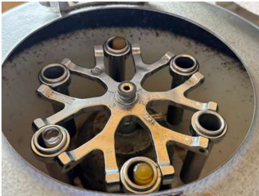
Fotografía 3. Centrifugación de la muestra: Tubos de ensayo con la muestra procesada y la solución de Sheather cargados en la centrífuga.
