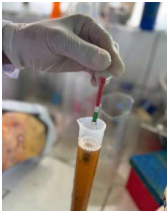
Fotografía 1. Verificación de la solución de flotación: Medición de la gravedad específica de la solución de flotación (solución de Sheather) utilizando un densímetro para asegurar la densidad correcta.
