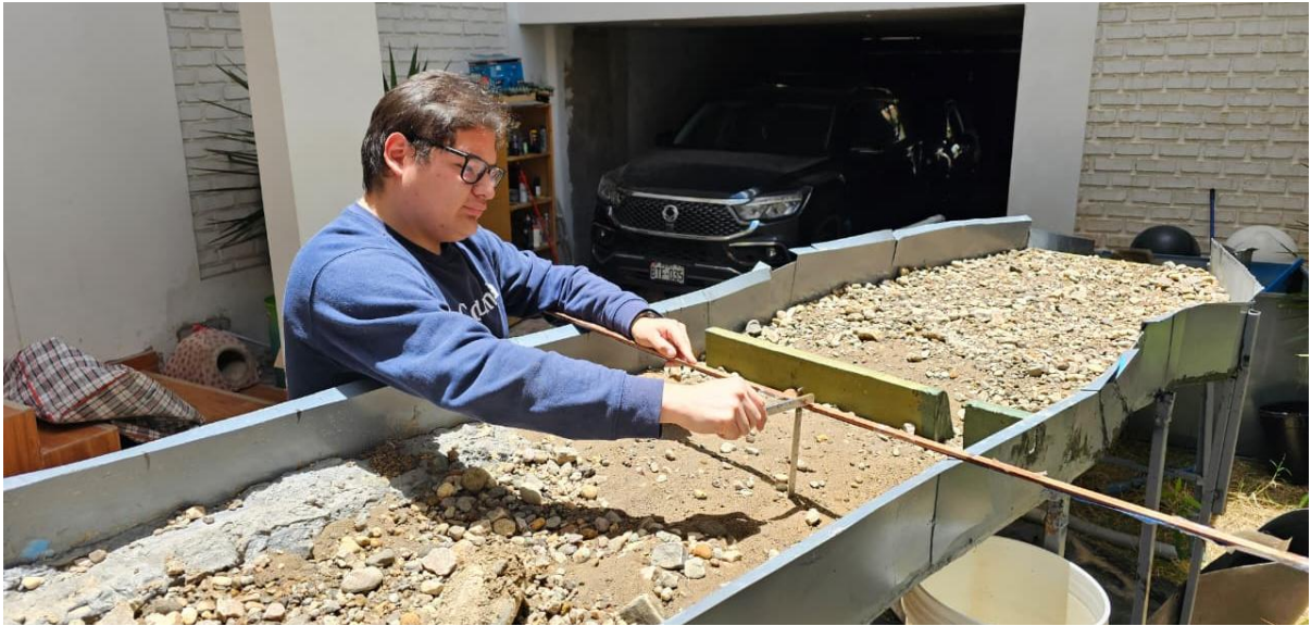
Figura 84: Medición de la profundidad de sedimentos después de la descolmatación
