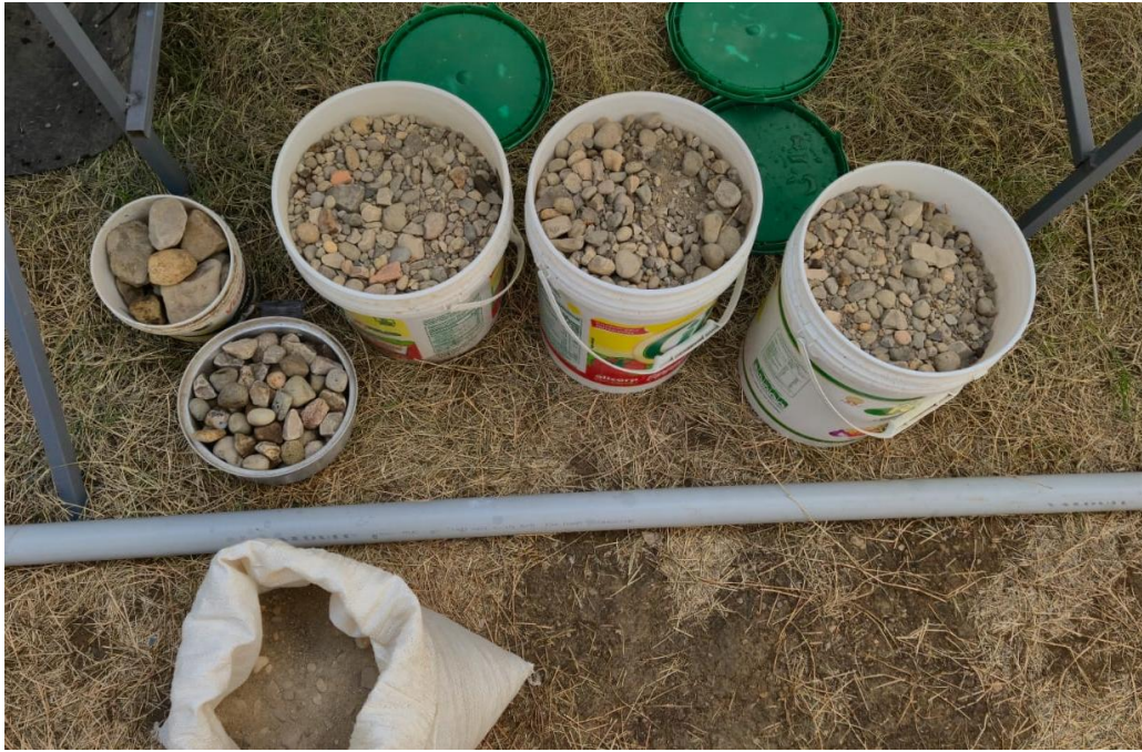
Figura 73: Preparación y separación de fracciones de sedimentos para su uso en el modelo físico.
