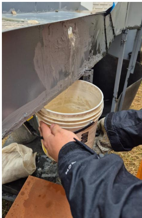
Figura 76: Aforo del bocal en condición de colmatación.
