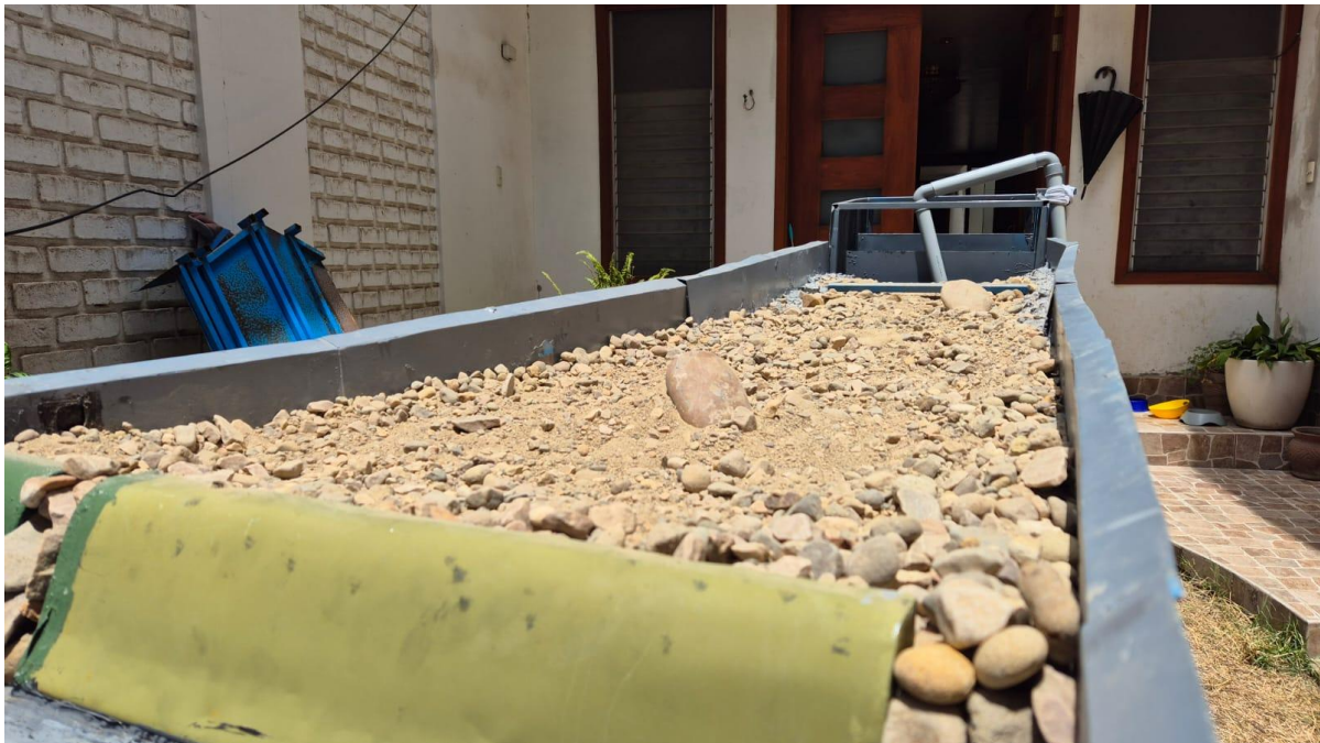
Figura 74: Caracterización de la colmatación aguas arriba del barrage.
