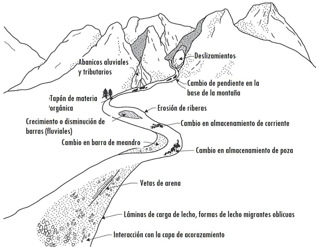
Figura 3: Proceso de sedimentación y cambios morfológicos asociados en una cuenca hidrográfica.
