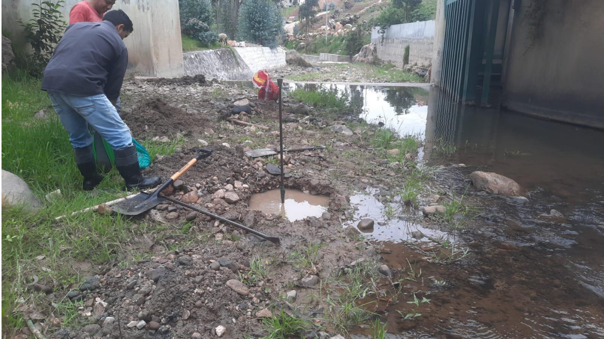
Figura 53: Excavación de calicatas para la extracción de sedimentos superficiales cerca al barrage.
