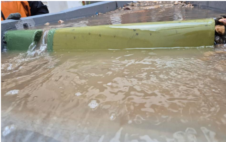
Figura 37: Vista frontal del barrage fijo-fusible a escala 1/15.
