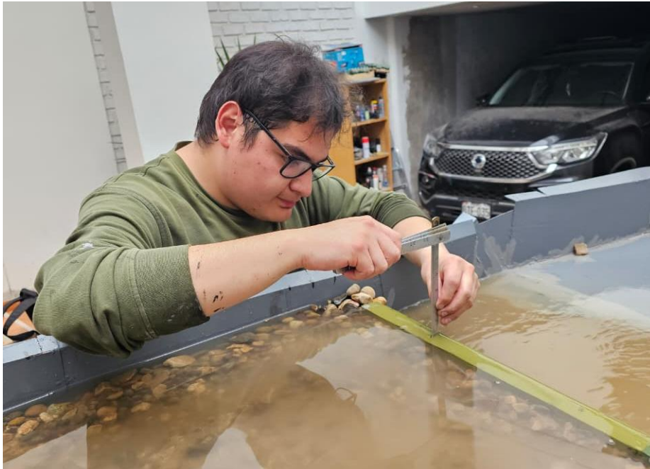
Figura 75: Medición de tirantes sobre la corona del barrage para calibrar el modelo.
