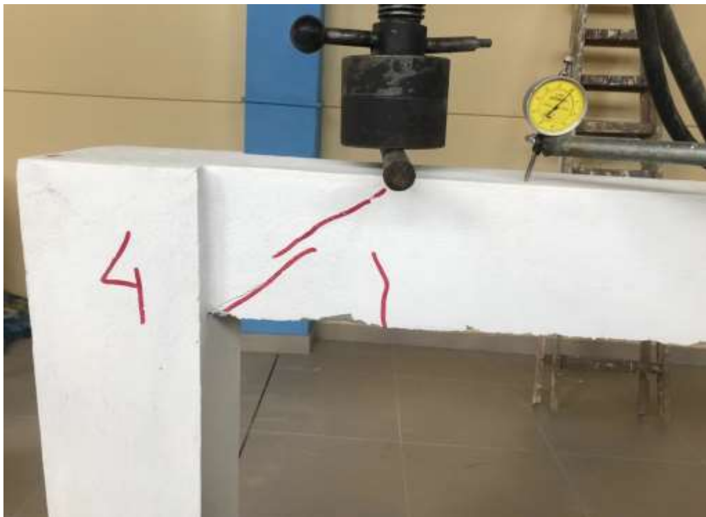
Fotografía 16. Falla producida por esfuerzo cortante en la viga de concreto armado con el primer estribo espaciado a 10 cm medido a partir de la cara de la columna.
