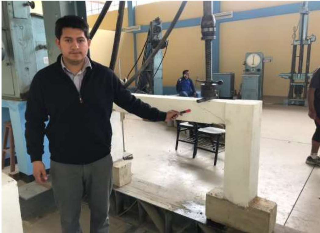
Fotografía 18. Asesor, Tesista y Encargado de Laboratorio realizando las pruebas de esfuerzo cortante en los pórticos de concreto armado.
