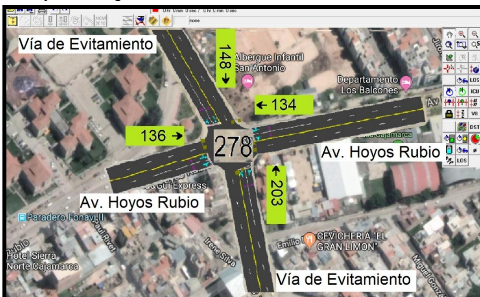
Figura 35 Software Synchro 8, geometría, aforos de una intersección
