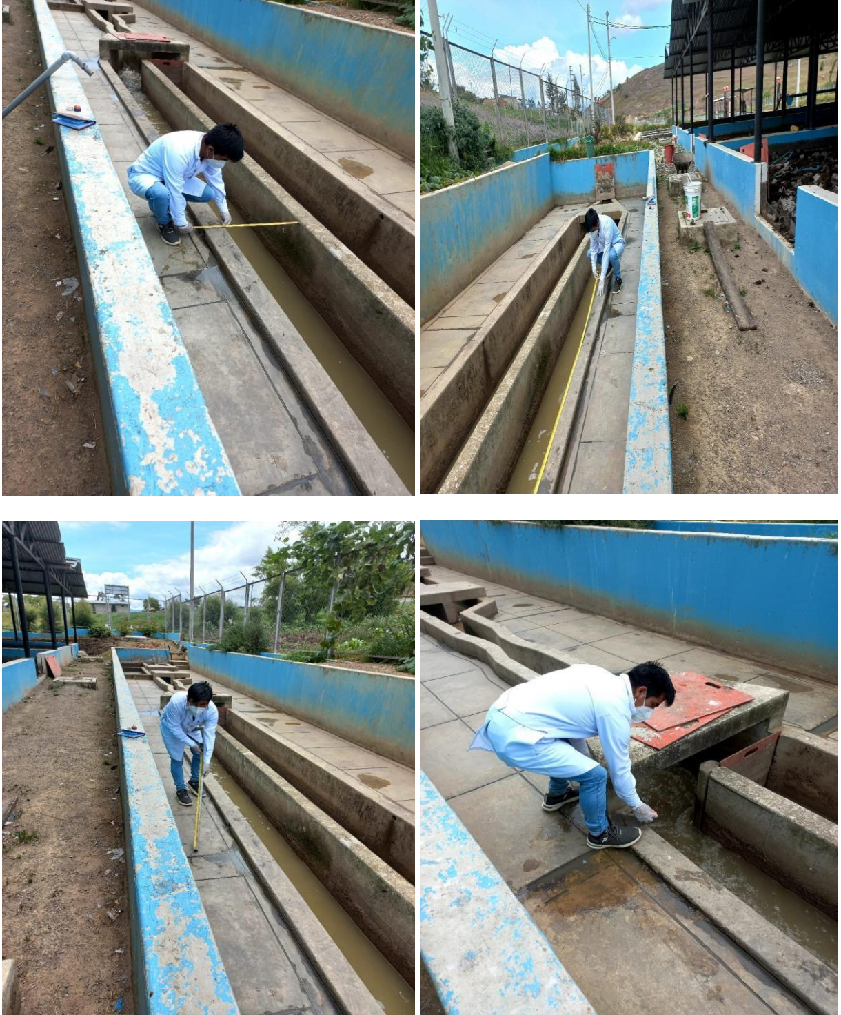
Foto 1. Medición del caudal método del flotador.
