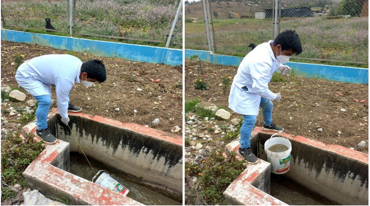
Foto 4. Medición del afluente del punto de monitoreo M1.
