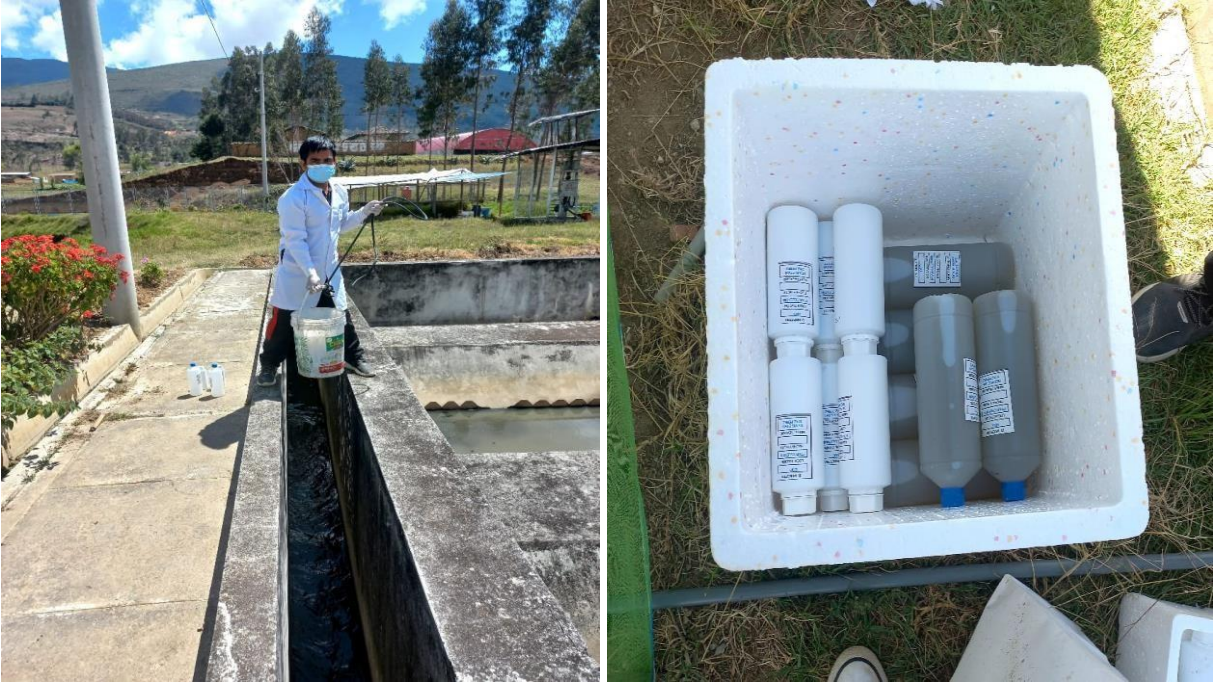
Foto 2. Recojo de las muestras en los puntos de monitoreo para la medición de materia orgánica.
