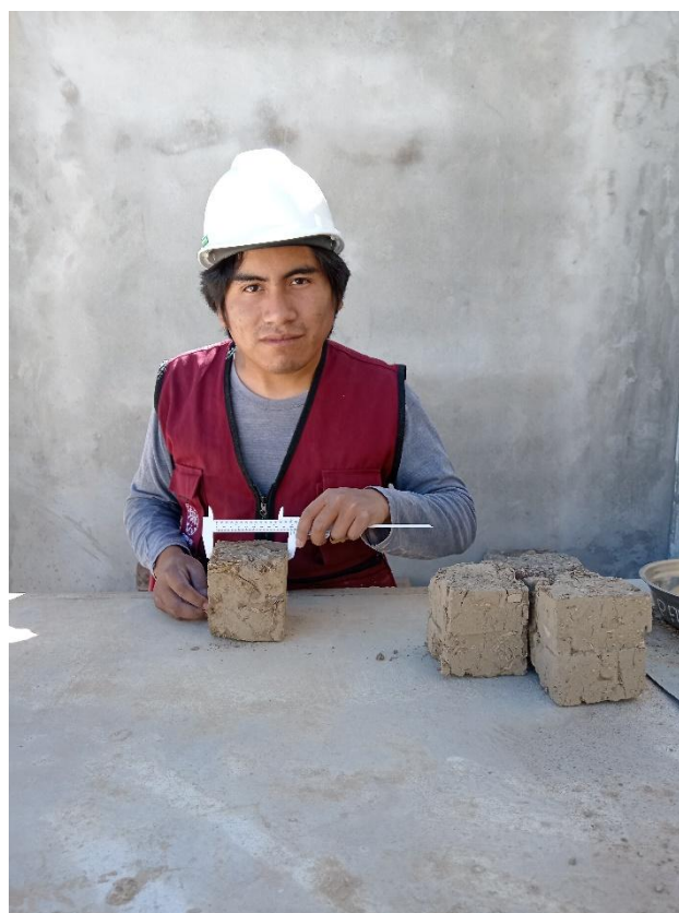
Figura N°24. Toma de datos de los cubos de adobe
