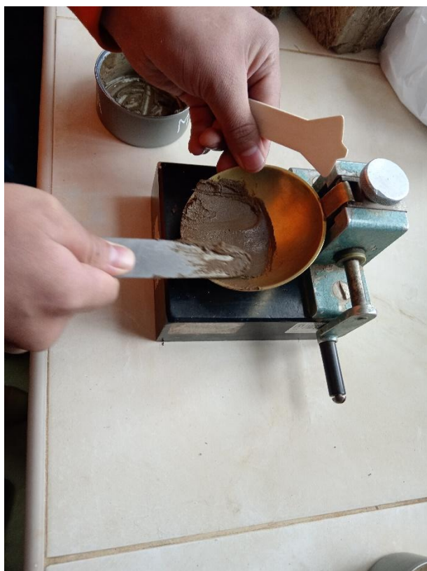
Figura N°30. Muestra ensayada – copa de Casagrande
