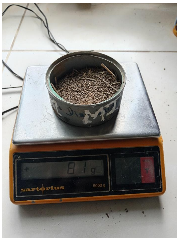
Figura N°28. Peso del material retenido en el tamiz N°20
