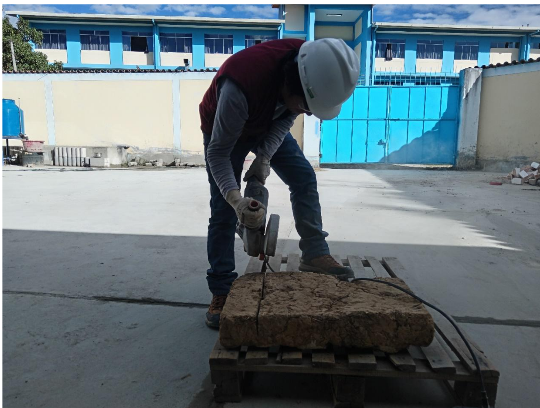
Figura N°24. Toma de datos de los cubos de adobe
