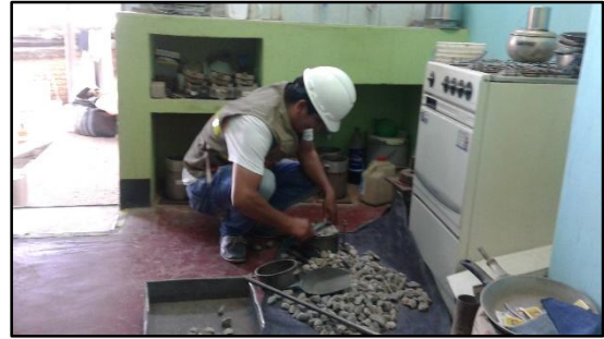
Figura 11. Enrasado de la muestra de agregado grueso.
