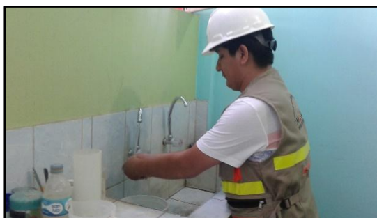
Figura 7. Lavado del agregado fino
