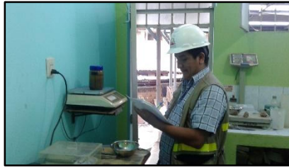
Figura 17. Peso del picnómetro + peso de la muestra + agua
