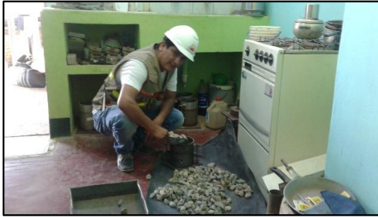
Figura 10. Vaciado del agregado grueso en el molde.
