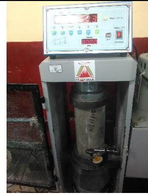
Figura 47. Ensayo a compresión.
