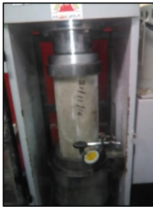
Figura 22. Ensayo de compresión simple
