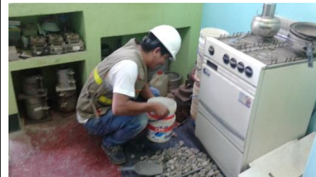
Figura 39. Agregado sumergido en agua
