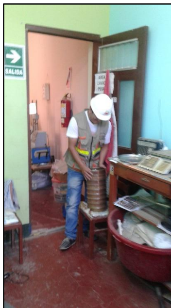
Figura 6. Tamizado del agregado
