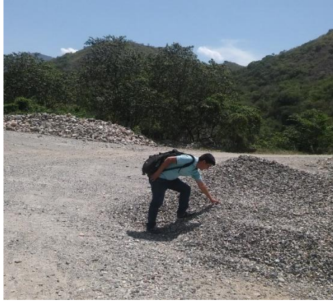
Figura 23. Se muestra el producto terminado piedra chancada, salientes de proceso de trituración.
