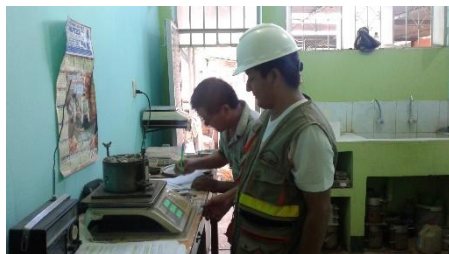
Figura 32. Peso de muestra suelta
