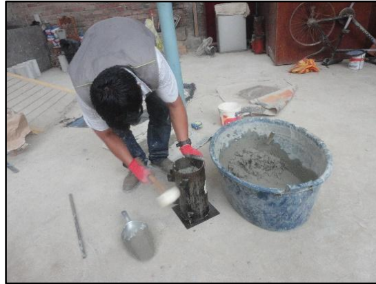
Figura 20. Eliminación de aire en el espécimen
