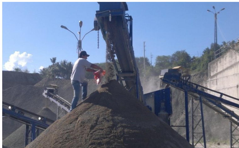
Figura 25. Se muestra el producto terminado arena procesada, de donde se
