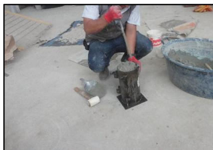
Figura 19. Compactado de los especímenes de concreto
