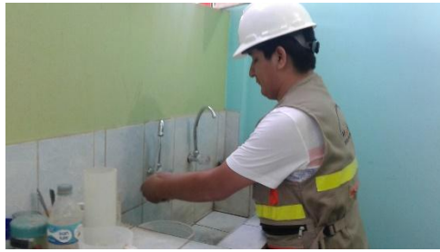
Figura 34. Lavado del agregado fino.
