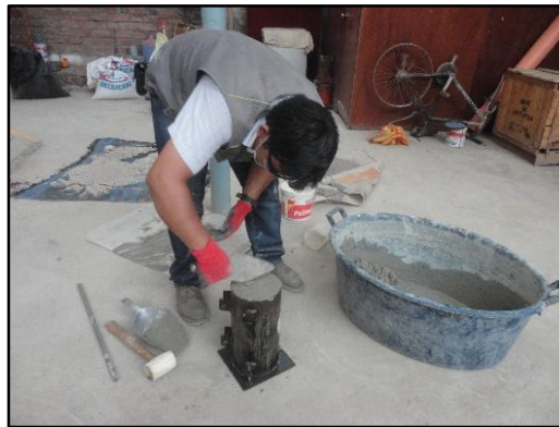
Figura 21. Retiro del exceso de mezcla
