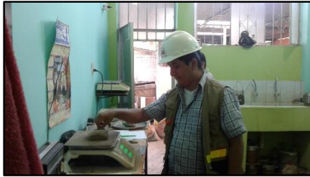
Figura 8. .Peso húmedo del A. fino
