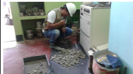
Figura 33. Compactado de muestra, PCH 3/4"
