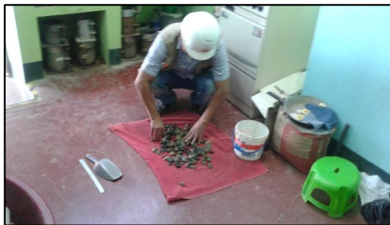
Figura 12. Agregado grueso saturado con superficie seca.
