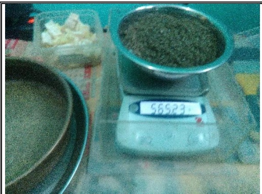
Figura 37. Peso húmedo del agregado fino.
