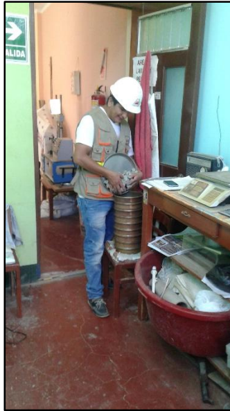
Figura 5. Tamizado del agregado grueso.
