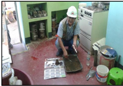
Figura 15. Compactado del agregado fino (prueba de absorción).
