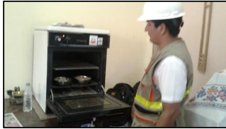
Figura 9. .secado al horno del A. fino
