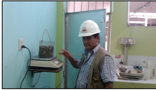
Figura 13. Peso del agregado grueso saturado con superficie seca
