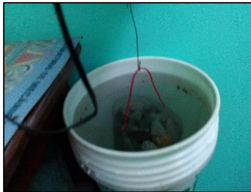
Figura 14. Peso del agregado grueso sumergido en agua.
