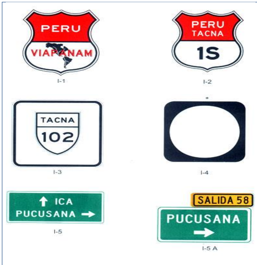
Figura N° 11: Señales Verticales Informativas
