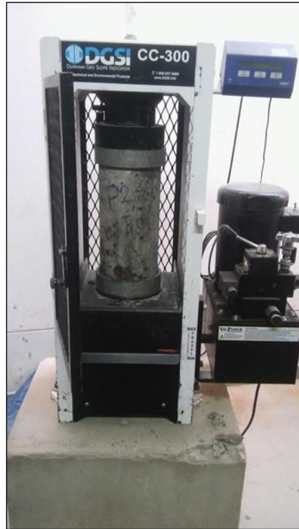
Foto 16: Probeta típica – probeta N°24 12% TiO 2 ensayada y con el modo de falla en las esquinas inferiores.
