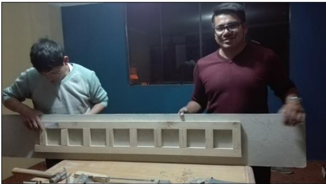
Foto 18: Molde estándar terminado de madera y superboard para 8 probetas.
