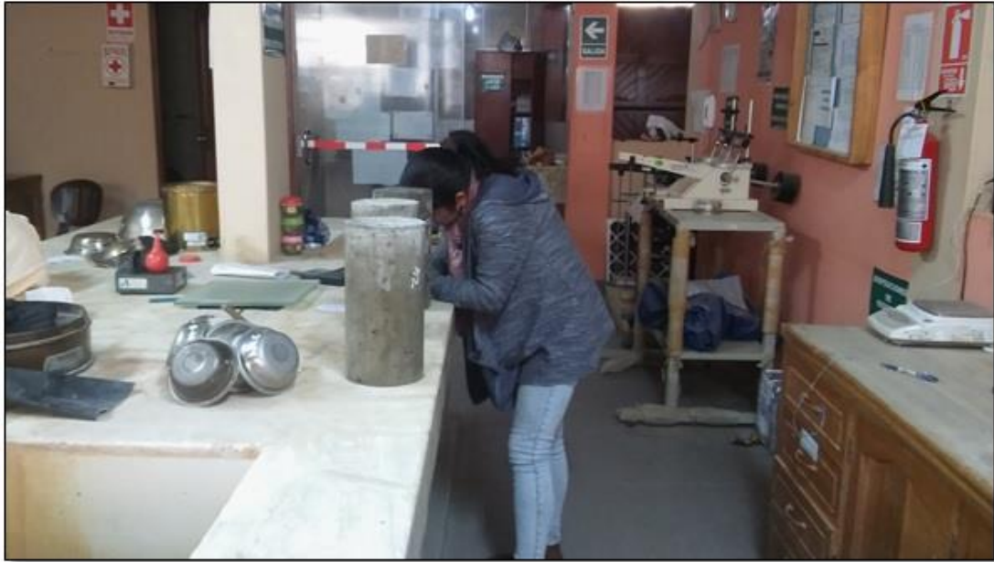
Foto 09: Jefe de laboratorio mapeando los testigos de concreto.
