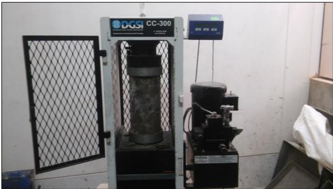
Foto 14: Probeta típica – probeta N°09 3% TiO 2 ensayada y con el modo de falla en las esquinas superiores e inferiores.
