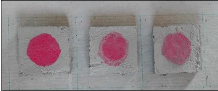
Foto 23: Resultado típico del tratamiento base luego del ensayo de decoloración con rodamina. La probeta de la izquierda medida en el tiempo 0 horas, la del centro medida en el tiempo 4 horas y la de la derecha medida en el tiempo 26 horas.
