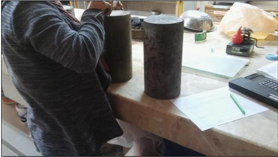
Foto 11: Medición de los diámetros de las probetas (3 medidas por cada probeta).
