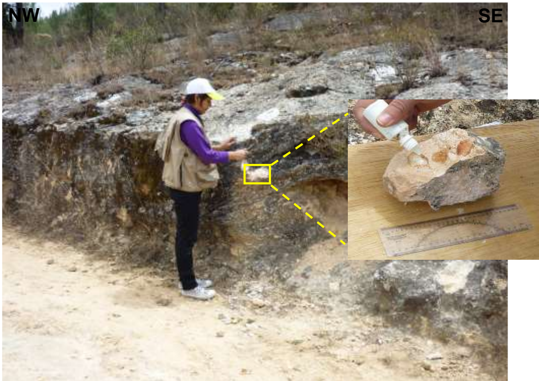
Figura N° 72: Calizas arenosas muestran efervescencia con ácido clorhídrico en la Formación Inca. (Norte: 9203819, Este: 781617)
