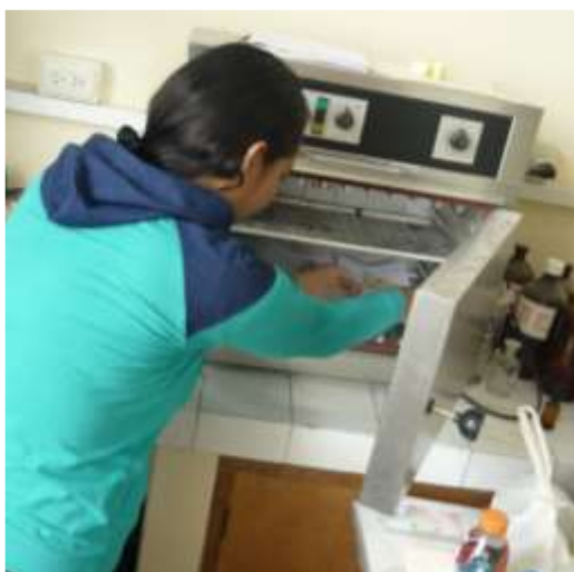
Figura N° 66: Colocando las muestras en el horno a 110°C para obtener muestras secas.
