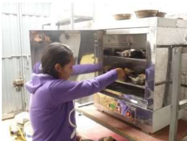
Figura N° 49: Muestras siendo ingresadas al horno a 90°C.
