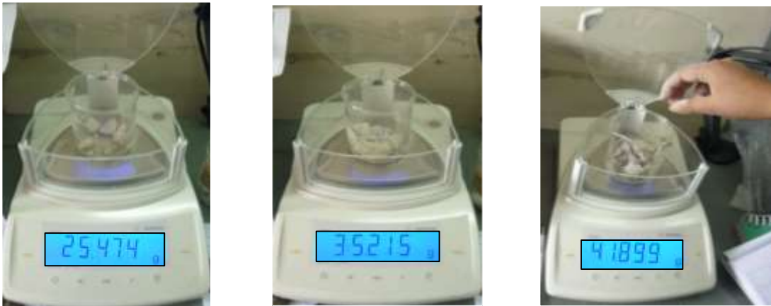
Figura N° 67: Pesando cada una de las muestras de arcilla en una balanza analítica. Se observa que los pesos son diferentes debido al contenido de humedad que presenta cada muestra.
