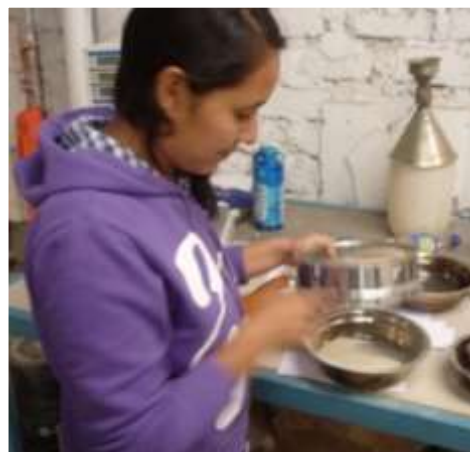
Figura N° 51: Pasando por el tamiz # 200 a cada una de las muestras.
