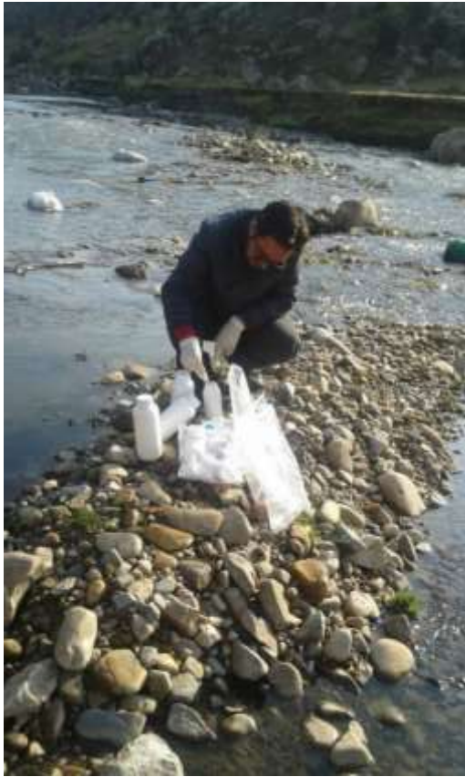
Foto 3.14: Se vierte los concentrados para la conservación de la muestra.
