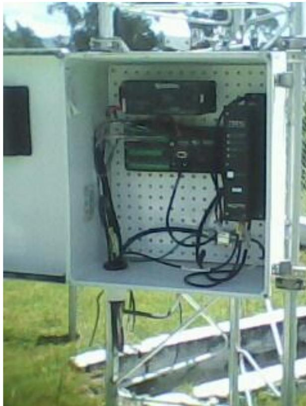
**Foto 2. Datalogger de la estación meteorológica**
