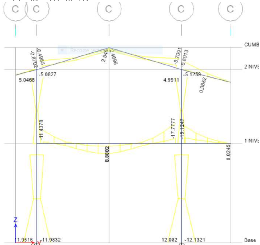
Figura 6.1 Diagrama de Momentos eje C – Sistema Aporticado.
