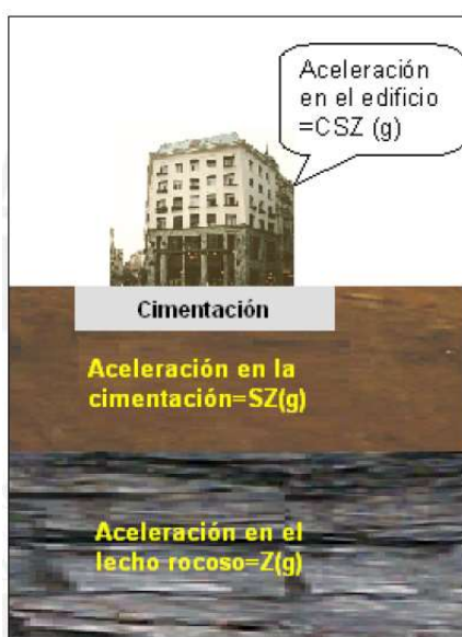
Figura 3.6 Las aceleraciones en la roca, el suelo y el edificio, utilizando los parámetros de sitio, (E.030).
