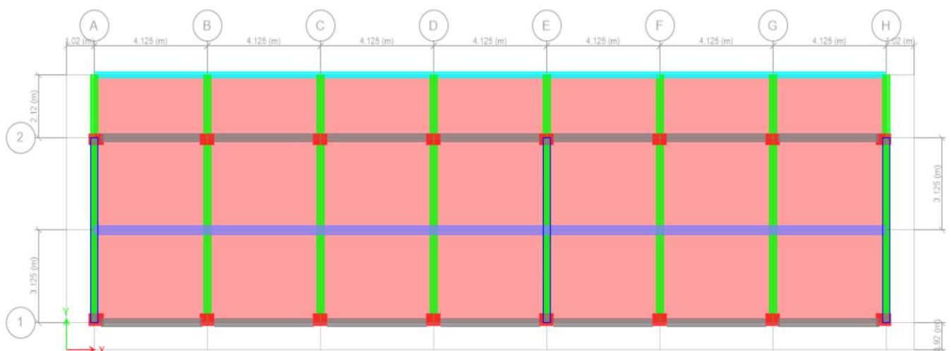
Figura 5.18 Distribución de primera planta – sistema de pórticos.
