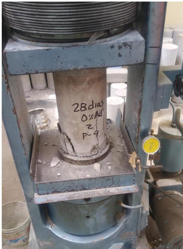
**Imagen 23. Especimen ensayado a compresión con falla tipo 5.**
