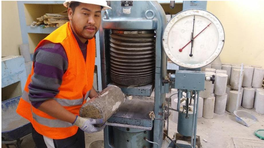
**Imagen 33. Colocación del espécimen de concreto en la prensa hidráulica.**
