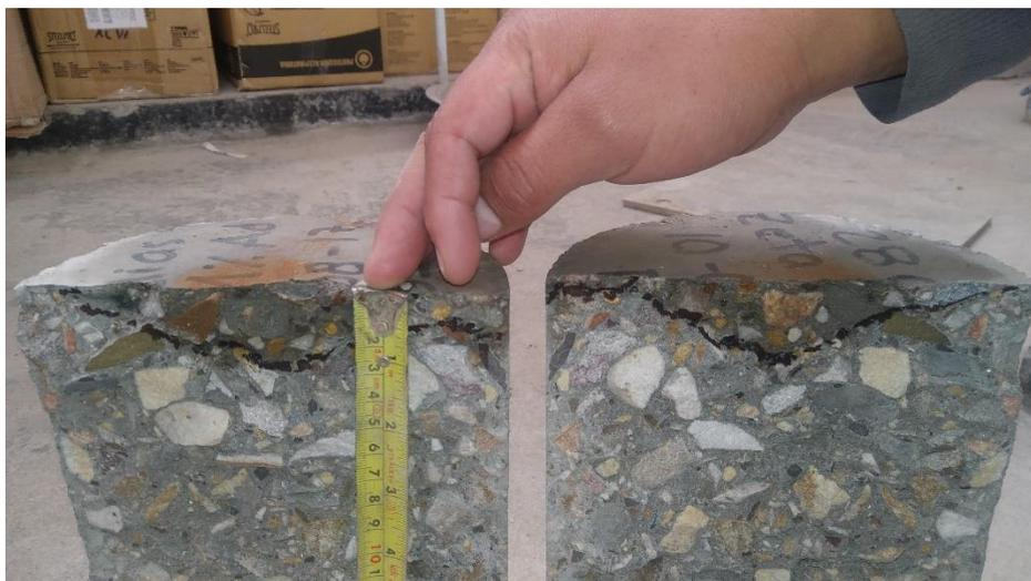
**Imagen 35. Medición de la penetración del agua en el espécimen.**
