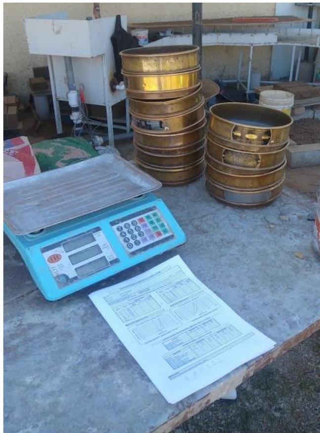
**Imagen 6. Análisis granulométrico del agregado grueso.**
