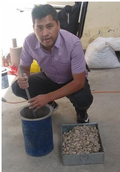
**Imagen 12. Determinación del peso unitario compactado del agregado grueso.**
