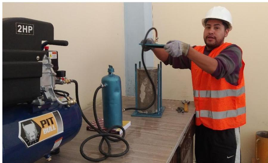
**Imagen 32. Extracción del espécimen sometido a presión de agua por un tiempo determinado.**
