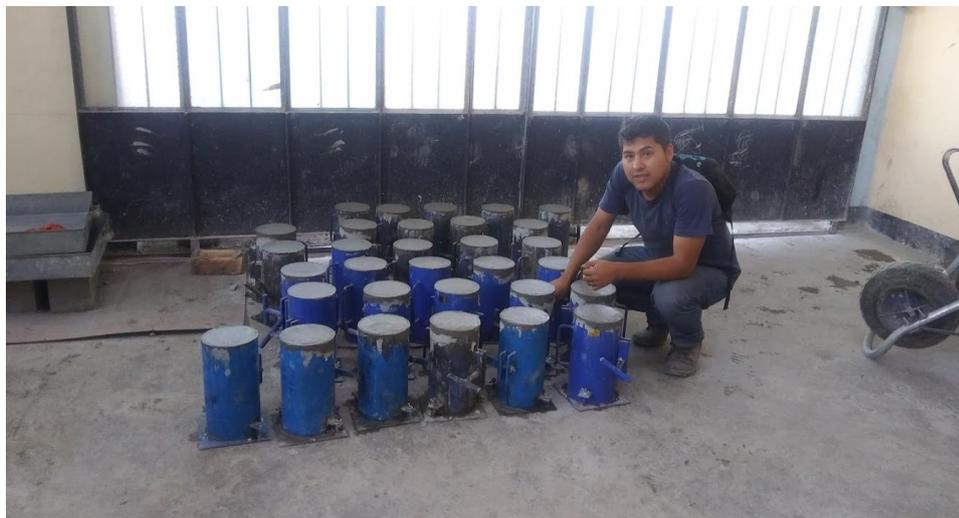
**Imagen 18. Almacenamiento de los especímenes en superficie plana.**
