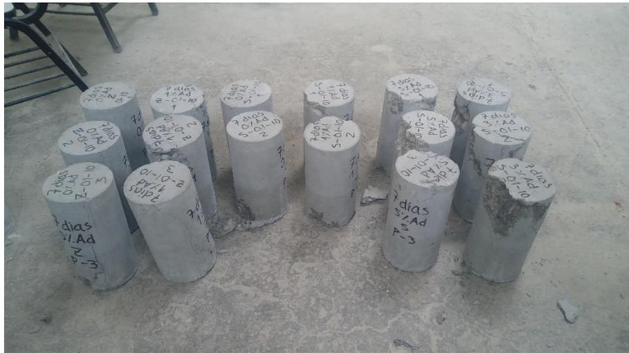
**Imagen 24. Especímenes ensayados a compresión a edad de 7 días.**
