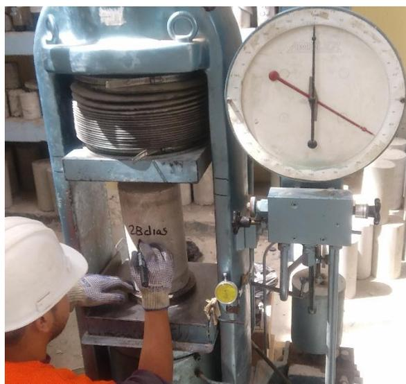
**Imagen 21. Colocación del espécimen en la prensa hidráulica.**
