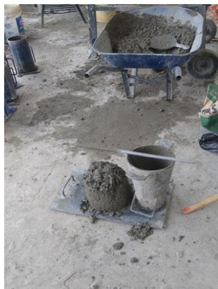
**Imagen 15. Determinación del asentamiento con el cono de abrams.**
