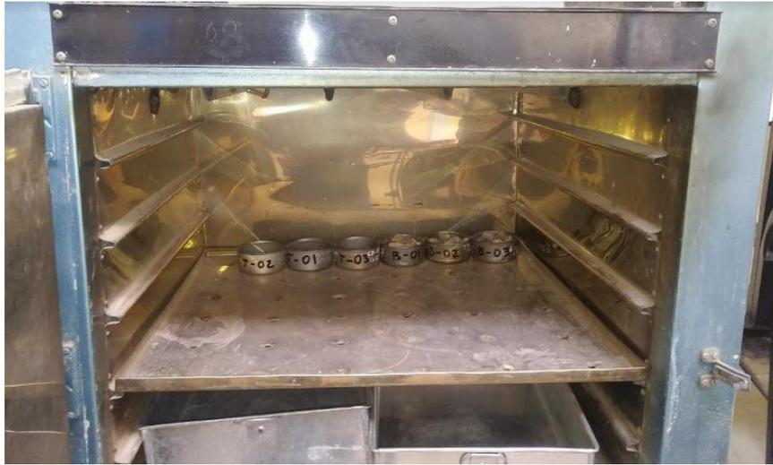
**Imagen 7. Determinación del contenido de humedad del agregado fino y grueso.**
