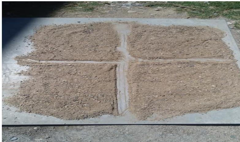
**Imagen 4. Método de cuarteo del agregado fino.**
