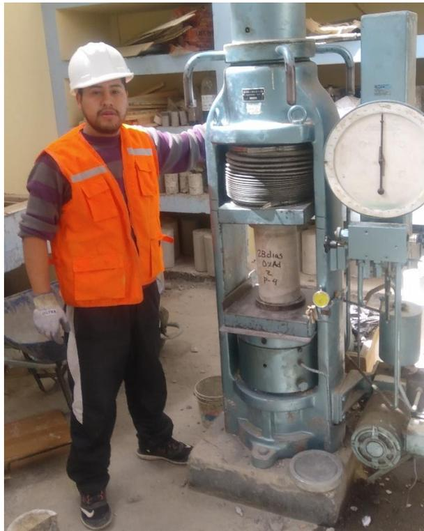
**Imagen 22. Ejecución de la ruptura del espécimen con EPP.**
