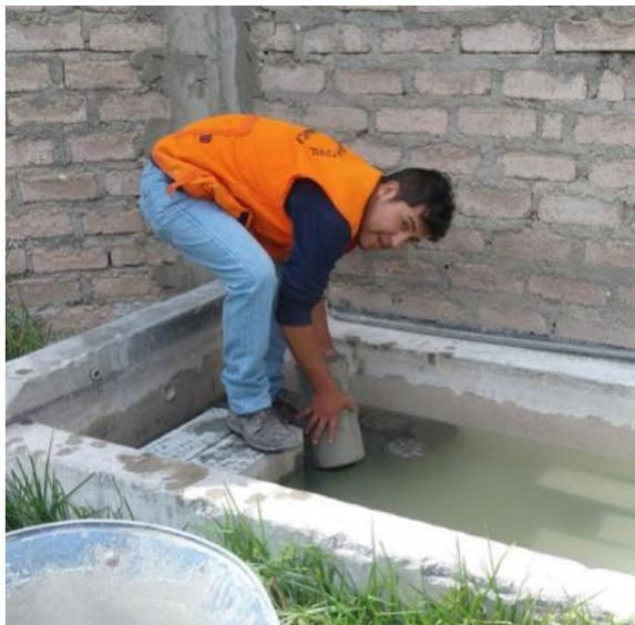
**Imagen 20. Curado final, introduciendo las probetas en agua.**
