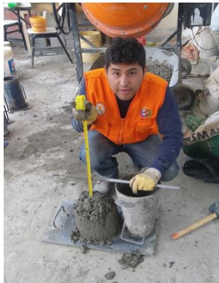
**Imagen 14. Determinación del asentamiento con el cono de abrams.**
