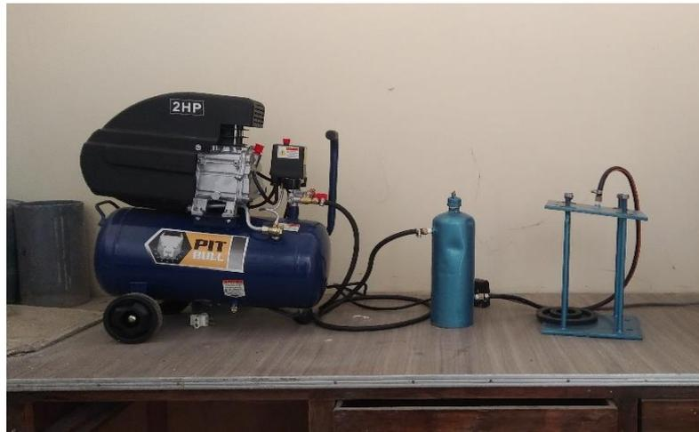
**Imagen 27. Equipo de penetración fabricado por el tesista.**
