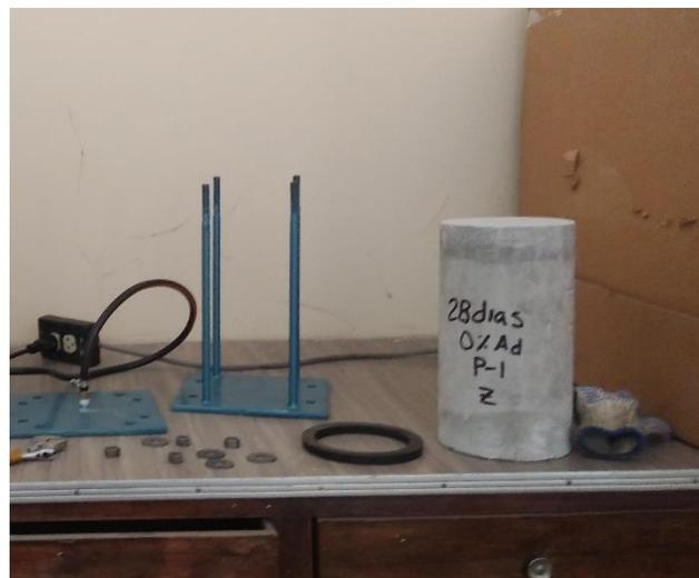
**Imagen 29. Preparación de la probeta que va ser sometida a presión de agua.**
