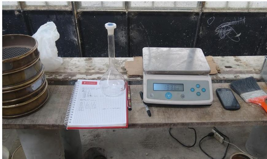
**Imagen 9. Determinación del peso específico del agregado fino y grueso.**
