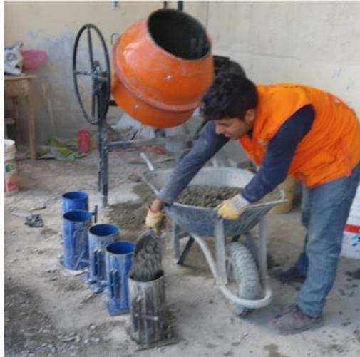
**Imagen 16. Colocación de la primera capa de concreto en el molde.**
