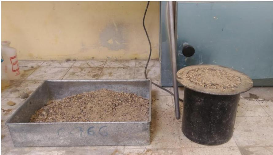
**Imagen 10. Determinación del peso unitario suelto del agregado fino.**
