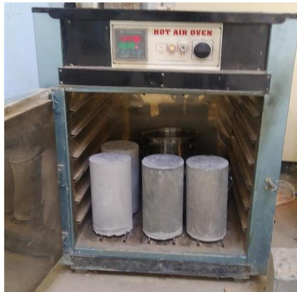
**Imagen 28. Secado de los especímenes en el horno a 110°C.**
