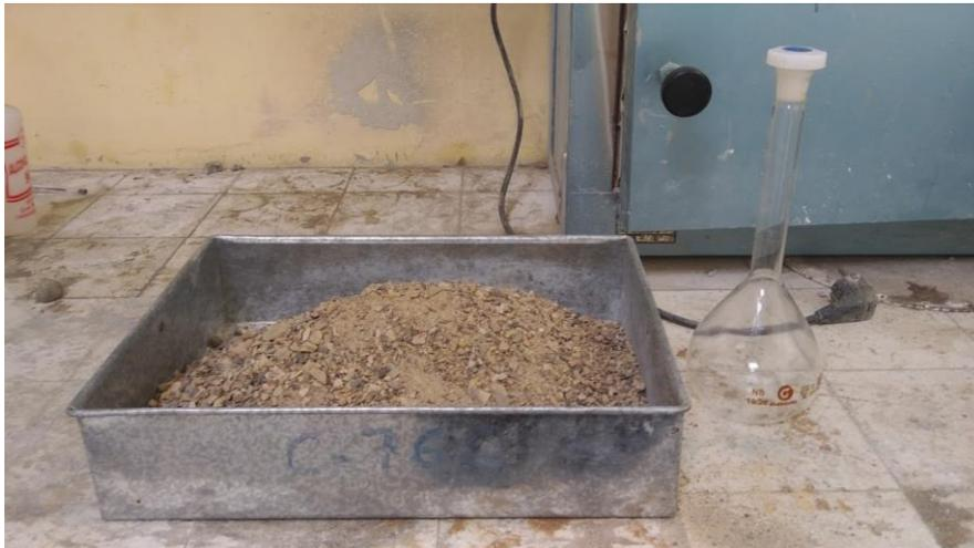
**Imagen 8. Muestra de agregado fino para ensayo de peso específico.**
