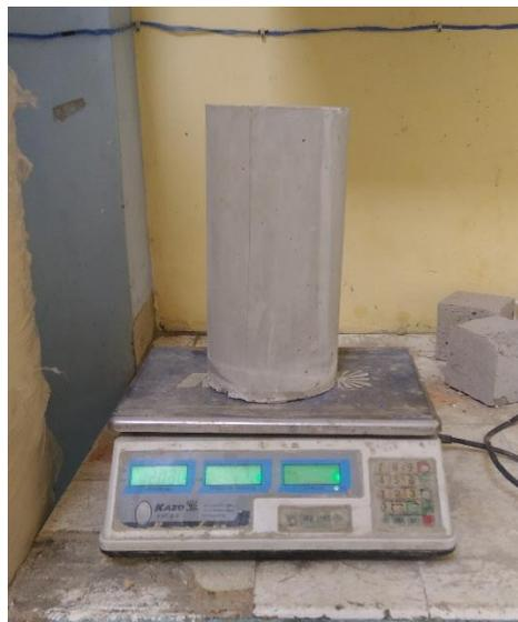
**Imagen 25. Peso del espécimen para el peso unitario del concreto.**
