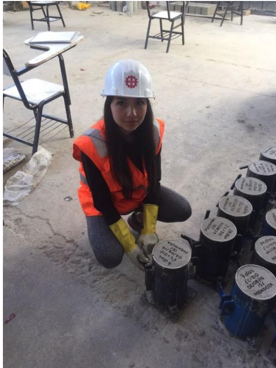
FIGURA 25: Desencofrado de especímenes de concreto
