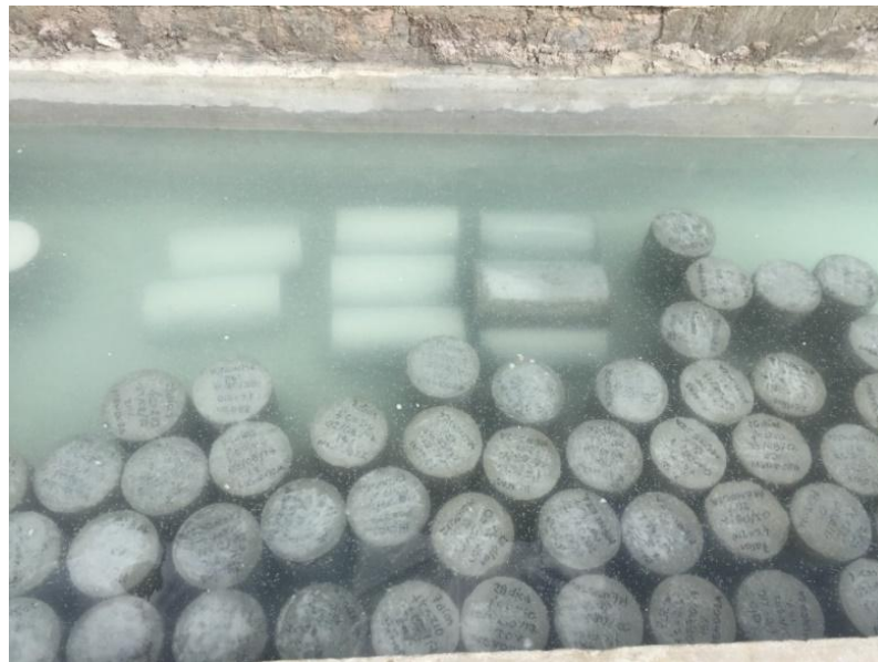
FIGURA 26: Curado de especímenes de concreto
