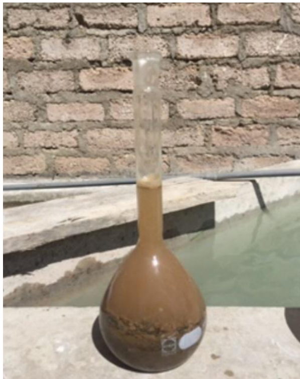
FIGURA 16: Picnómetro lleno con muestra (agregado fino) y agua hasta el 90 % de su capacidad
