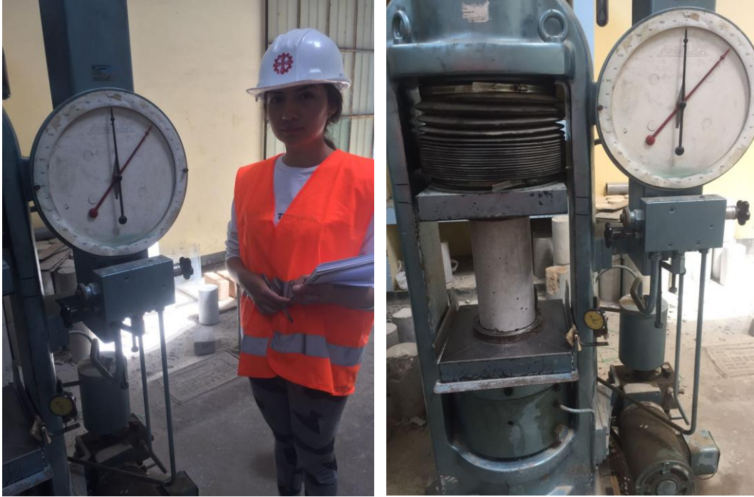
FIGURA 27: Ensayo de resistencia a la compresión de probetas prismáticas
