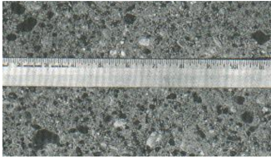
Figura 35. Pulimento de agregados.
