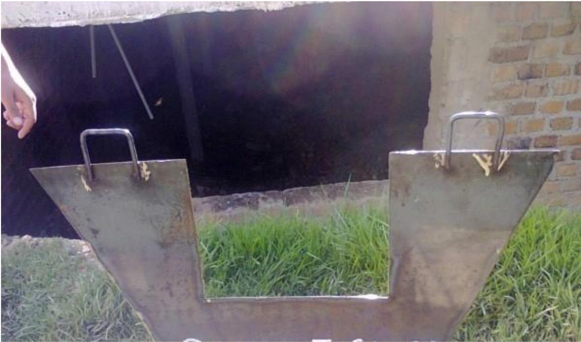
Figura 12: Equipo de Aforo, vertedero rectangular para sección inicial.
