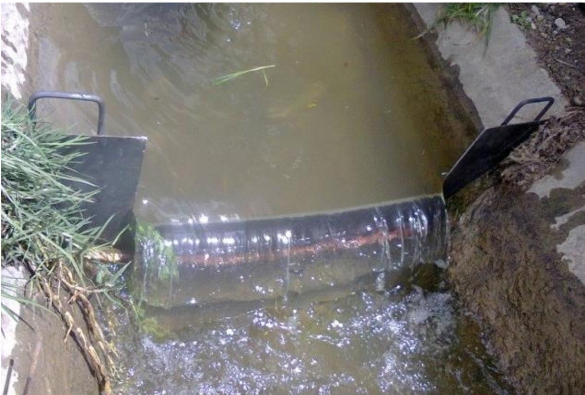
Figura 13: Toma de datos, vertedero de pared delgada rectangular.
