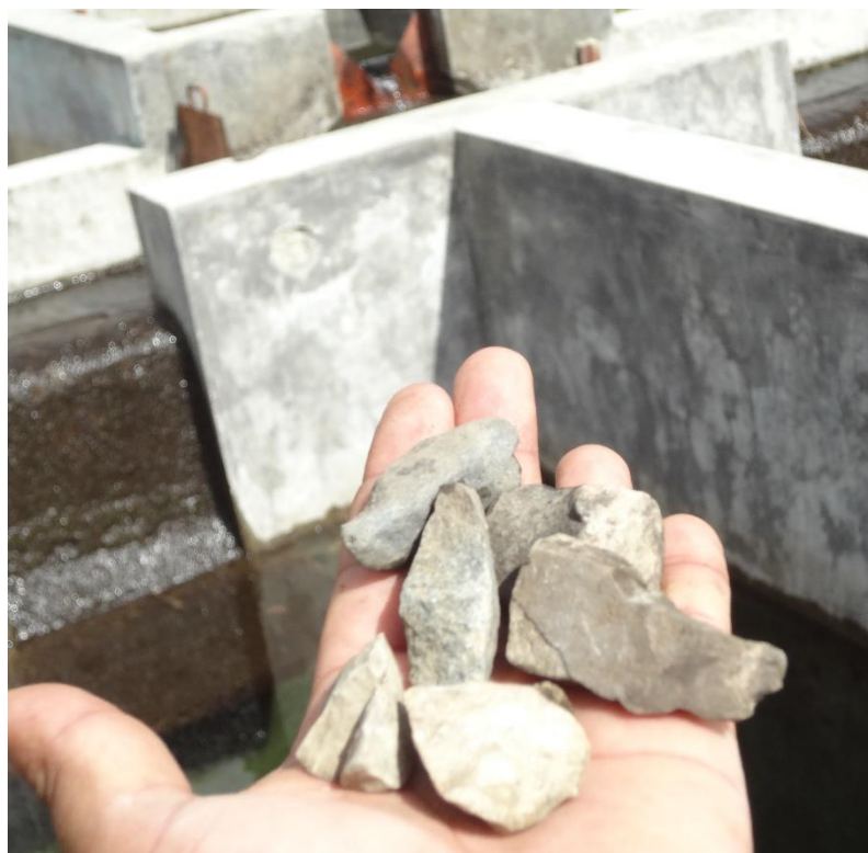
FOTO N° 20: material utilizado en el filtro lento
