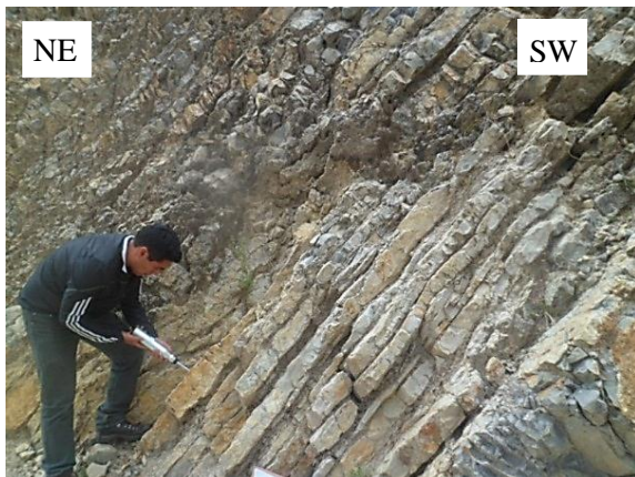
Figura 60. Uso de martillo de Schmidt sobre un estrato de calizas nodulares de la Formación Pariatambo.
