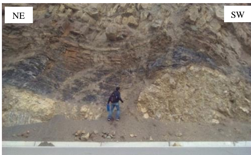
Figura 44. Pliegues evidenciados en estratos de calizas intercaladas con lutitas gris oscuras de la Formación Yumagual ubicados en corte de carretera Encañada-Celendín.
