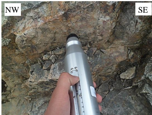
Figura 58. Uso de martillo de Schmidt sobre un estrato de areniscas cuarzosas de la Formación Farrat.
