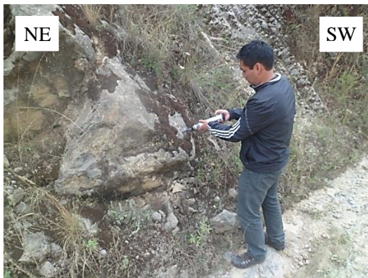
Figura 59. Uso de martillo de Schmidt sobre un estrato de calizas arenosas de la formación Chulec.
