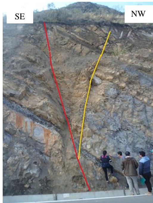
Figura 42. Falla normal (color rojo) con presencia de una falla conjugada (color naranja) en estratos de calizas intercaladas con lutitas de la Formación Yumagual.
