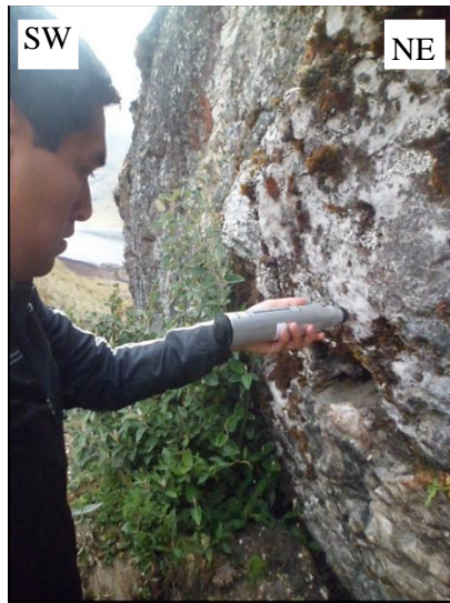
Figura 56. Uso de martillo de Schmidt sobre un estrato de areniscas cuarzosas de la formación Chimú.
