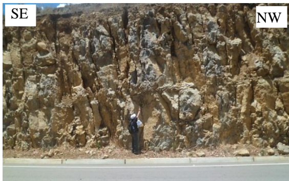
Figura 62. Uso de martillo de Schmidt sobre estratos de calizas de la Formación Mujarrún.
