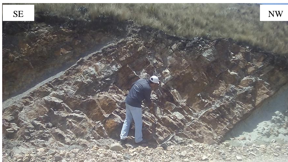
Figura 18. Intercalación de capas delgadas de areniscas rojizas con lutitas grises de la Formación Carhuáz, ubicado cerca al cruce de la carretera Quinuamayo-Micuypampa.
