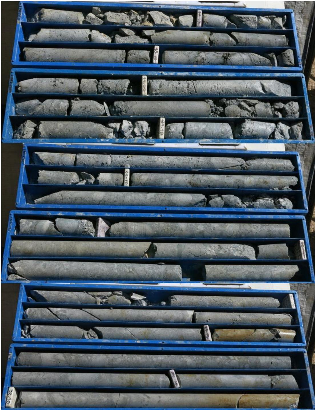
Foto 34. Perforación geotécnica DH-14-04, caja con muestras de 16,60 a 33,00 m.
