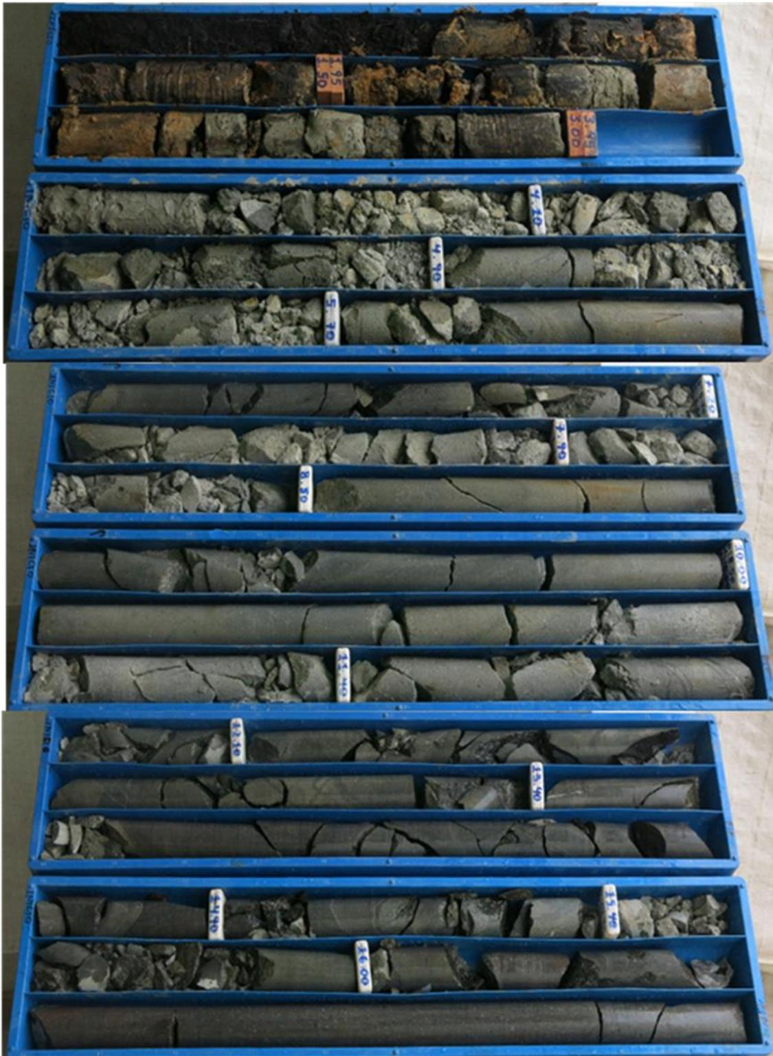
Foto 29. Perforación geotécnica DH-14-01, caja con muestras de 0,00 a 17,50 m.
