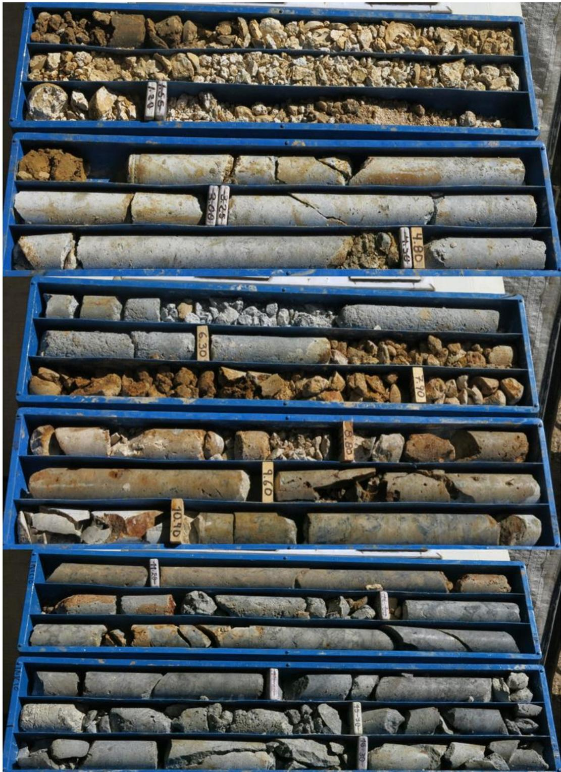
Foto 33. Perforación geotécnica DH-14-04, caja con muestras de 00,00 a 16,60 m.
