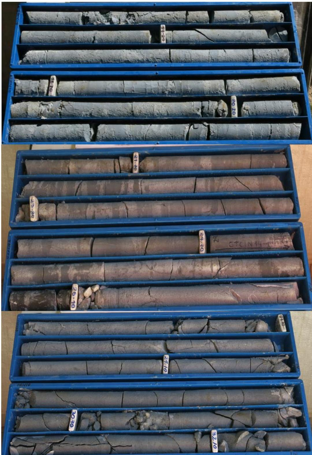
Foto 32. Perforación geotécnica DH-14-03, caja con muestras de 15,85 a 32,40 m.
