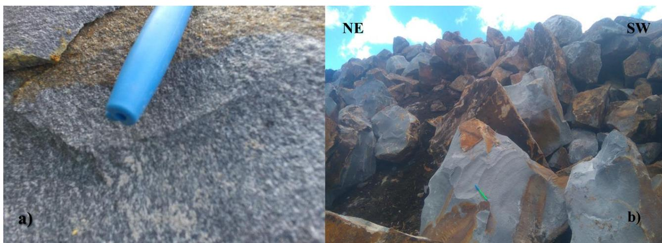
Foto 20. Evaluación de las propiedades de las rocas a través del análisis RQD y las condiciones GSI, en muestras obtenidas de la zona central del sistema de pozas. a) De acuerdo a las características mineralógicas de las rocas se determinó la presencia de Andesitas, b) Se evaluaron además las propiedades geomecánicas de bloques rocosos Andesíticos.
