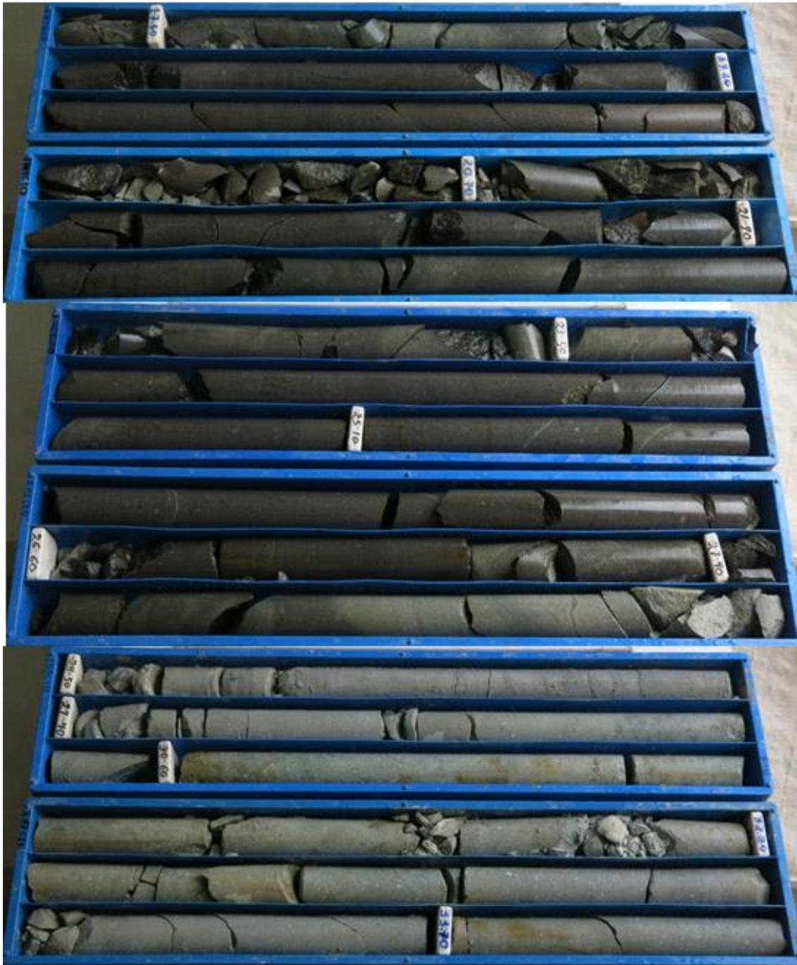
Foto 30. Perforación geotécnica DH-14-01, caja con muestras de 17,50 a 34,15 m.
