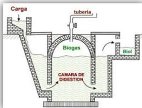
Figura 3. Diagrama de una planta de biogás convencional.
