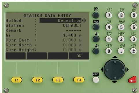
Se selecciona el método Resection (estación libre, free station, inversa) y se aplasta ok (f4)
