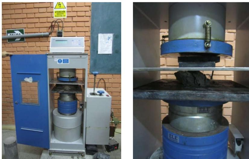
Fig. 3. Equipos de medición de la resistencia mecánica a compresiva.
