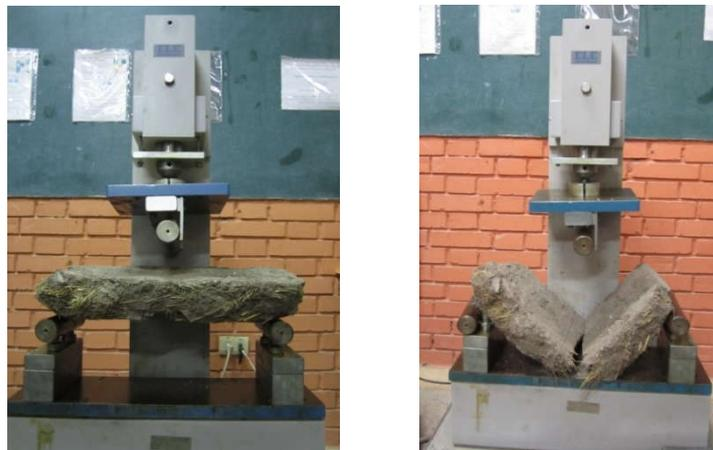
Fig. 2. Equipos de medición de la resistencia mecánica a flexión del adobe.
