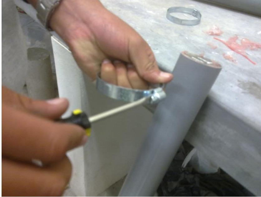
Figura 35: Instalación de probetas para ensayo de permeabilidad.
