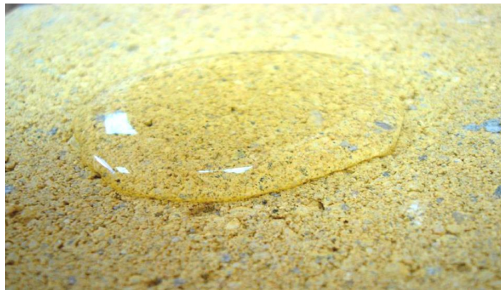
Figura 5: Efecto de aditivo hidrófugo sobre mortero.
