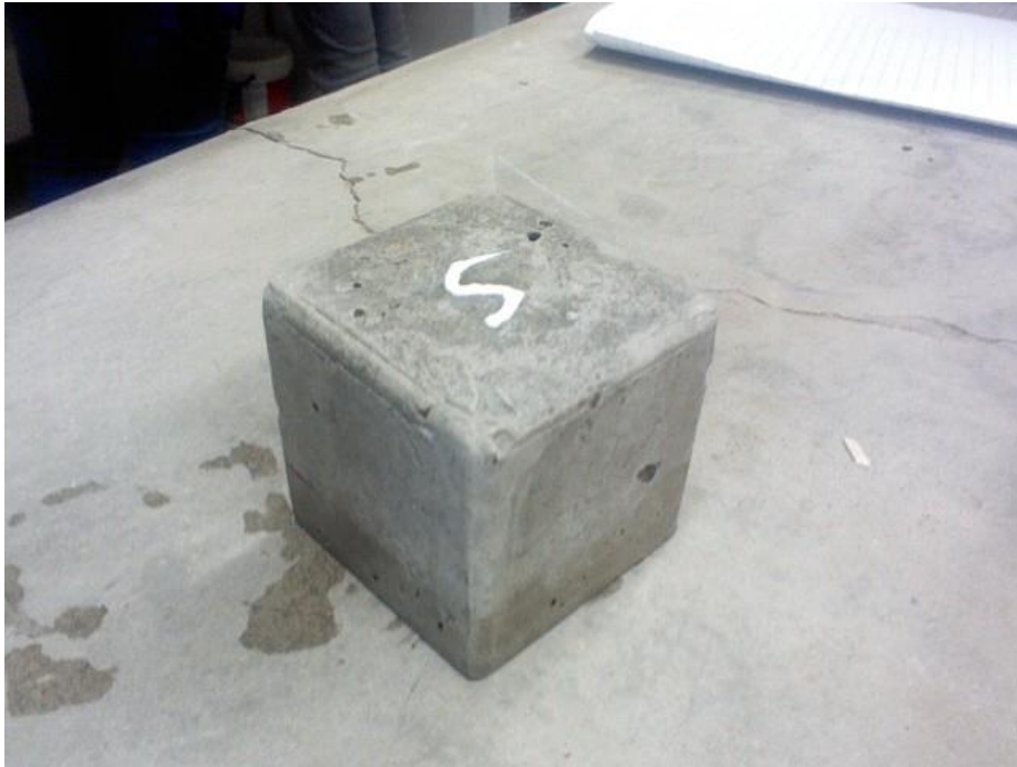
Figura 33: Se puede apreciar la muestra luego de las tres horas del ensayo de capilaridad.
