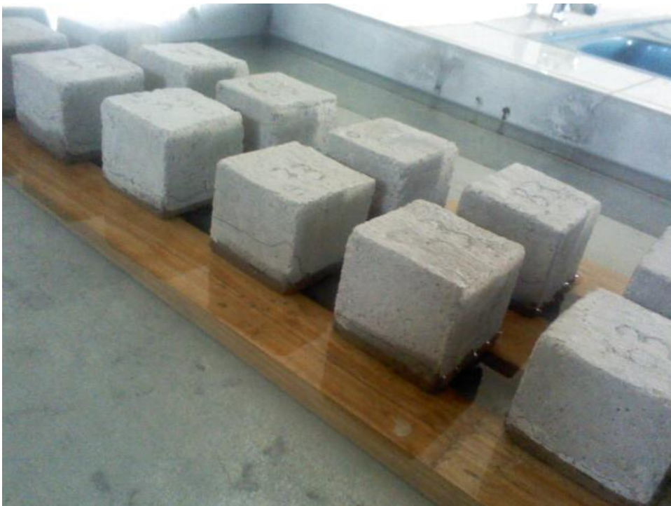
Figura 34: Se muestra altura del fleco capilar del grupo experimental GC.
