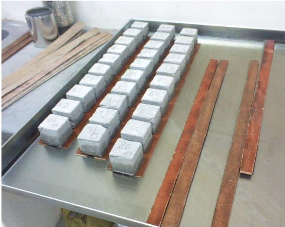
Figura 31: Ensayo de capilaridad de grupo experimental GD.
