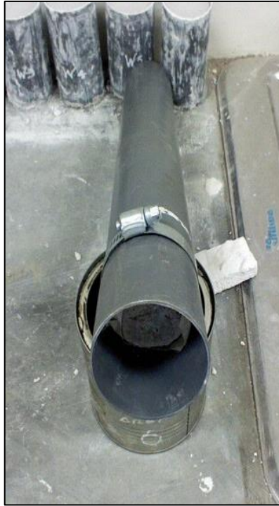
Figura 43: Colocado de muestra en permeámetro
