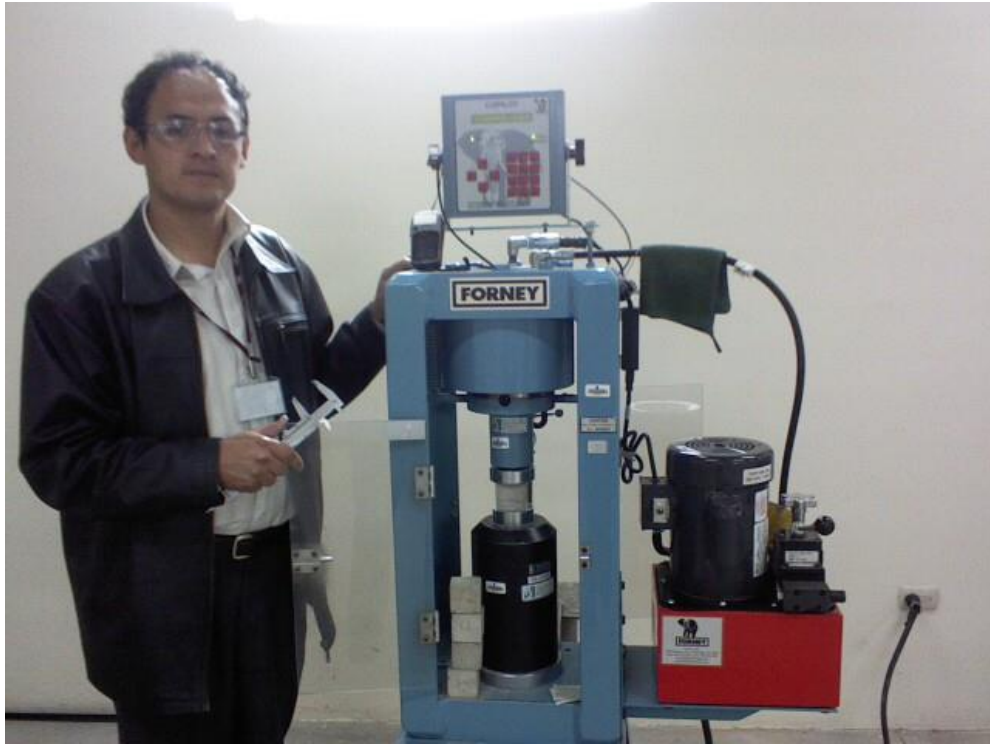
Figura 39: Ensayo de resistencia a la compresión
