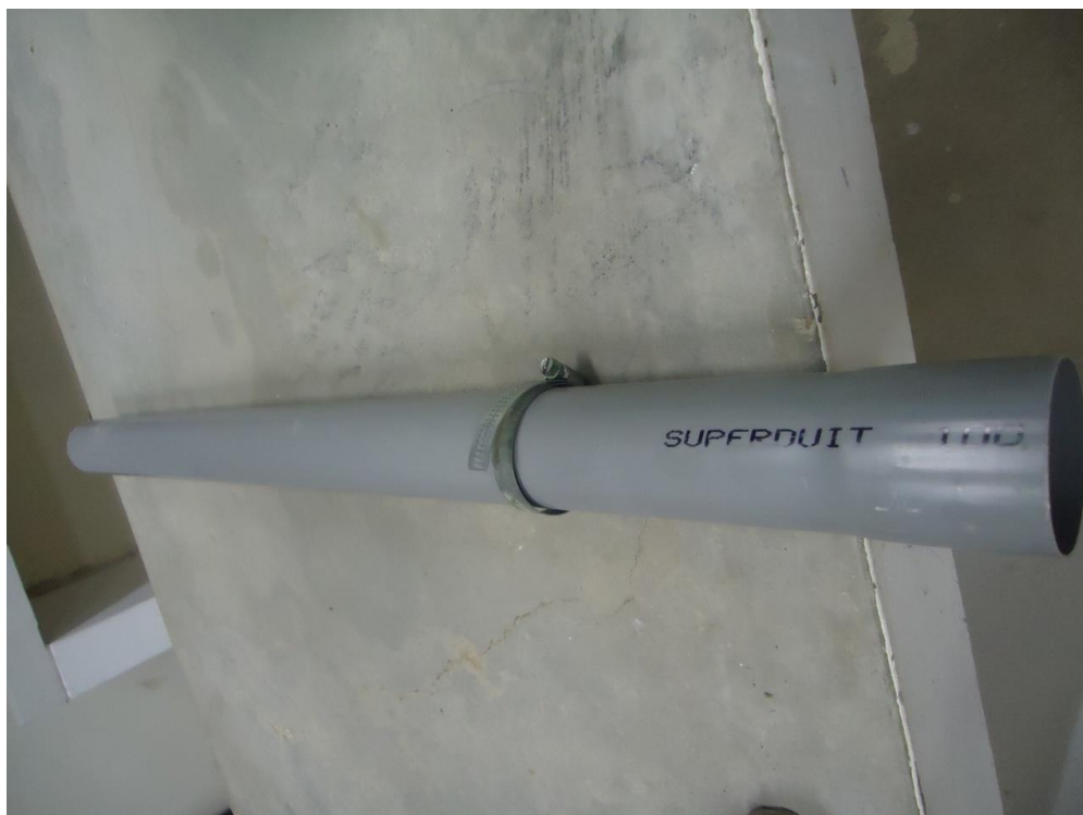
Figura 36: Colocación de muestra para el ensayo de permeabilidad.
