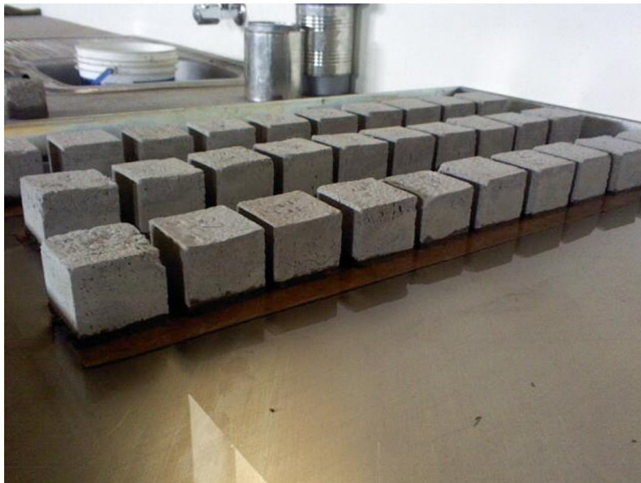
Figura 32: Ensayo de capilaridad, se puede apreciar la altura del fleco capilar del grupo experimental GB, la cual es menor que la del grupo sin aditivo.
