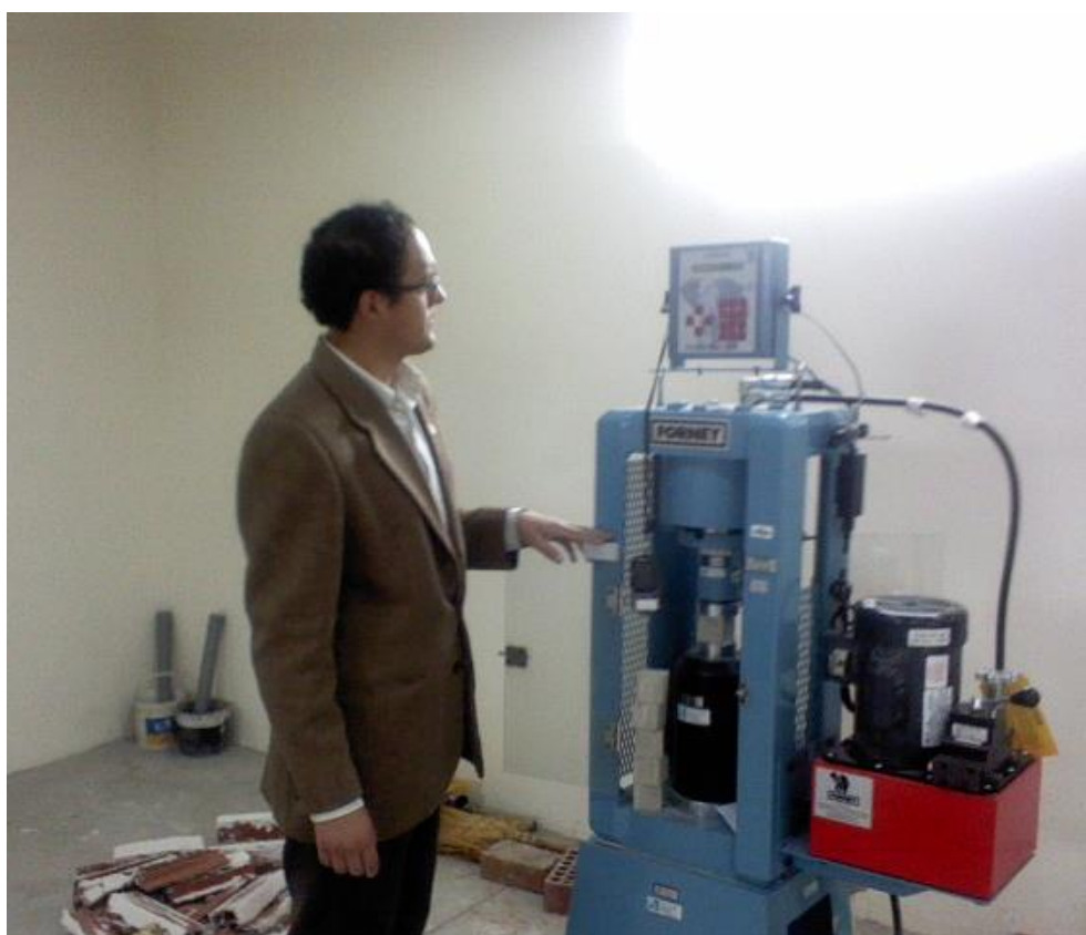
Figura 38: Ensayo de resistencia a la compresión.
