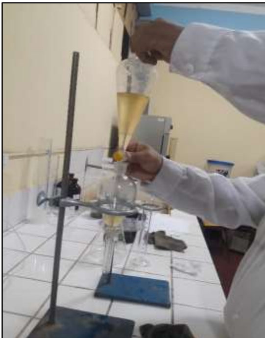
Foto 25: Paso de la fase orgánica a otro embudo de decantación
