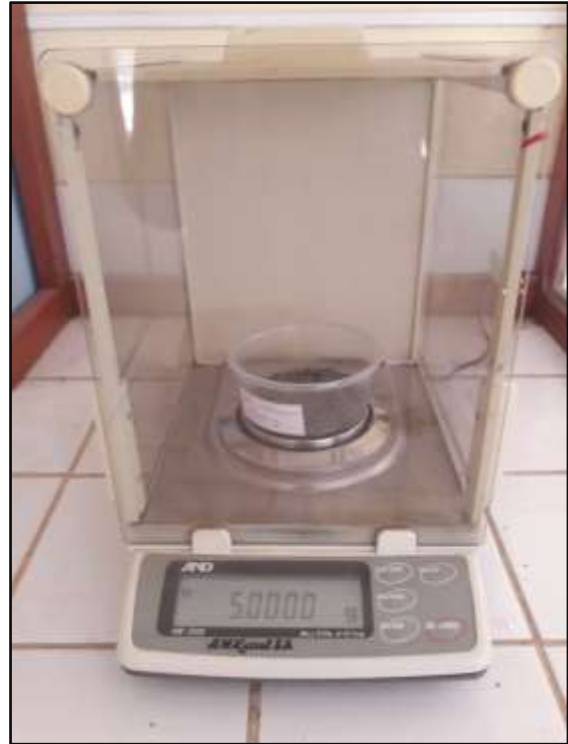
Foto 18: Pesaje de 5g de la muestra pulverizada y tamizada
