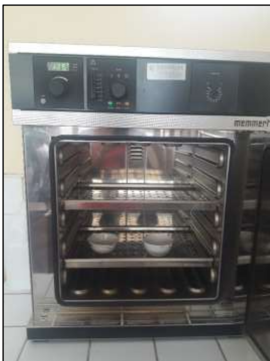
Foto 29: Secar en la estufa a 105^\circ\text{C} hasta peso constante
