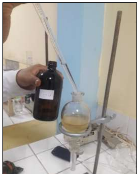
Foto 26: Extracción de la fase clorofórmica con 5ml de KOH al 1%
