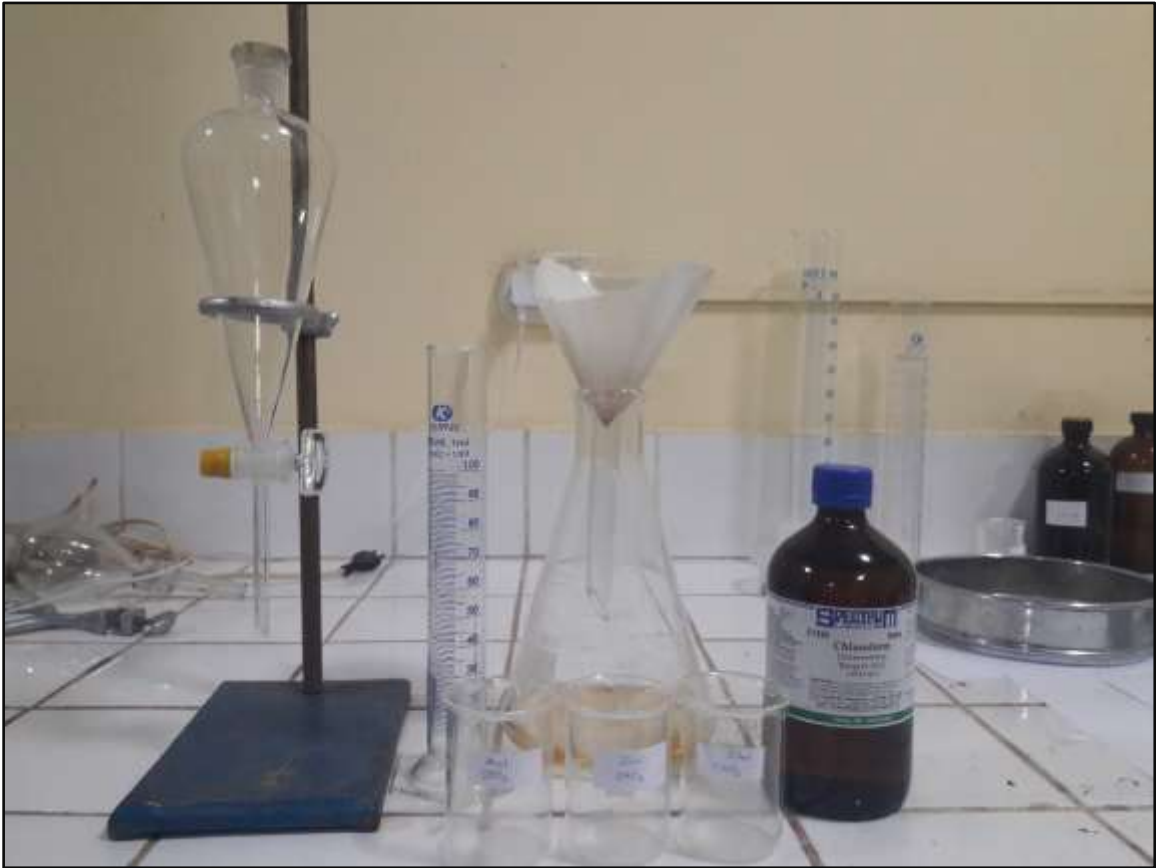
Foto 24: Extracción en el embudo de decantación con 3 cantidades de cloroformo (30, 25 y 20 ml)
