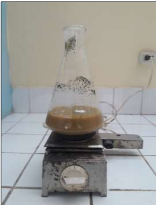
Foto 22: Hervir lentamente la muestra por dos horas
