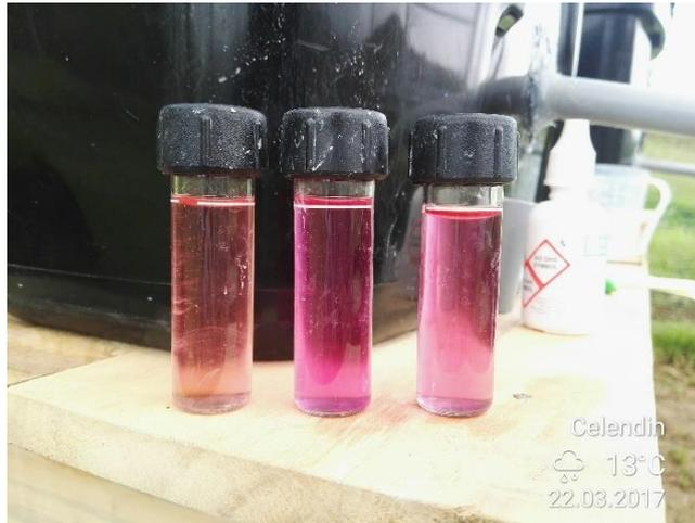
**Figura 30.** Comparación colorimétrica de muestras para análisis de pH.
