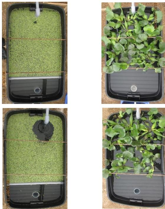
**Figura 26.** Puesta en marcha del sistema de reactores en serie con *Lemna sp* y *Eichhornia crassipes*, fecha: 03/03/2017.
