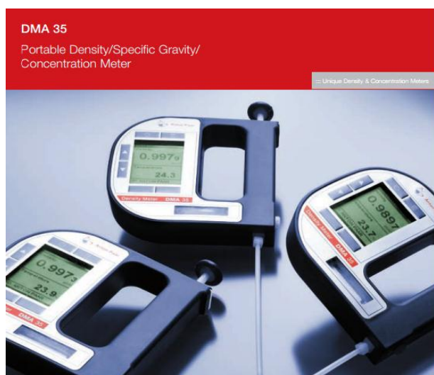
Foto 4. Utilización del desímometro portatil DMA35 para determinar la gravedad especifica
