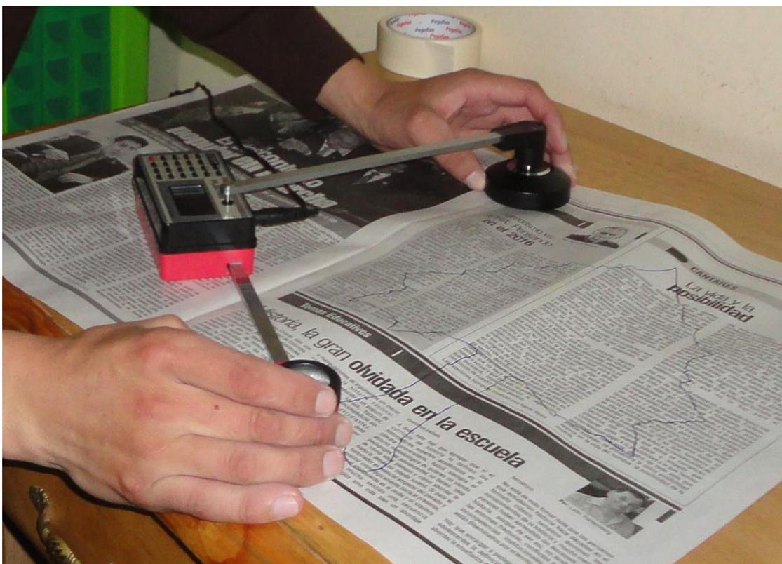
Fig. 7. Forma como se dispuso el planímetro para determinar el área real de las láminas.
