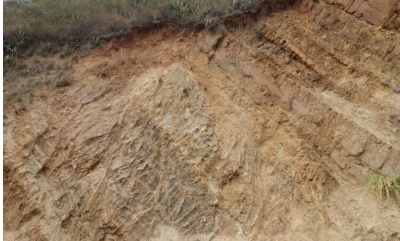
Foto N° 06. Coordenadas E: 813735, N: 9193150 Fm. Carhuaz, intercalación de areniscas y lutitas presentes en la carretera de Huayobamba a Paucamarca.
