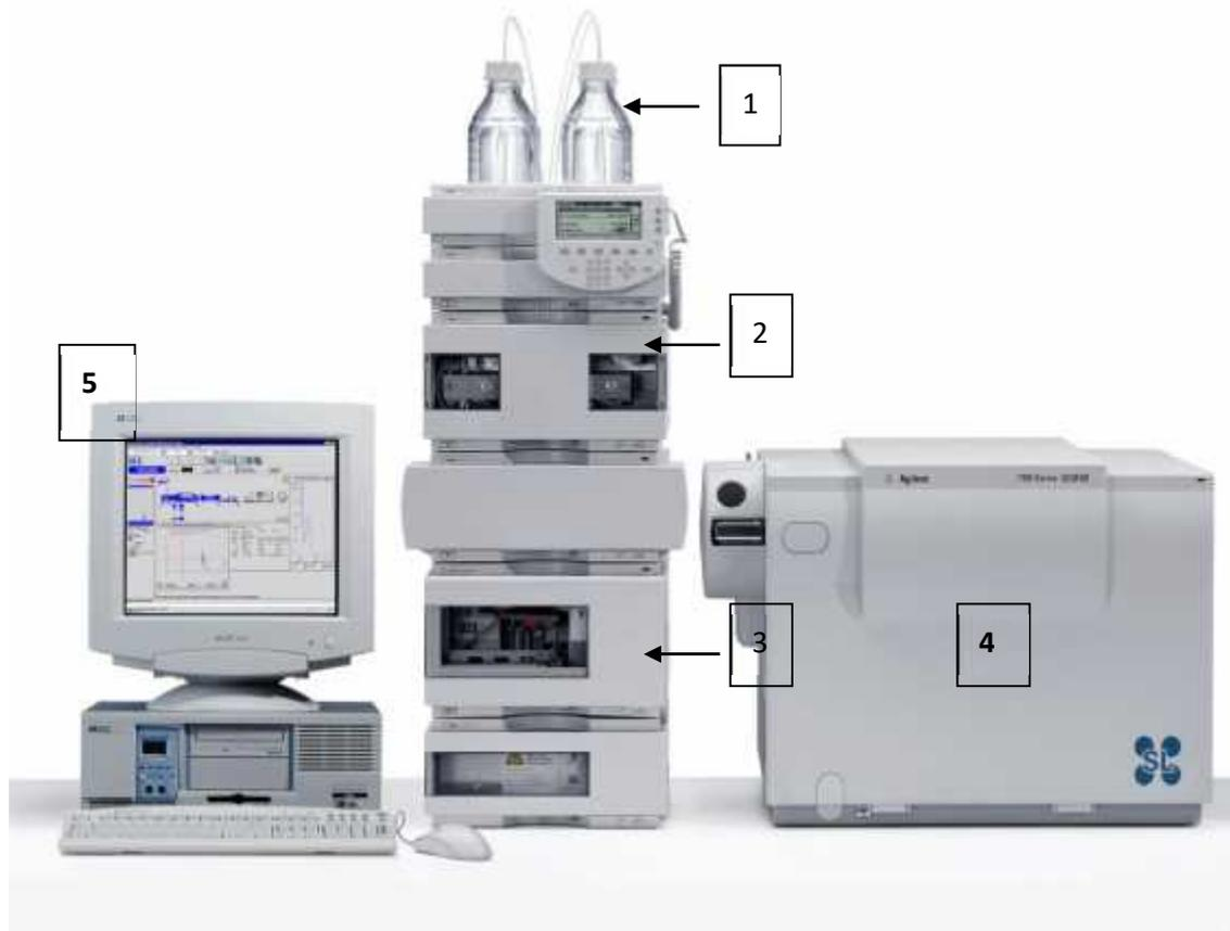
**Figura 6. Componentes de un equipo HPLC: 1. Fase Móvil, 2. Volumen de Inyección, 3. Columna y bloque térmico, 4. Detector UV, 5. Integrador.**
