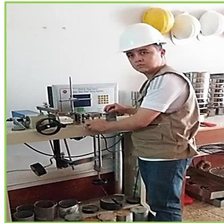
**FOTO N°04:** Ensayo de mecánica de suelos: ensayo de Corte Directo.
