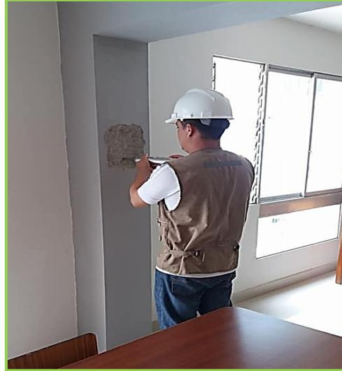
**FOTO N°06:** Ensayo de Esclerometría: Columnas del Segundo Nivel Pabellón 1 y Pabellón 2.
