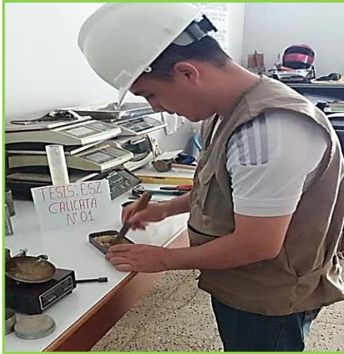
**FOTO N°03:** Ensayo de mecánica de suelos: Límites de Consistencia.
