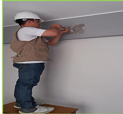
**FOTO N°07:** Ensayo de Esclerometría: Vigas del Segundo Nivel Pabellón 1 y Pabellón 2.
