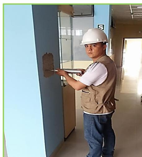
**FOTO N°05:** Ensayo de Esclerometría: Columnas del Primer Nivel Pabellón 1 y Pabellón 2.
