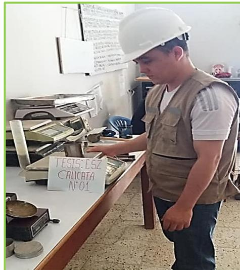
**FOTO N°02:** Ensayo de mecánica de suelos: Análisis Granulométrico y Contenido de Humedad.
