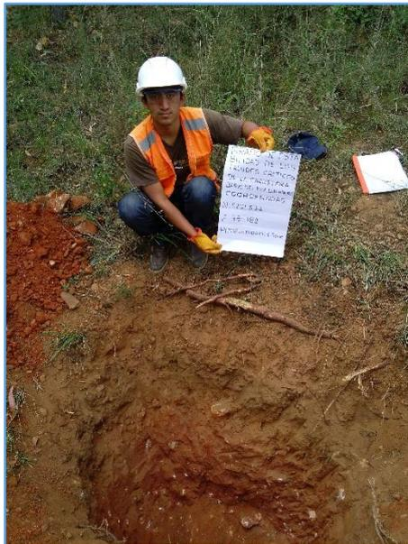
Foto N° 8: Calicata para la extracción de muestras para granulometría y corte directo.
