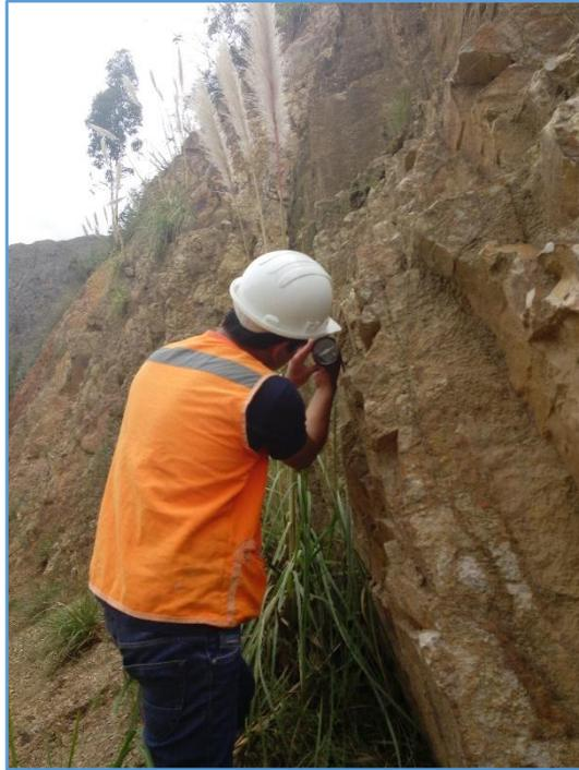
Foto N° 7: Uso de brújula en la toma de DIP y DD.
