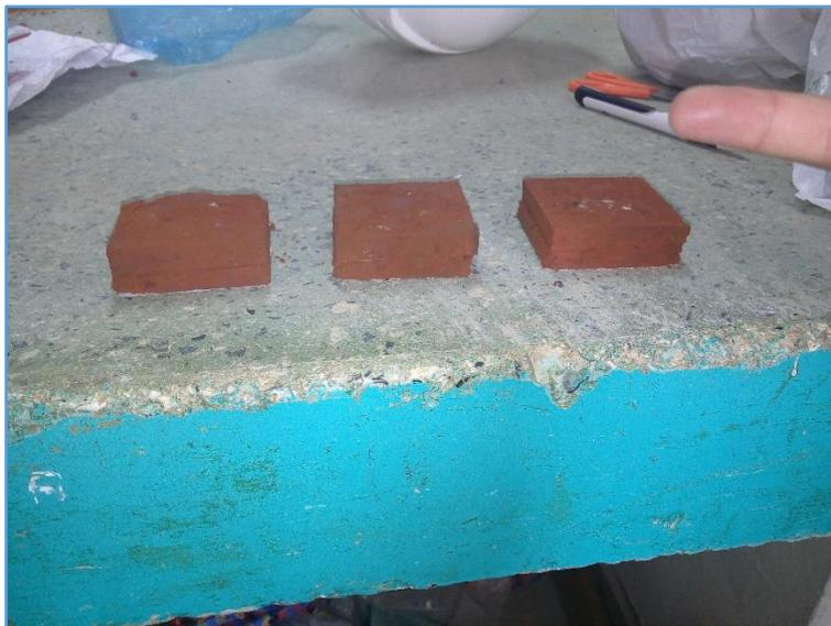
Foto N° 10: Muestras ensayadas por corte directo con 1,2 y 4 Kg.
