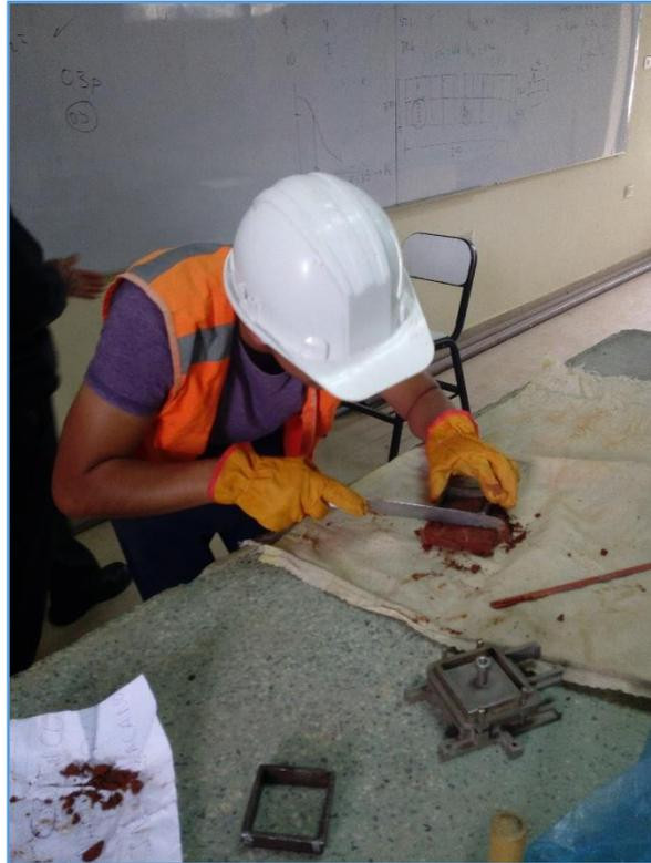
Foto N° 9: Muestras para el ensayo de corte directo.
