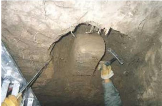
Figura 27. Extracción de la muestra de suelo para el ensayo triaxial
