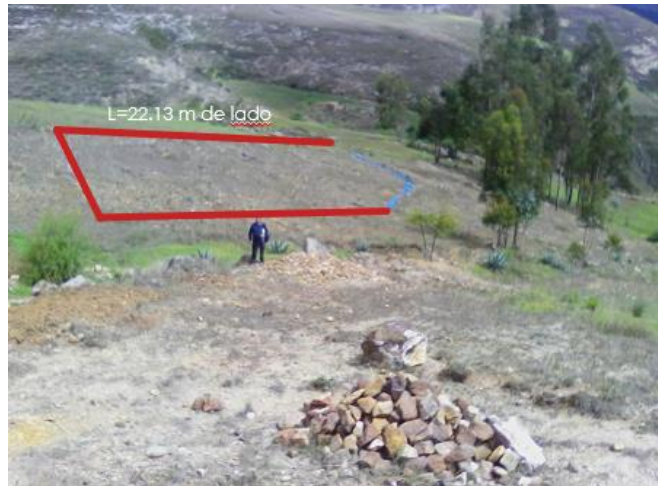
Figura 30. Parcela piloto para determinar la erosión del suelo
