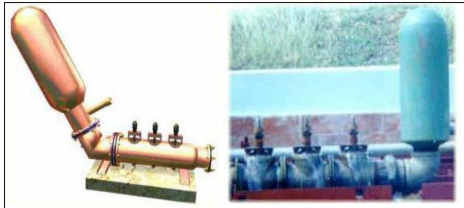
Figura 12. Bombas de ariete hidráulico multigolpe
