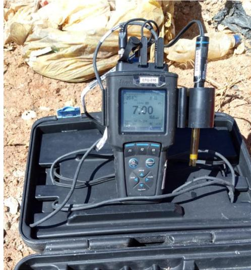
Figura 19: Equipo multiparámetro para medir el pH en campo
