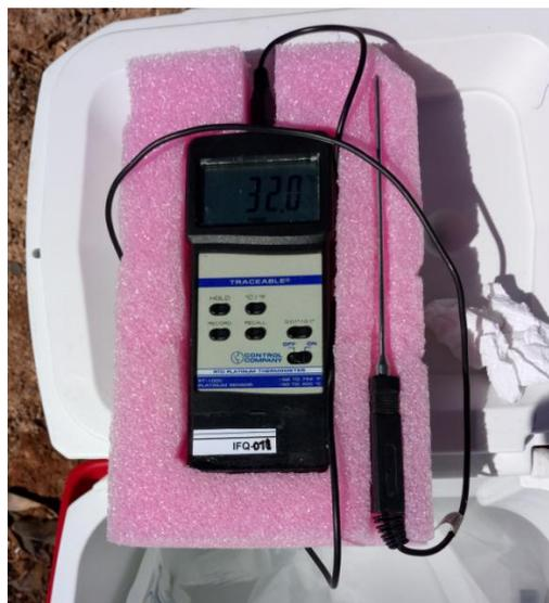
Figura 20: Termómetro con sensor de platino para medir la temperatura
