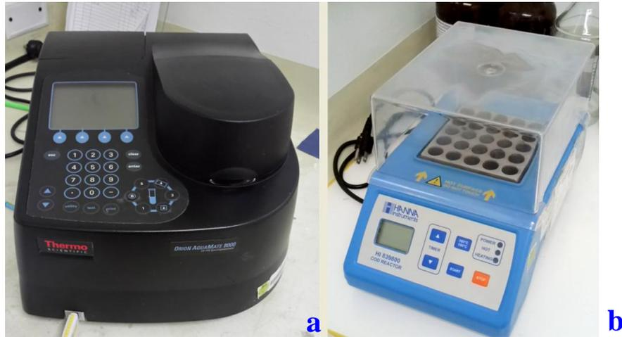
Figura 25: Espectrofotómetro UV visible y biodigestor
