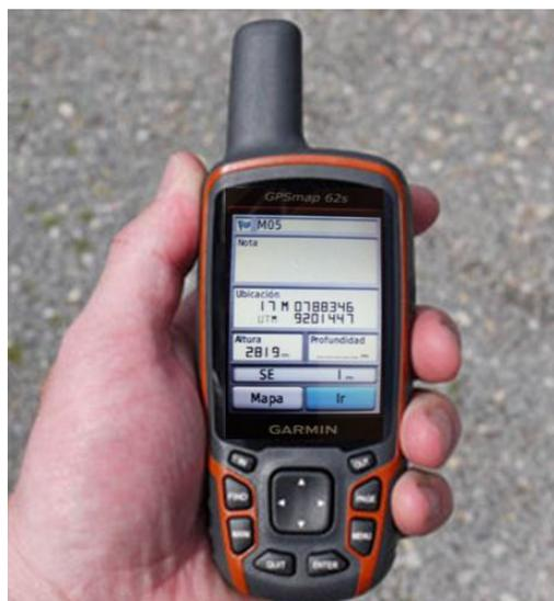
Figura 24: Equipo de posicionamiento global GPS
