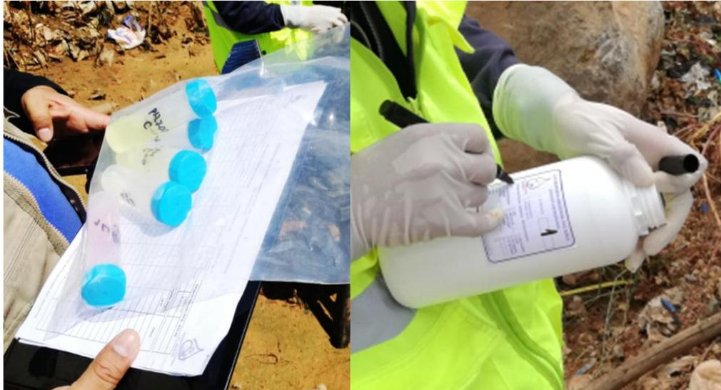
Figura 21: Frascos de plástico de alta densidad para muestras de pH
