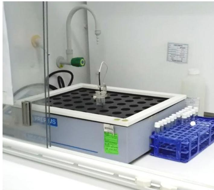
Figura 27: Digestor de metales
