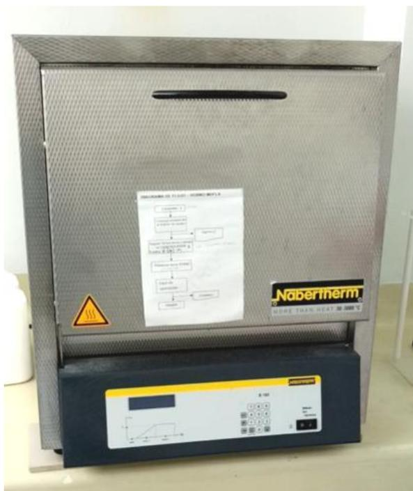
Figura 31: Horno mufla de 30 °C a 3000 °C
