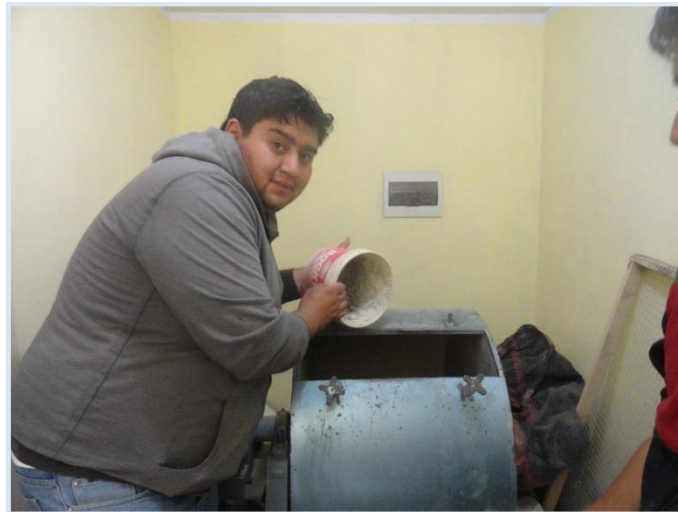
Figura 27. Ensayo de abrasión
