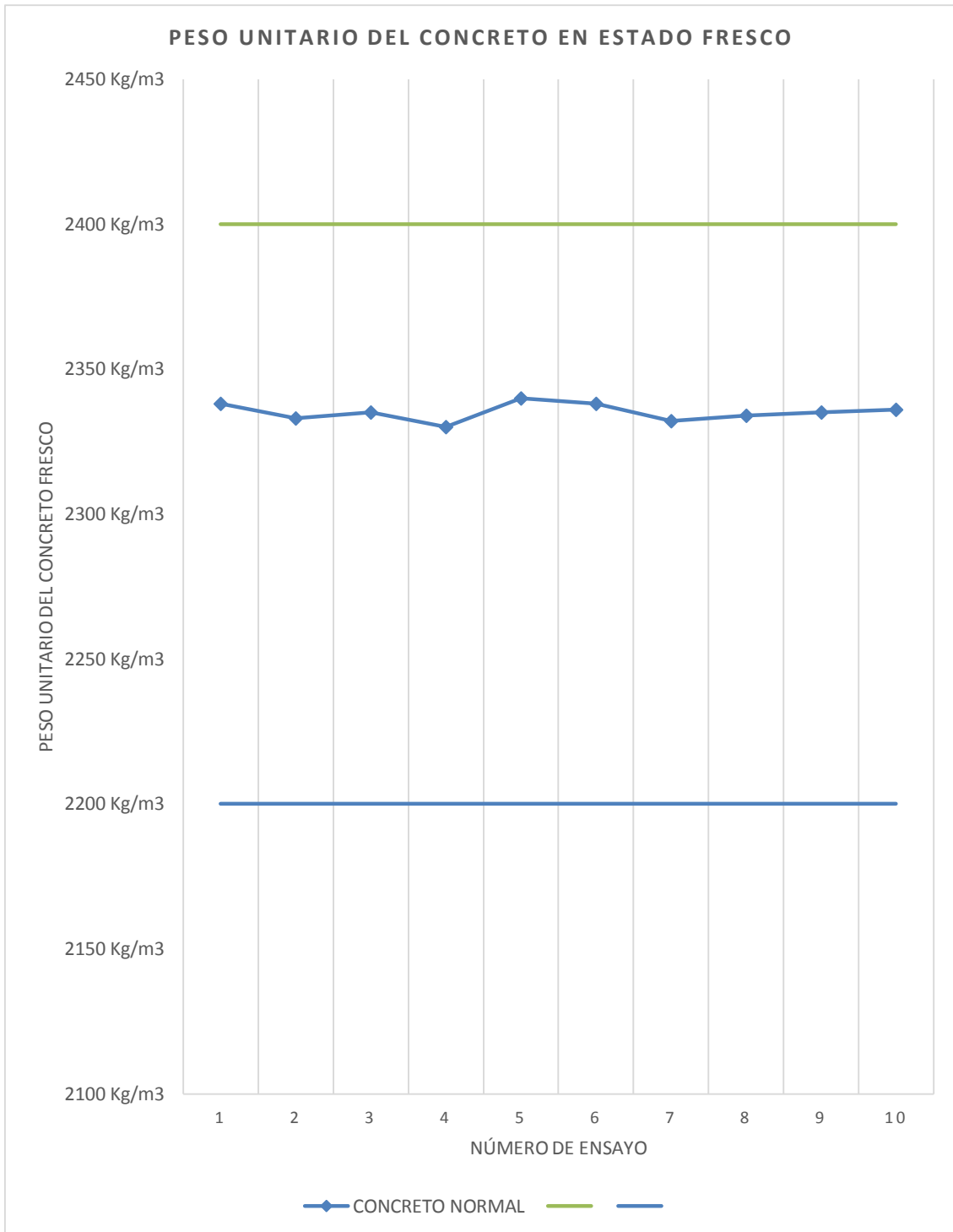
Figura 11. Peso unitario del concreto en estado fresco
