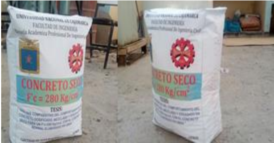
Figura 37. Concreto envasado en seco
