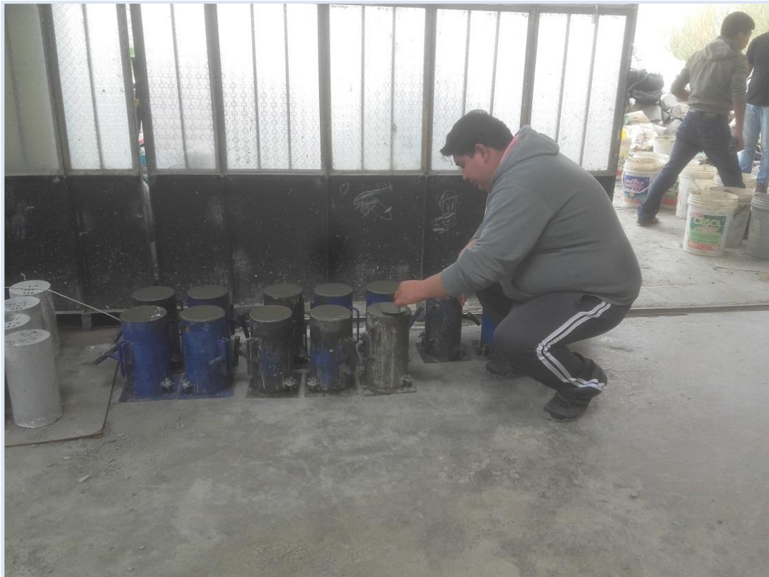
Figura 29. Enrasado de los especímenes cilíndricos
