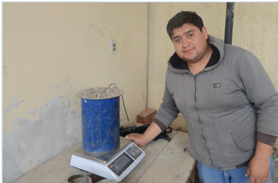
Figura 24. Peso unitario del agregado grueso
