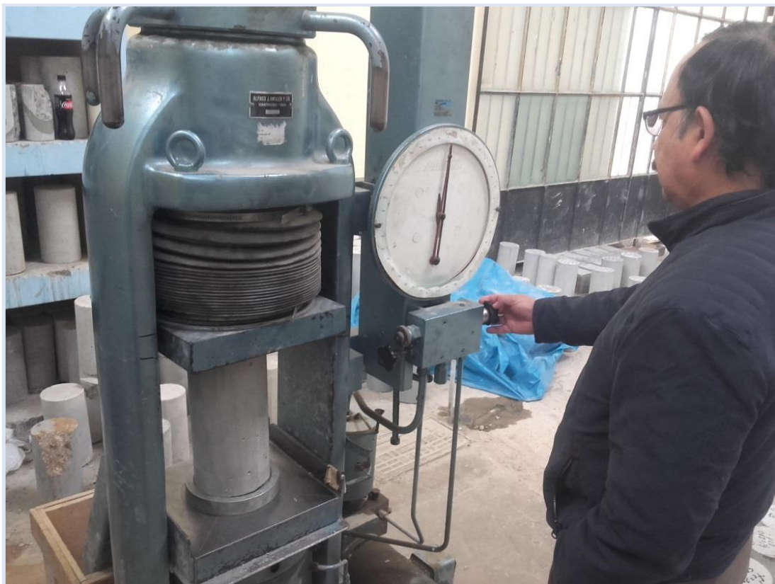
Figura 34. Ensayo a la compresión axial.
