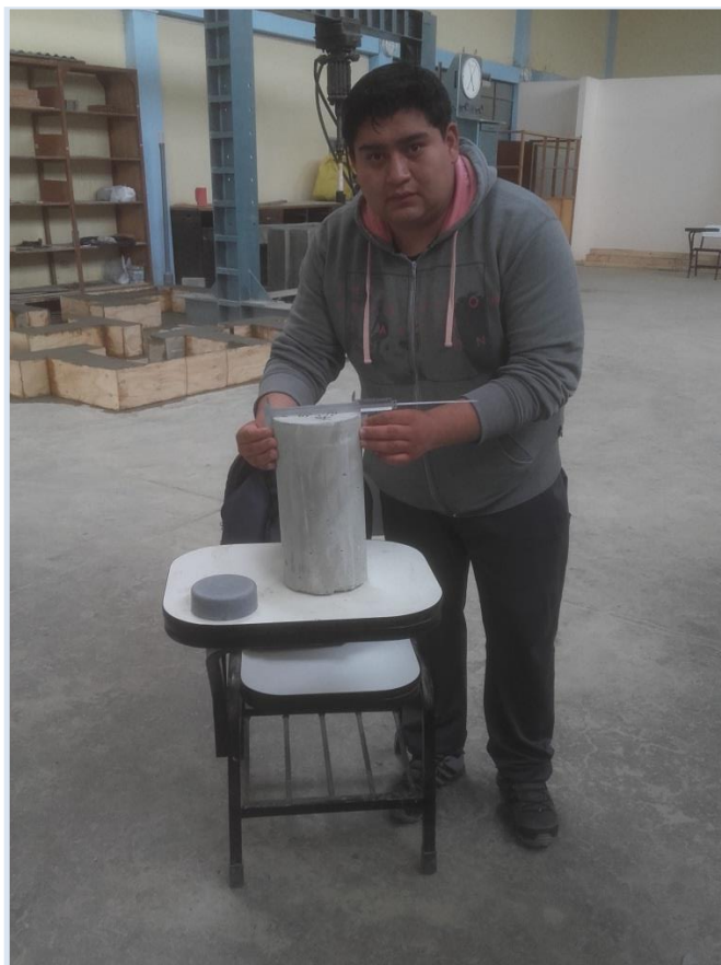
Figura 32. Registro del diámetro de los especímenes de concreto.
