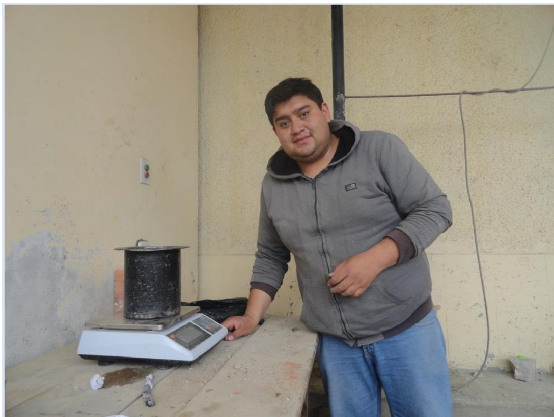
Figura 25. Peso unitario del agregado fino
