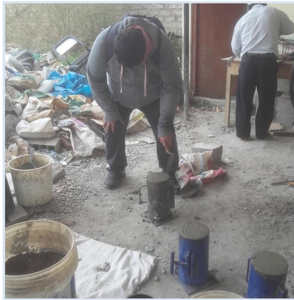
Figura 31. Llenado y compactación de probetas.
