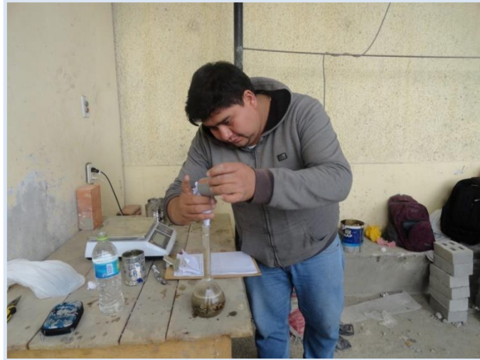
Figura 26. Ensayo de peso específico del agregado fino
