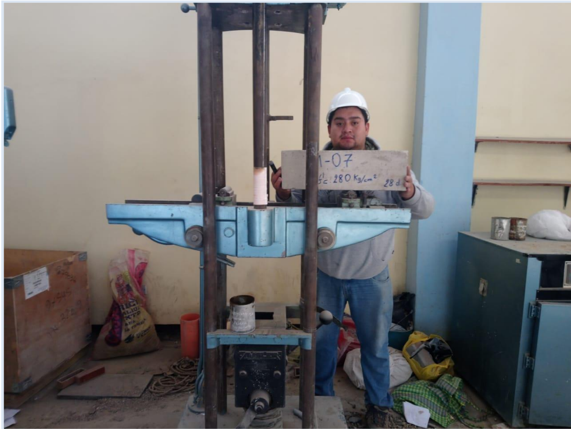
Figura 35. Especímenes prismáticos para ser ensayados a flexión.
