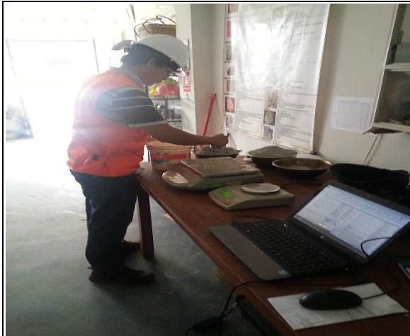
Foto N° 11 Pesado de los componentes de la mezcla y mezclado de la tanda 0.02m 3
