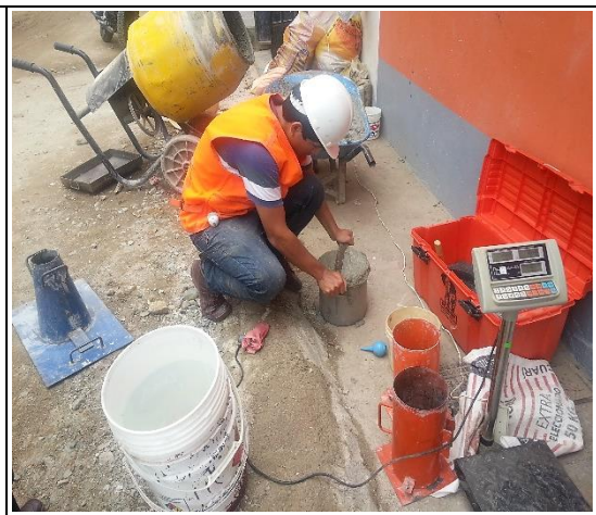
Foto N° 15 Lleno la olla Washington con mezcla de concreto fresco para determinar el contenido de aire.
