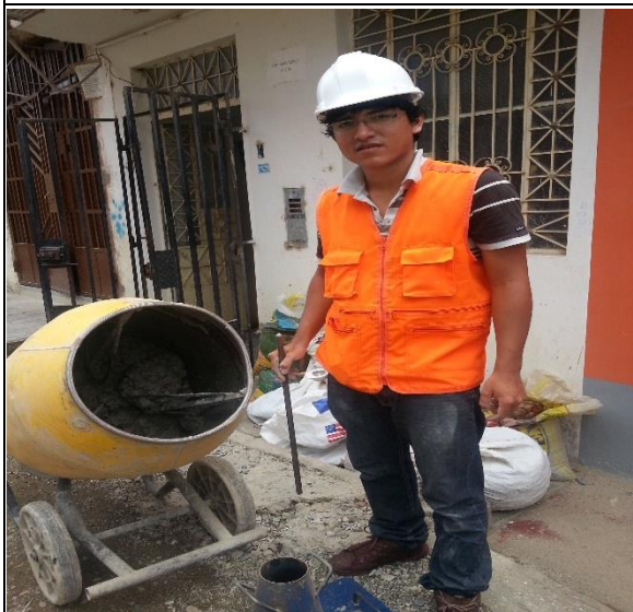
Foto N° 13 Mezcla homogénea de los materiales para la elaboración de los especímenes a ensayar.
