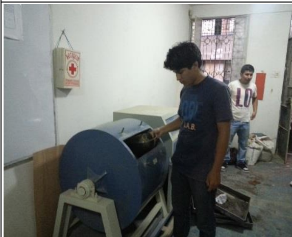
Foto N° 09 Ensayo de abrasión en la maquina los Angeles.
