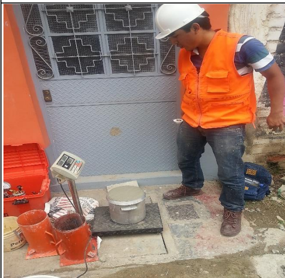
Foto N° 16 Se pesó la mezcla de concreto fresco para obtener el peso unitario.
