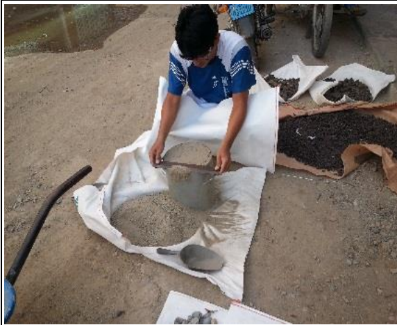
Foto N° 08 Ensayo de pesos unitarios seco de los agregados fino y grueso.
