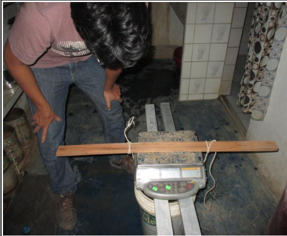
Foto N° 07 Ensayo para la obtención de los pesos específicos y la absorción del Agregado del agregado grueso.
