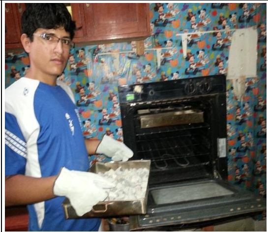
Foto N° 07 Ensayo para la obtención de los pesos específicos y la absorción del Agregado del agregado grueso.
