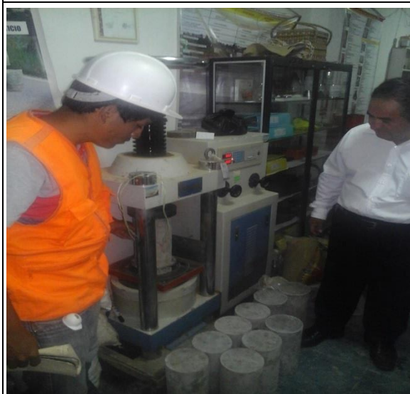
Foto N° 19 Rotura de probetas mediante el ensayo a compresión, estuvo como testigo el Ing. José Antonio Coronel Delgado y el Ing. Luis Rafael Quiroz Chihuan.
