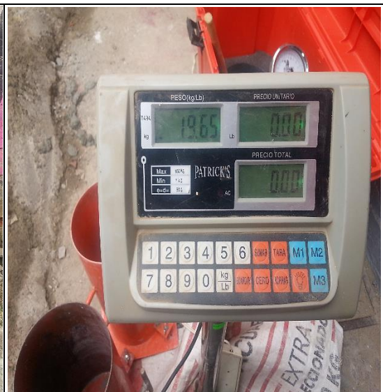
Foto N° 16 Se pesó la mezcla de concreto fresco para obtener el peso unitario.
