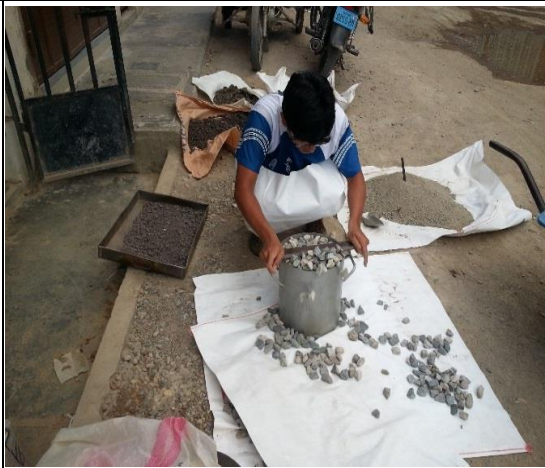
Foto N° 08 Ensayo de pesos unitarios seco de los agregados fino y grueso.
