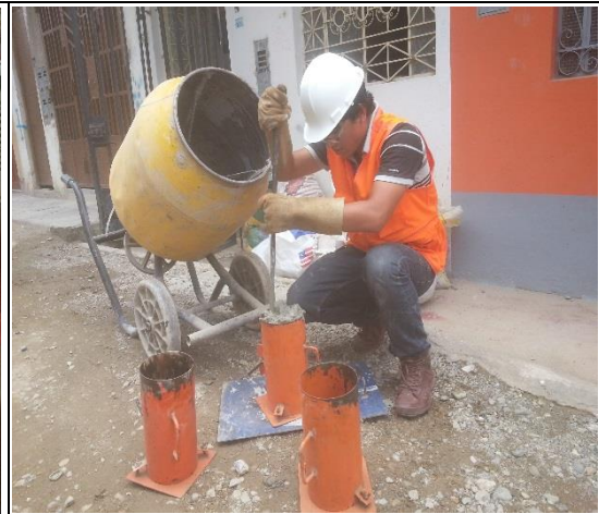
Foto N° 17 Elaboración de probetas de concreto sin adición y para 0.5% , 1.0% y 1.5 % de adición de fibra vegetal para ser ensayadas a los 7, 14 y 28 días
