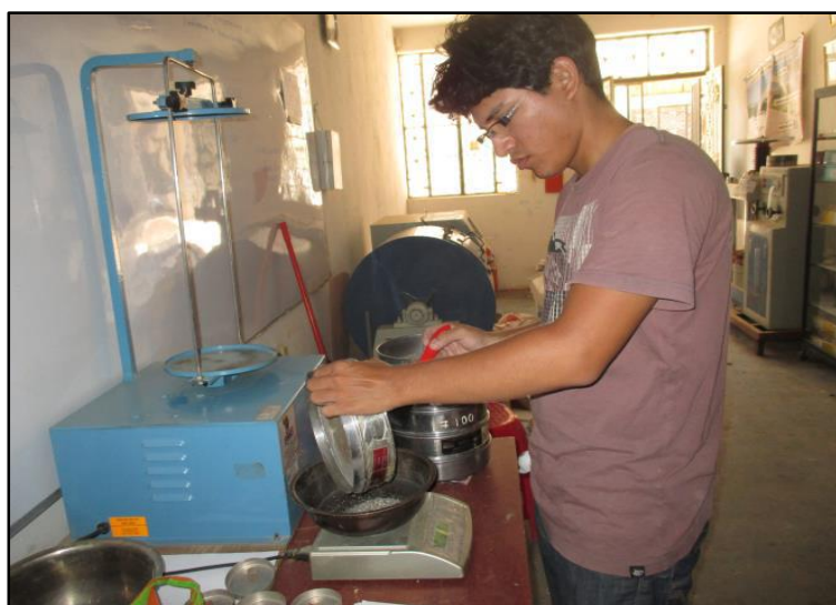
Figura N° 19 Pesando las muestras retenidas en cada tamiz
