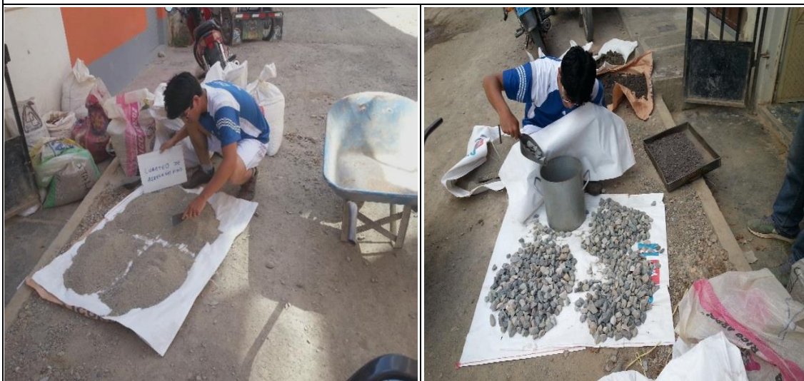
Foto N° 03 Cuarteo del agregado fino y grueso para la reducción a tamaño de muestra para los ensayos a realizar.
