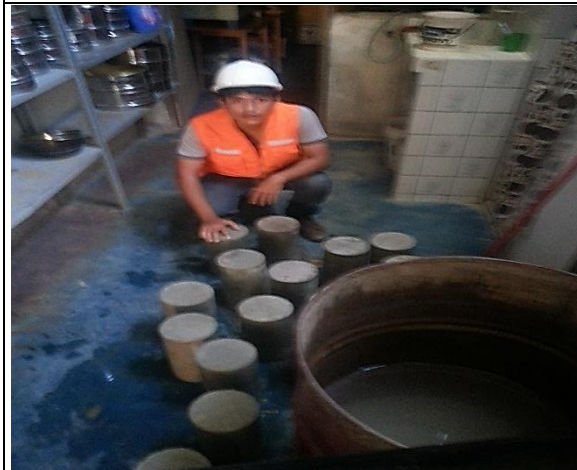
Foto N° 18 Curado de probetas en cilindros bajo sombra.
