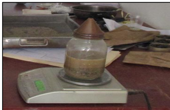
Figura N° 24 Peso del picnómetro + peso de la muestra + agua
