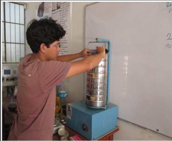
Foto N° 04 Tamizado y pesando de cada malla para obtener análisis granulométrico del agregado fino y grueso.
