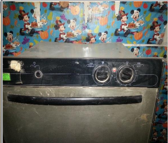
Foto N° 05 Secado en la estufa a 110^{\circ}\text{C} \pm 5^{\circ}\text{C} del agregado fino y grueso para los diferentes ensayos.
