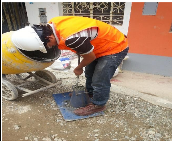
Foto N° 14 Determinación del Slump (asentamiento) mediante el cono de Abrams.
