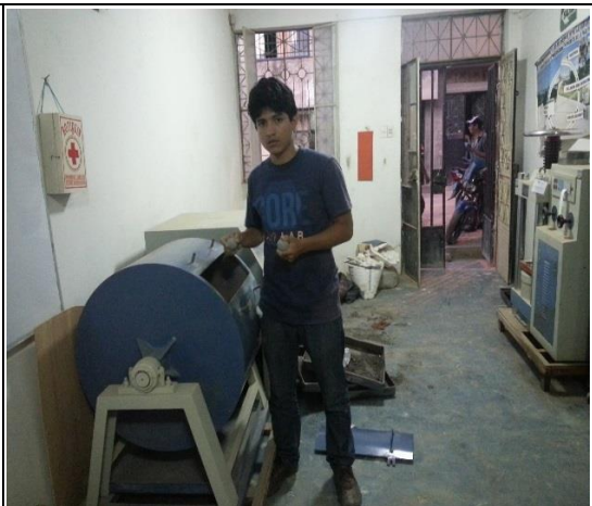
Foto N° 09 Ensayo de abrasión en la maquina los Angeles.
