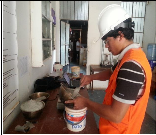
Foto N° 11 Pesado de los componentes de la mezcla y mezclado de la tanda 0.02m 3
