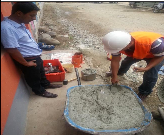
Foto N° 15 Lleno la olla Washington con mezcla de concreto fresco para determinar el contenido de aire.
