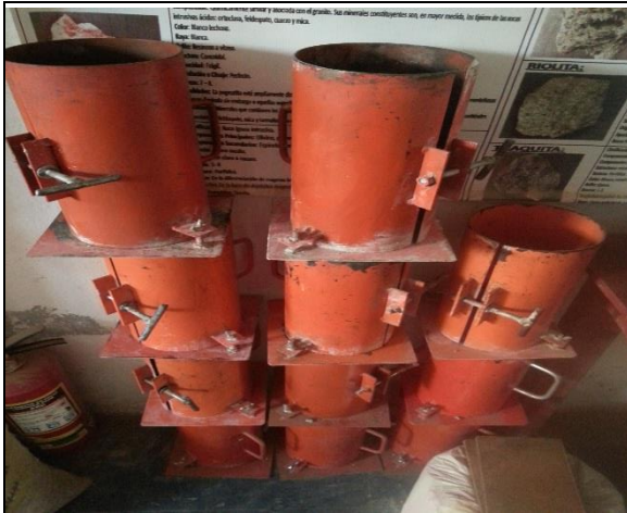
Foto N° 17 Elaboración de probetas de concreto sin adición y para 0.5% , 1.0% y 1.5 % de adición de fibra vegetal para ser ensayadas a los 7, 14 y 28 días
