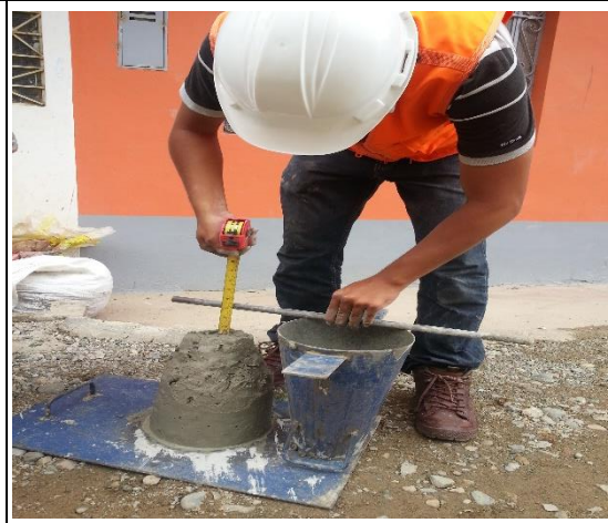
Foto N° 14 Determinación del Slump (asentamiento) mediante el cono de Abrams.
