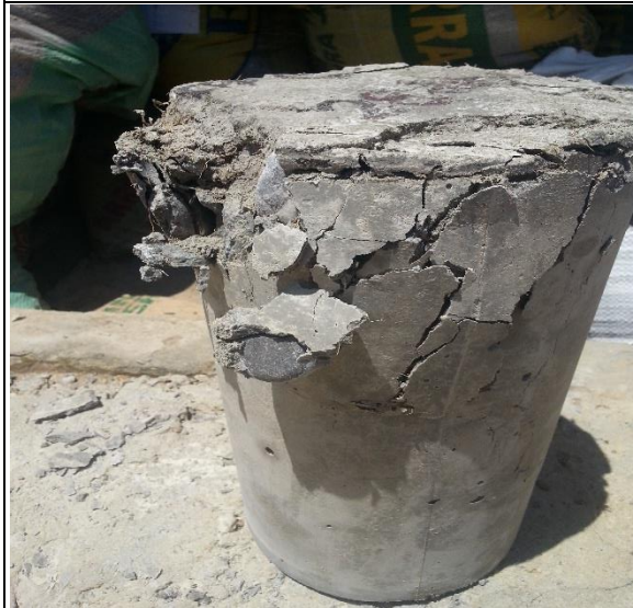
Foto N° 20 Rotura de probetas mediante el ensayo a compresión, estuvo como testigo el Ing. José Antonio Coronel Delgado.
