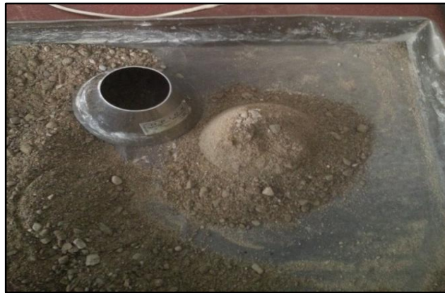
Figura N° 23 Agregado Fino superficialmente seca.
