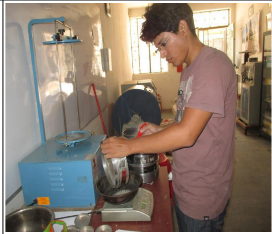
Foto N° 04 Tamizado y pesando de cada malla para obtener análisis granulométrico del agregado fino y grueso.
