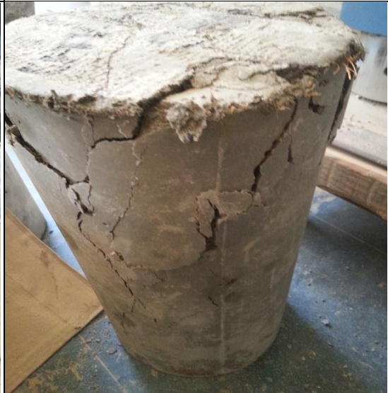
Foto N° 20 Rotura de probetas mediante el ensayo a compresión, estuvo como testigo el Ing. José Antonio Coronel Delgado.
