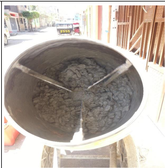
Foto N° 13 Mezcla homogénea de los materiales para la elaboración de los especímenes a ensayar.
