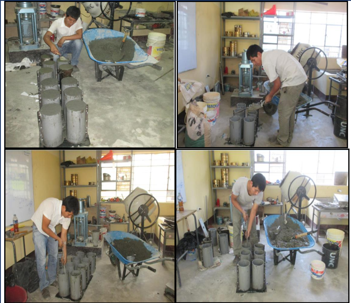
FOTO 29: Elaboración de los especímenes
