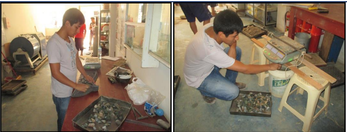
FOTO 6: Agregado superficialmente seca, Peso de muestra sumergida
