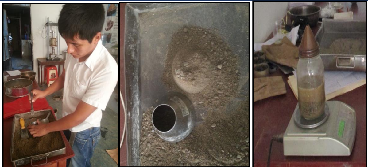
FOTO 5: Ensayo para la obtención de los pesos específicos y la absorción del Agregado fino.
