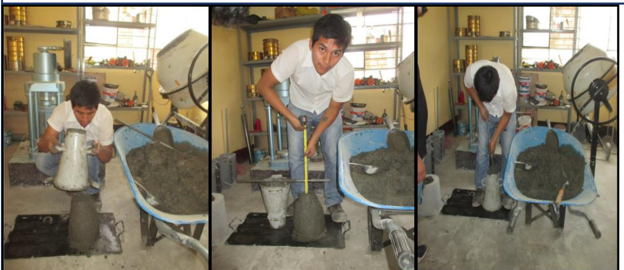
FOTO 27: Determinación de Slump con diferentes adiciones
