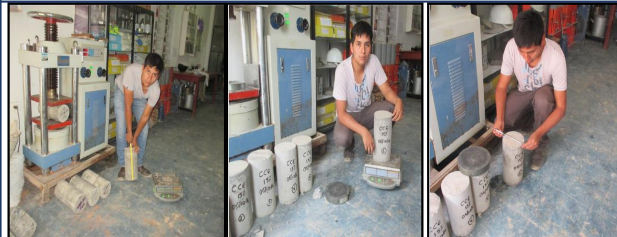
FOTO 33: Toma de medidas y peso de los especímenes de concreto para su posterior ensayo.
