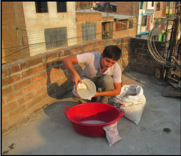
FOTO 17: Tratamiento a la fibra para luego ser usado como adición
