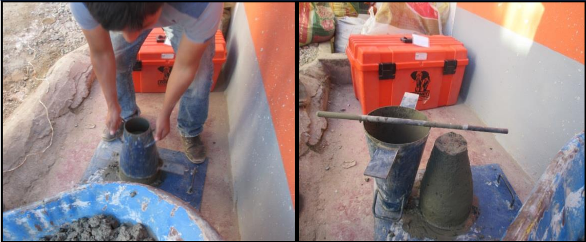
FOTO 20: Determinación del Slump (asentamiento) mediante el cono de Abrams
