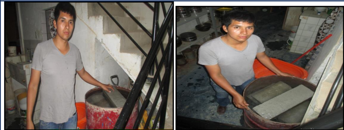
FOTO 31: Curado de probetas
