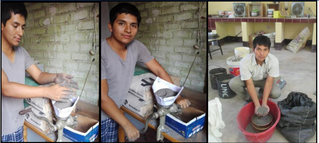
FOTO 12: molienda de la ceniza para obtener una finura similar al cemento.
