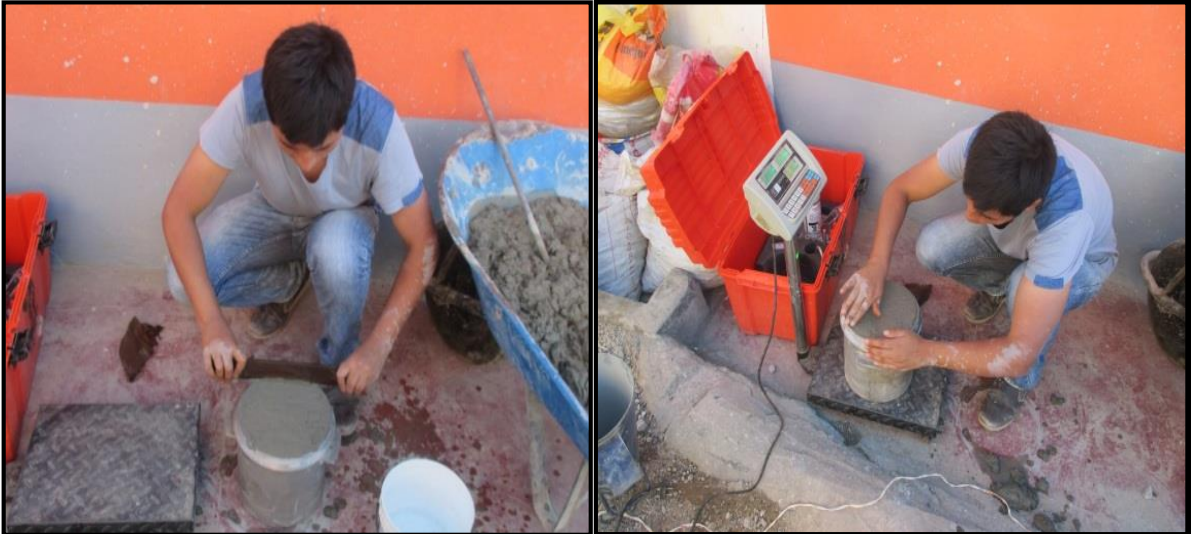
FOTO 21: Medición del peso unitario
