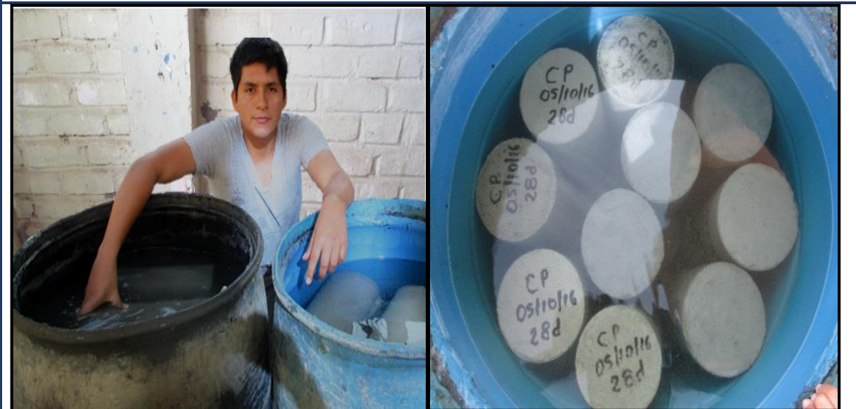
FOTO 30: Curado de probetas
