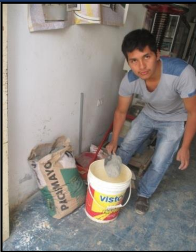
FOTO 18: Pesado de los componentes de la mezcla y mezclado de la tanda
