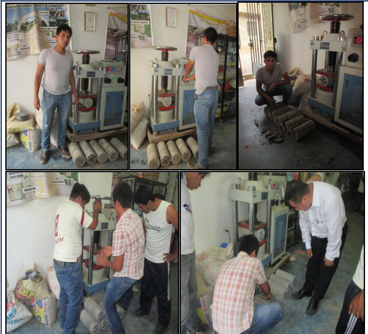
FOTO 34: Ensayo a tracción indirecta de los especímenes de concreto cilíndricos
