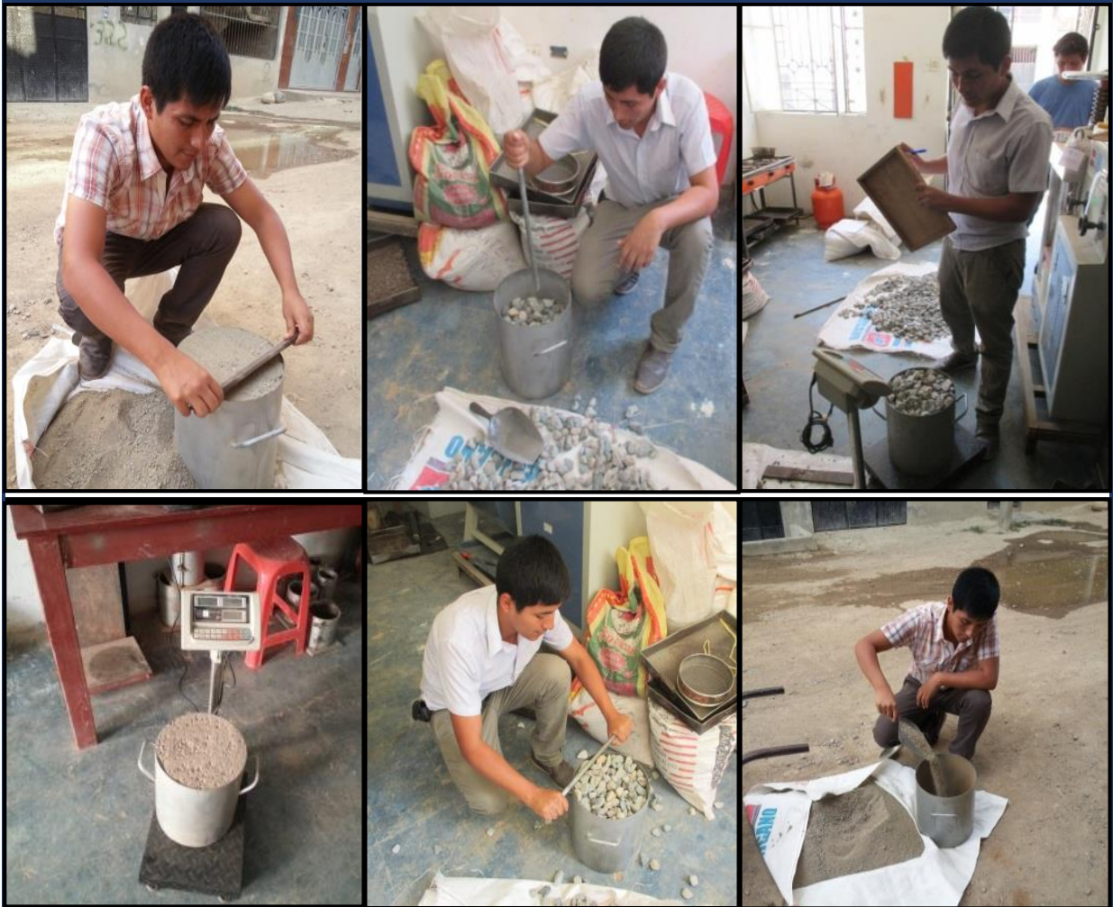
FOTO 7: Ensayo de pesos unitarios seco de los agregados fino y grueso
