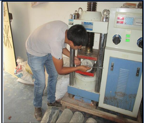
FOTO 36: Medida de ancho de fisura de los especímenes ensayados a tracción indirecta.
