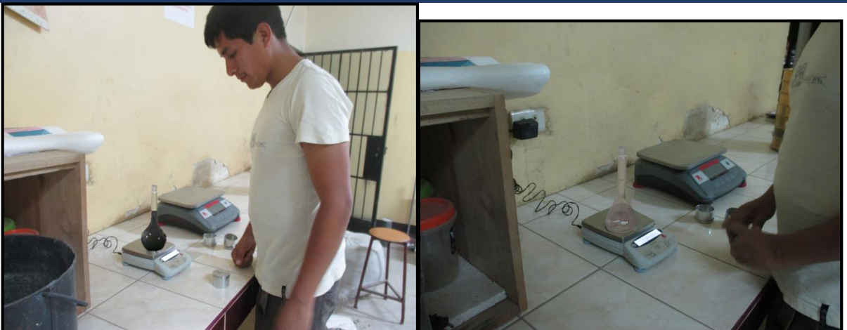
FOTO 13: Determinación del peso específico de la ceniza
