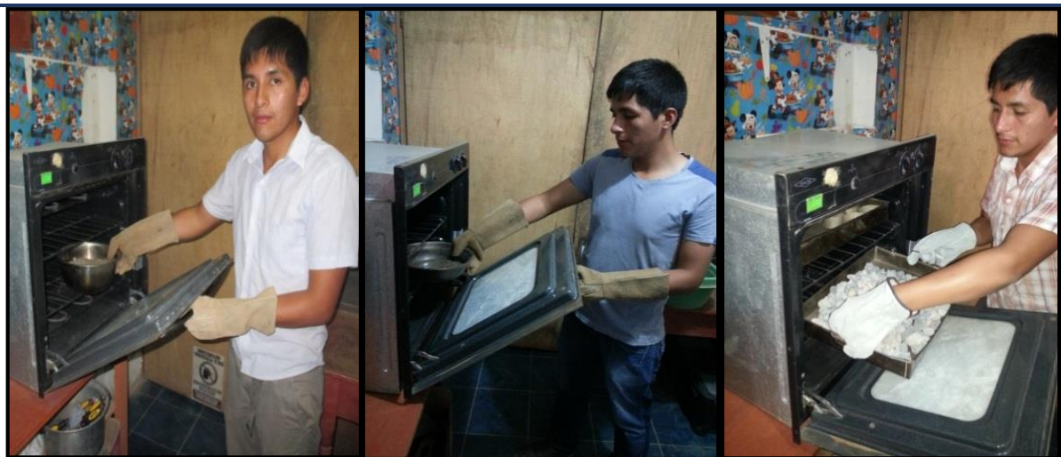
FOTO 3: Secado en la estufa a 110°C del agregado fino y grueso para los diferentes ensayos
