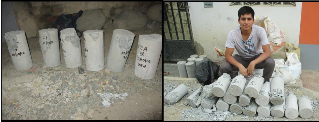
Figura 21: Tipos de fallas típicas en los especímenes de concretos ensayados a compresión.
