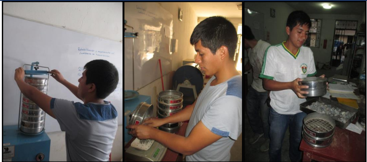
FOTO 4: Tamizado y pesando de cada malla para obtener análisis granulométrico del agregado fino y grueso
