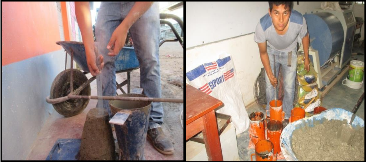
FOTO 23: Elaboración de probetas de prueba.
