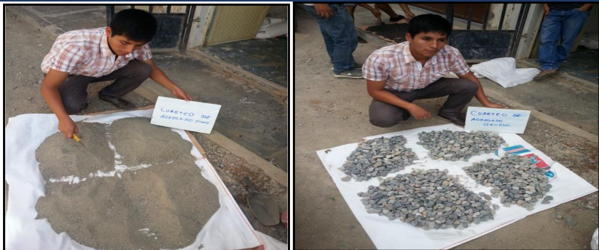
FOTO 2: Cuarteo del agregado fino y grueso para la reducción a tamaño de muestra para los ensayos a realizar.
