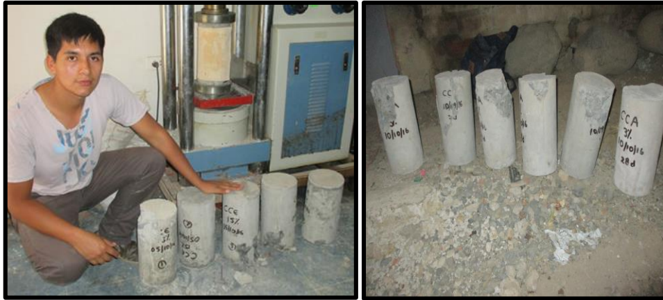
Figura 19: Identificación, ensayo a compresión y registro del tipo de falla de los especímenes.
