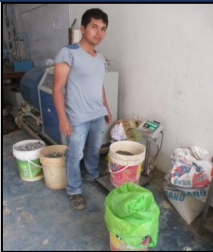
FOTO 18: Pesado de los componentes de la mezcla y mezclado de la tanda
