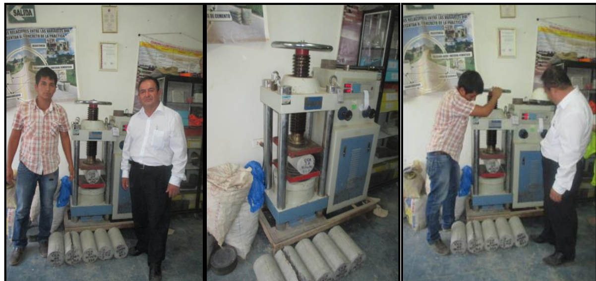
FOTO 35: Ensayo a tracción indirecta de los especímenes de concreto cilíndricos
