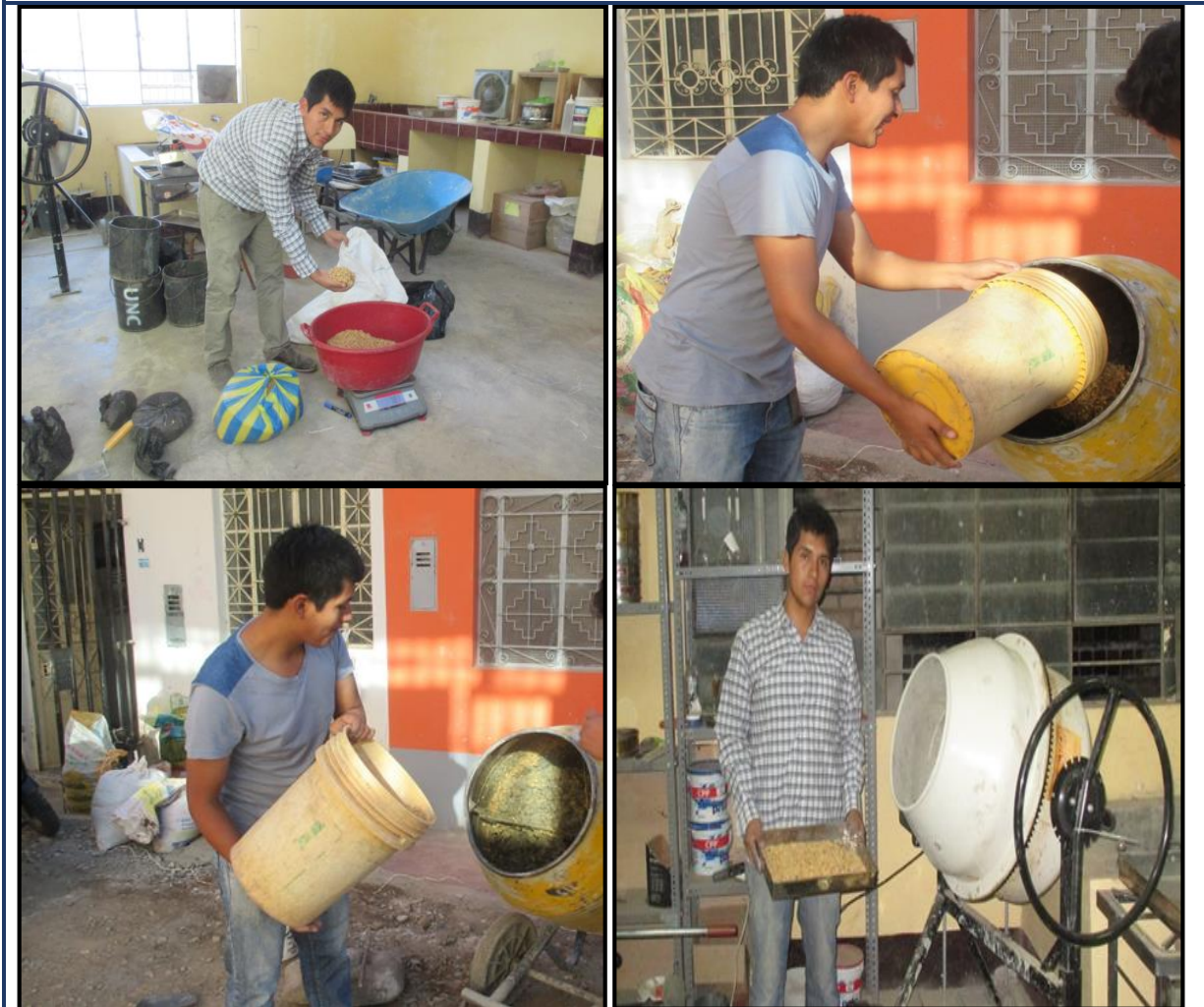
FOTO 25: Preparación de mezcla con adiciones de cascarilla de café en diferentes proporciones
