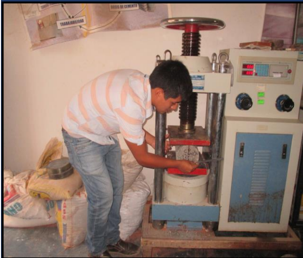
FOTO 36: Medida de ancho de fisura de los especímenes ensayados a tracción indirecta.
