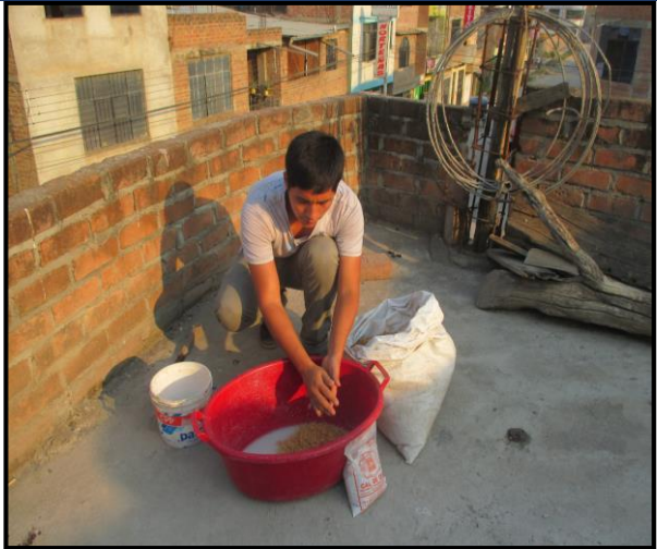
FOTO 17: Tratamiento a la fibra para luego ser usado como adición
