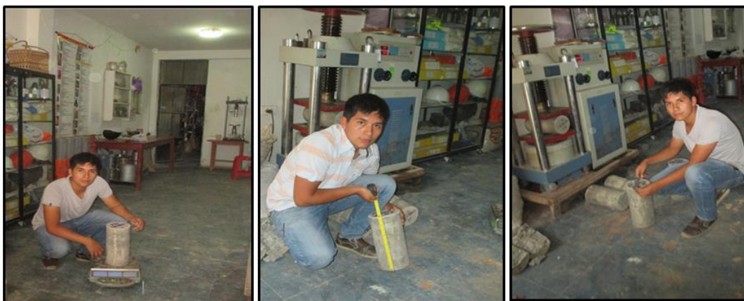
Figura 18: Toma de las Medidas de las Probetas Cilíndricas.
