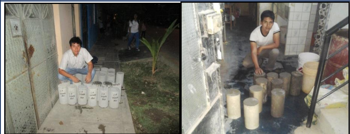
FOTO 32: Extracción de los especímenes de concreto para realizar los ensayos respectivos
