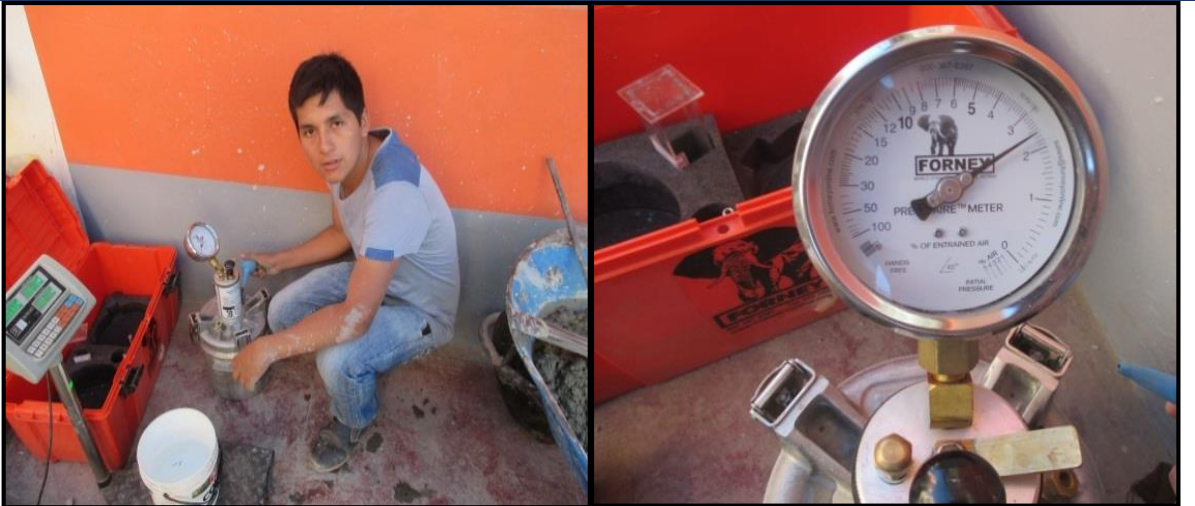
FOTO 22: Medición de Aire mediante Olla de Washington para corrección
