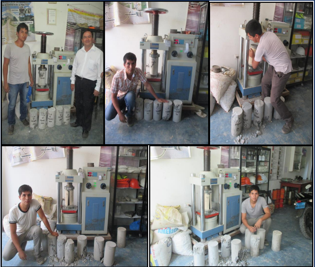
FOTO 38: Ensayo a compresión de los especímenes de concreto cilíndricos con diferentes adiciones
