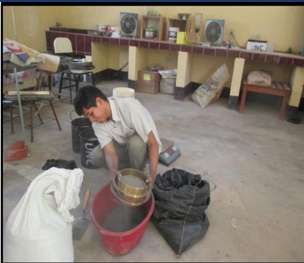
FOTO 15: tamizado de las adiciones.
