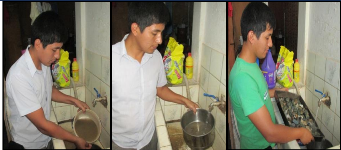
FOTO 8: Ensayo de lavado del agregado para determinar las partículas que pasan el tamiz N° 200.
