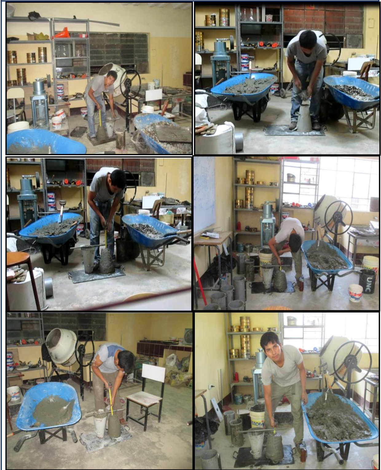
FOTO 28: Determinación de Slump con diferentes adiciones
