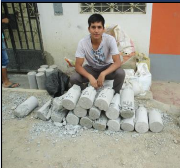
FOTO 37: Ensayo a compresión de los especímenes de concreto cilíndricos con diferentes adiciones
