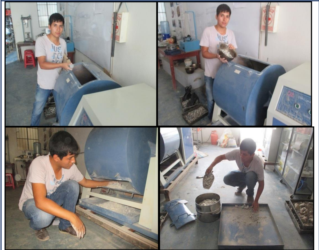
FOTO 9: Ensayo de abrasión en la maquina los Ángeles
