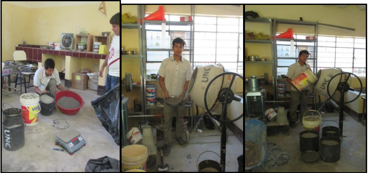
FOTO 25: Preparación de mezcla con ceniza en diferentes proporciones
