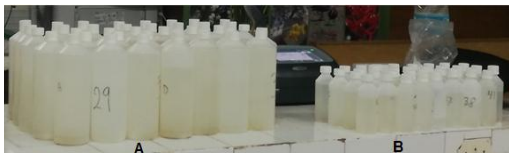
Figura 16. Recipientes de plástico que contienen muestras de agua de todos los puntos de muestreo. A. Muestras usadas para análisis de nutrientes, B. Muestras usadas para análisis de DBO.
