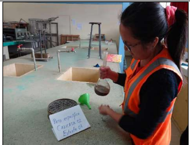
Fotografía N° 34: Realización del ensayo de "Peso Específico" – Calicata N° 02.
