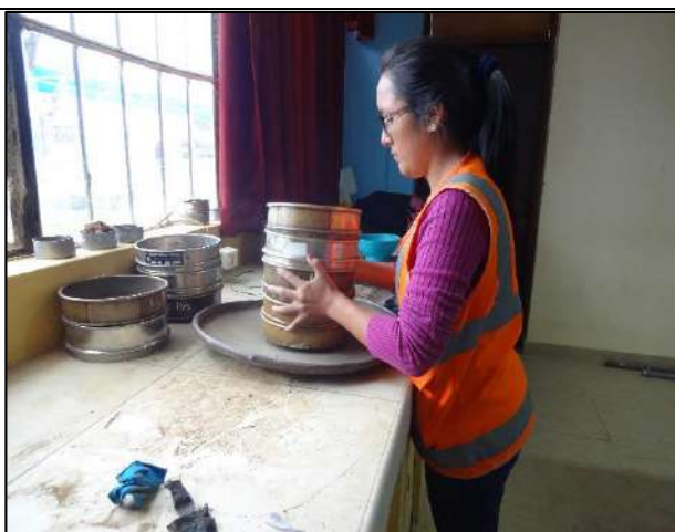
Fotografía N° 29: Realización del ensayo de “Granulometría” – Calicata N° 01.
