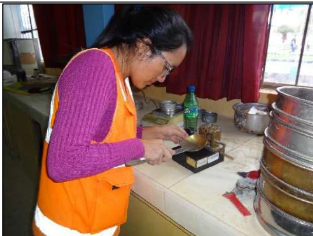
Fotografía N° 35: Realización del ensayo de "Límite Líquido" – Calicata N° 01.
