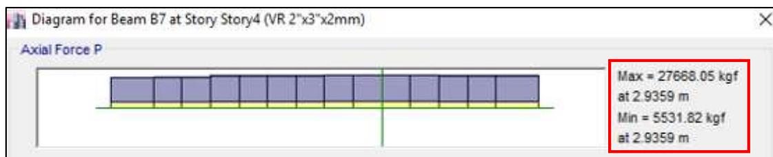
Figura N° 62: Diagrama Carga Axial en Brida Inferior – Tijeral lateral Bloque I.
