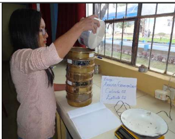
Fotografía N° 30: Realización del ensayo de “Granulometría” – Calicata N° 02.
