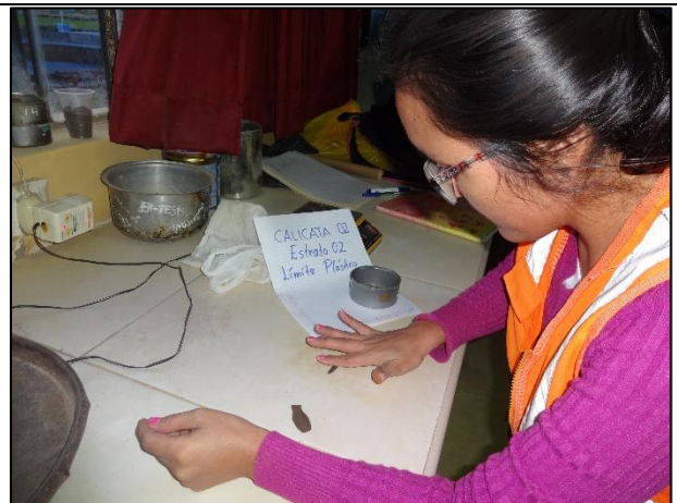
Fotografía N° 36: Realización del ensayo de “Límite Plástico” – Calicata N° 02.
