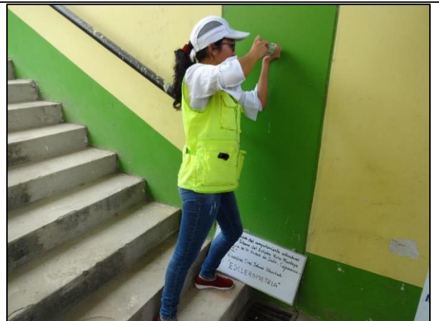
Fotografía N° 16: Realización del ensayo con “Esclerómetro” – Columnas.
