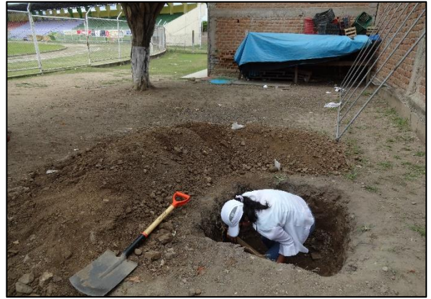
Fotografía N° 20: Excavación de la calicata N° 02 – Margen derecha de la Tribuna Oriente.
