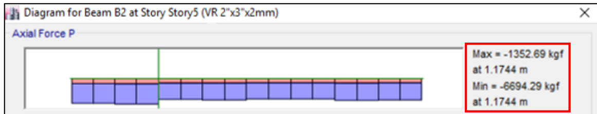
Figura N° 61: Diagrama Carga Axial en Brida Superior – Tijeral lateral Bloque I. Fuente: Extraído del ETABS v16.
