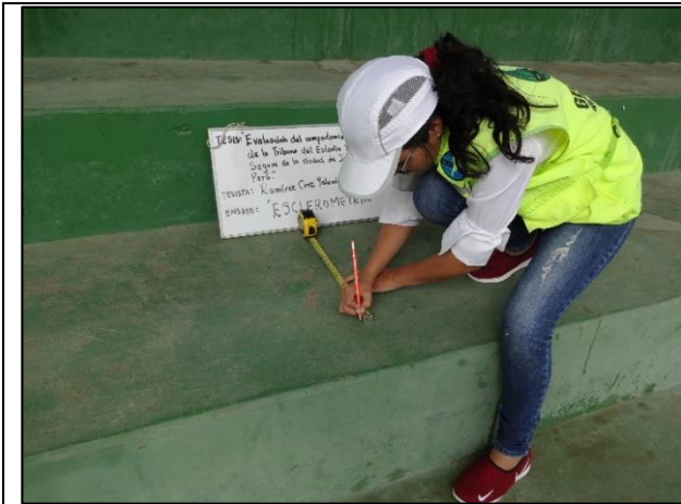
Fotografía N° 13: Toma de medidas para la realización del ensayo con “Esclerómetro” – Graderías de las tribunas.
