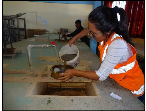
Fotografía N° 28: Lavado de muestra para el ensayo de “Granulometría” – Calicata N° 02.
